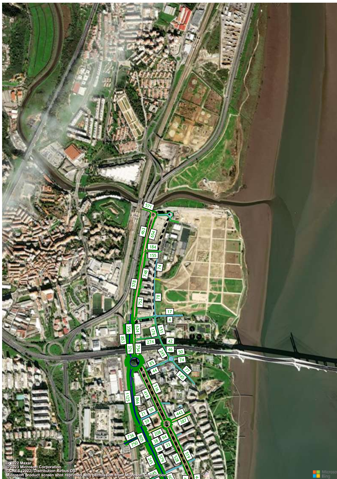
Figura 168 – Volumes de tráfego (macro modelo de tráfego em PTV Visum, HPT-DU, Cenário F3, Troço 11 a 12) (uvle/hora).
