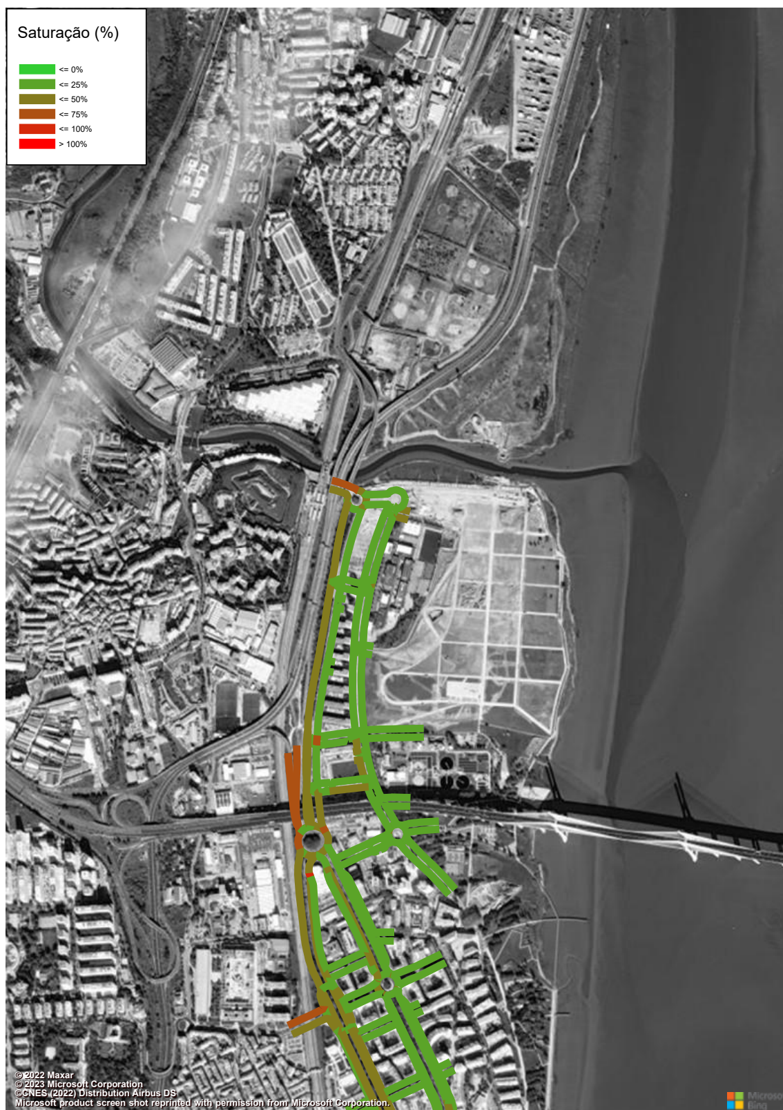
Figura 115 – Grau de Saturação (macro modelo de tráfego em PTV Visum, HPT-DU, Cenário F0, Troço 11 a 12) (%).
