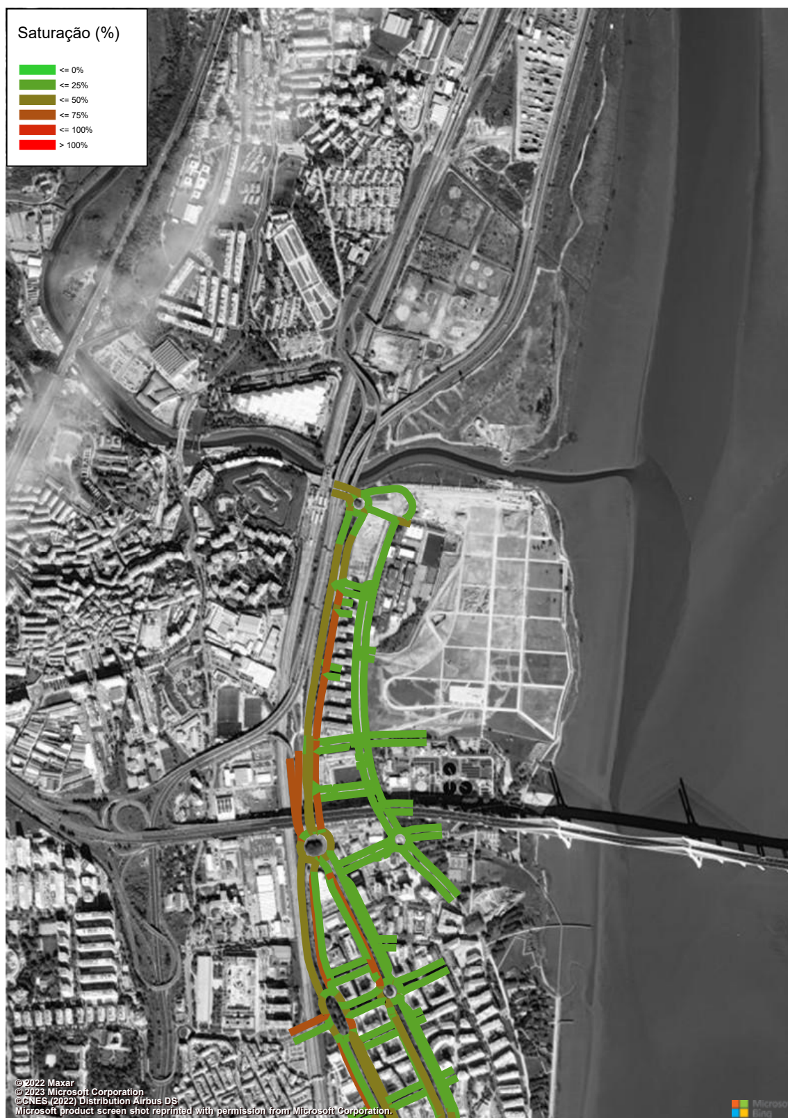
Figura 241 – Grau de Saturação (macro modelo de tráfego em PTV Visum, HPT-DU, Cenário RM2, Troço 11 a 12) (%).
