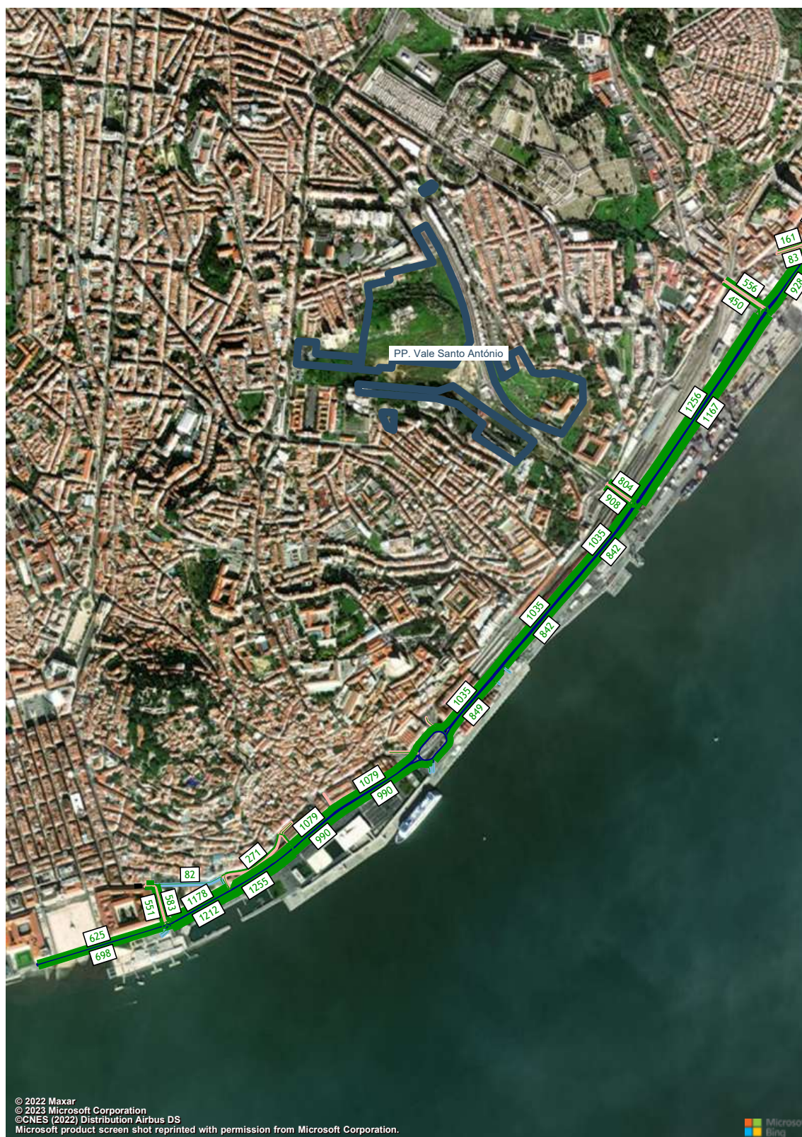
Figura 120 – Volumes de tráfego (macro modelo de tráfego em PTV Visum, HPT-DU, Cenário F1, Troço 1 a 4) (uvle/hora).
