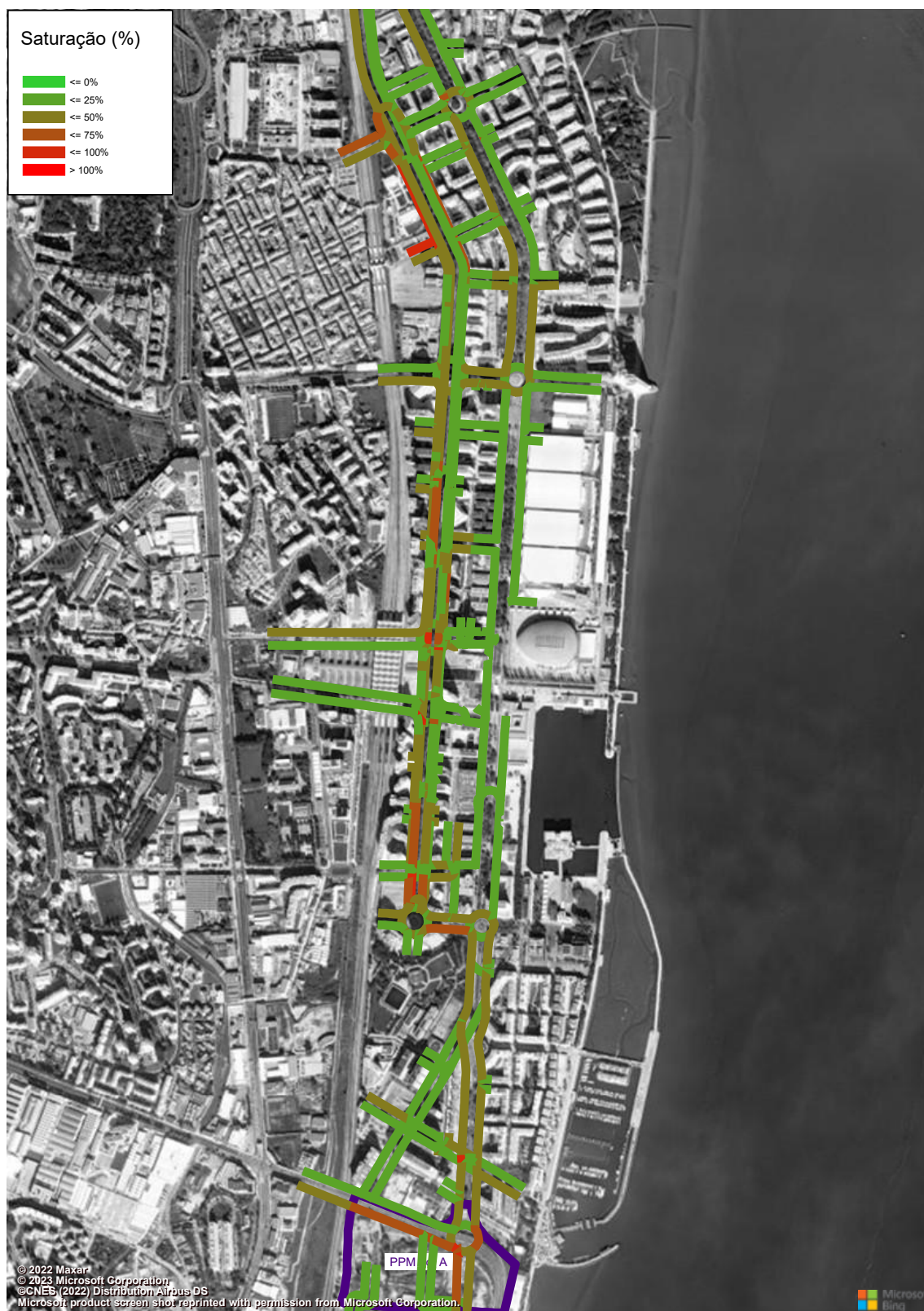
Figura 133 – Grau de Saturação (macro modelo de tráfego em PTV Visum, HPM-DU, Cenário F1, Troço 7 a 10) (%).
