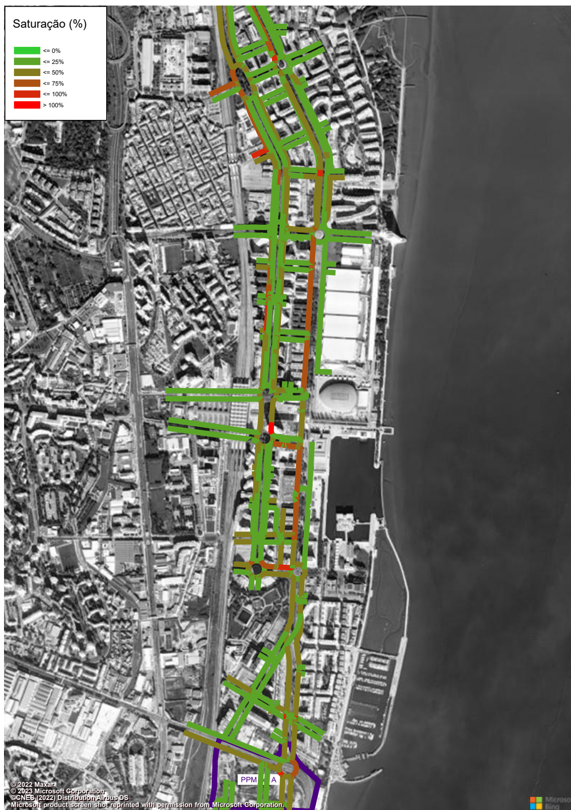
Figura 238 – Grau de Saturação (macro modelo de tráfego em PTV Visum, HPM-DU, Cenário RM2, Troço 7 a 10) (%).
