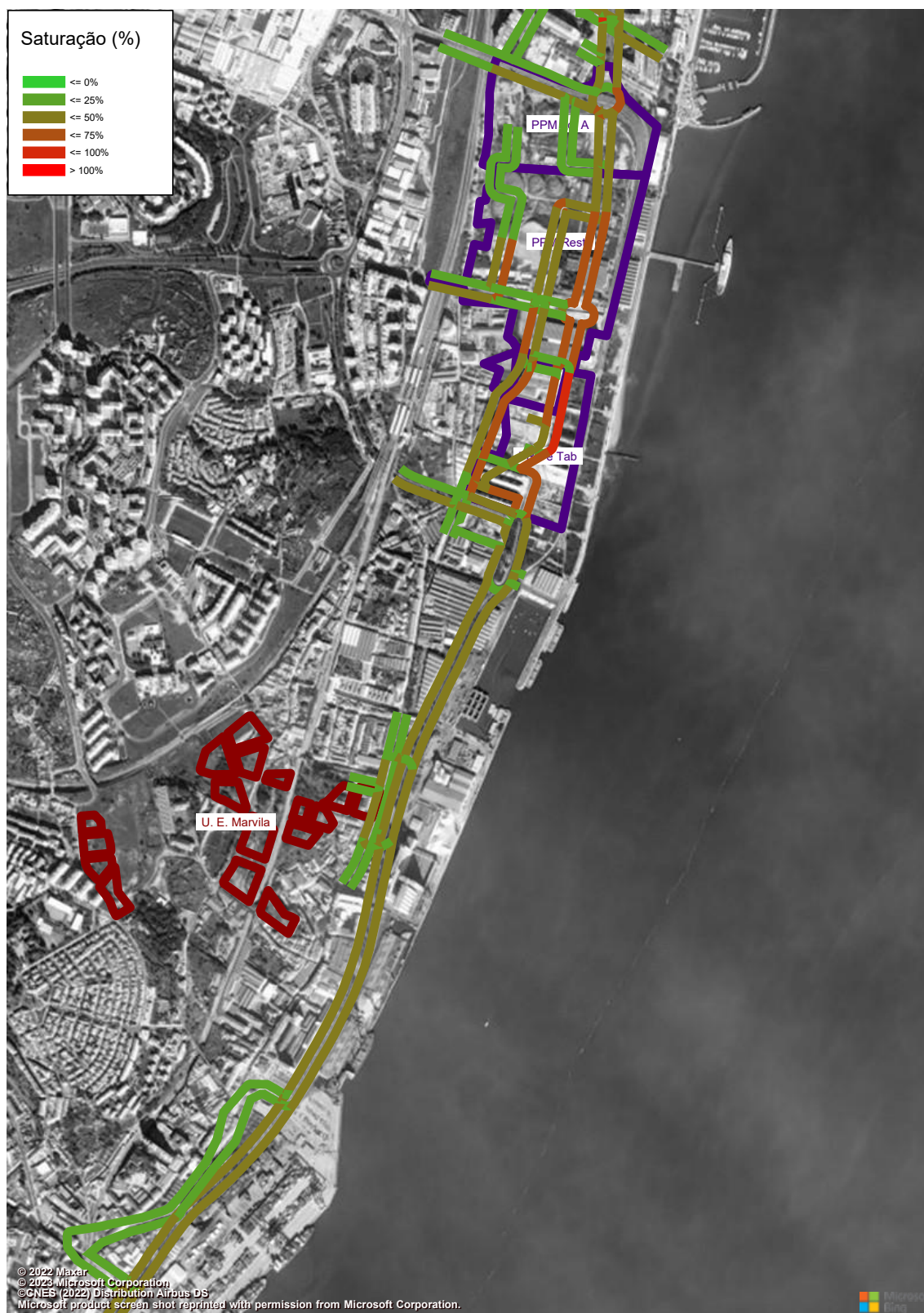
Figura 258 – Grau de Saturação (macro modelo de tráfego em PTV Visum, HPT-DU, Cenário RM3, Troço 5 a 6) (%).
