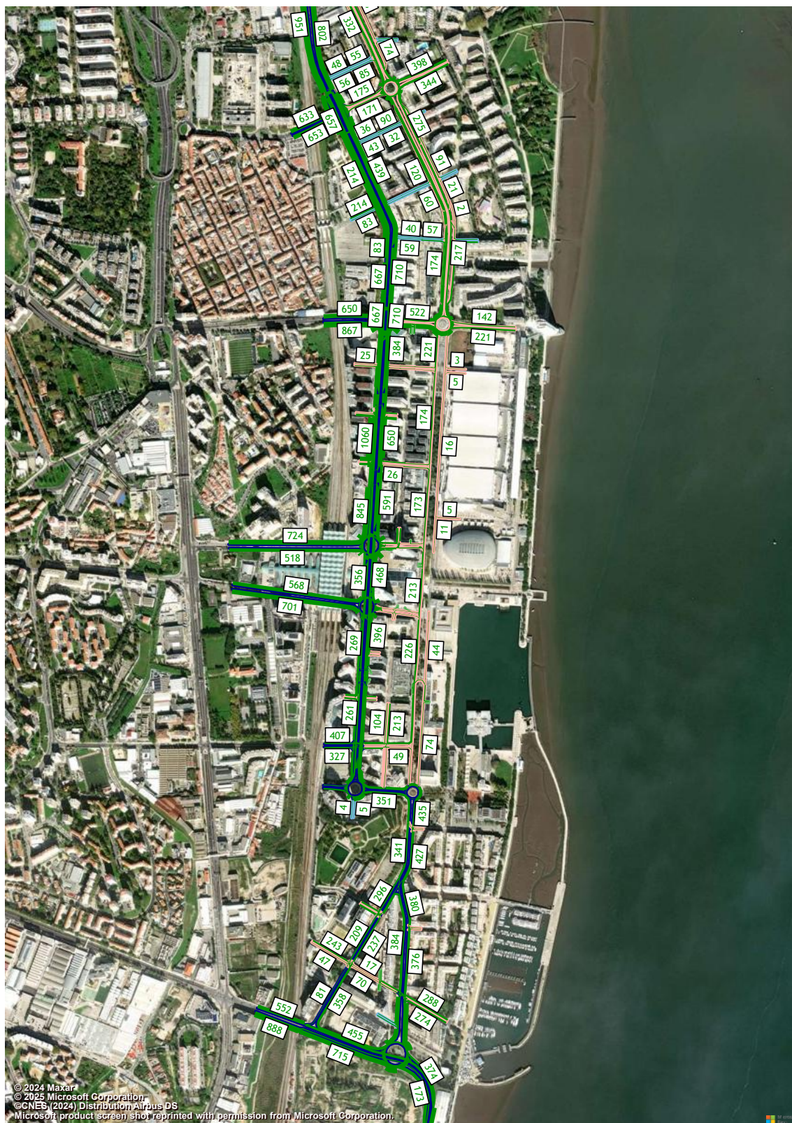
Figura 82 – Volumes de tráfego (macro modelo de tráfego em PTV Visum, HPT-DU, Cenário A0, Troço 7 a 10) (uvle/hora).
