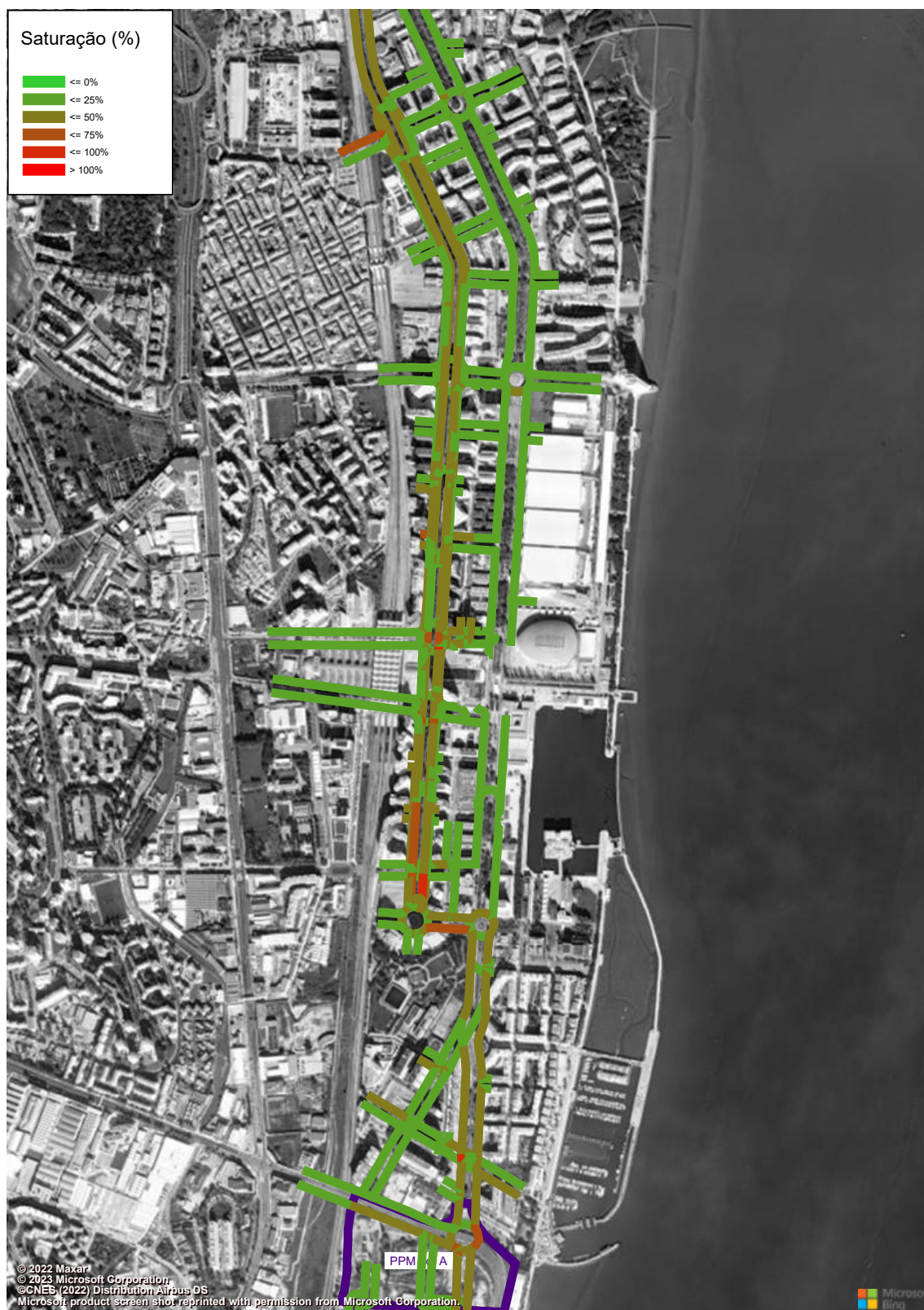
Figura 218 – Grau de Saturação (macro modelo de tráfego em PTV Visum, HPT-DU, Cenário RM1, Troço 7 a 10) (%).
