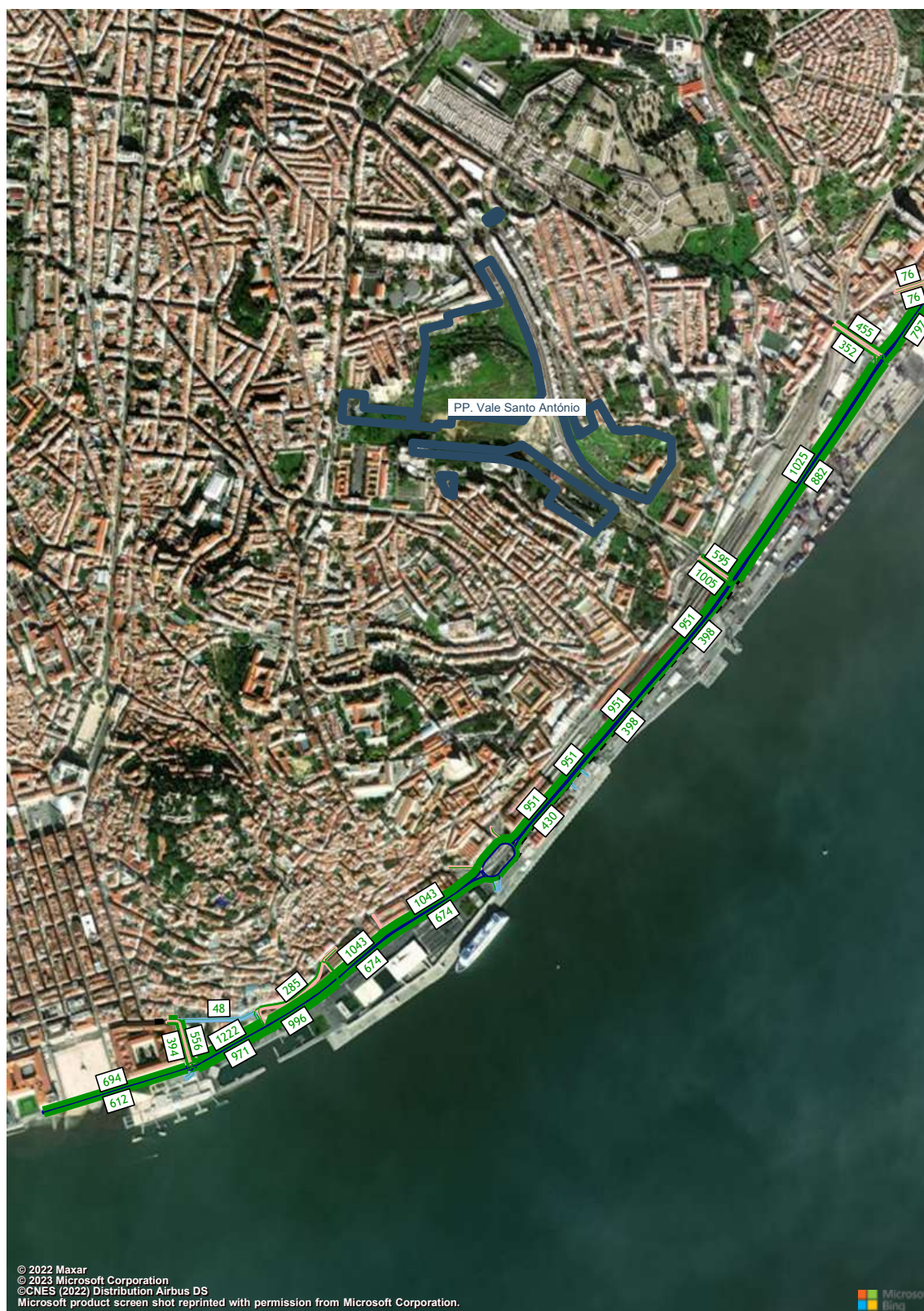
Figura 119 – Volumes de tráfego (macro modelo de tráfego em PTV Visum, HPM-DU, Cenário F1, Troço 1 a 4) (uvle/hora).
