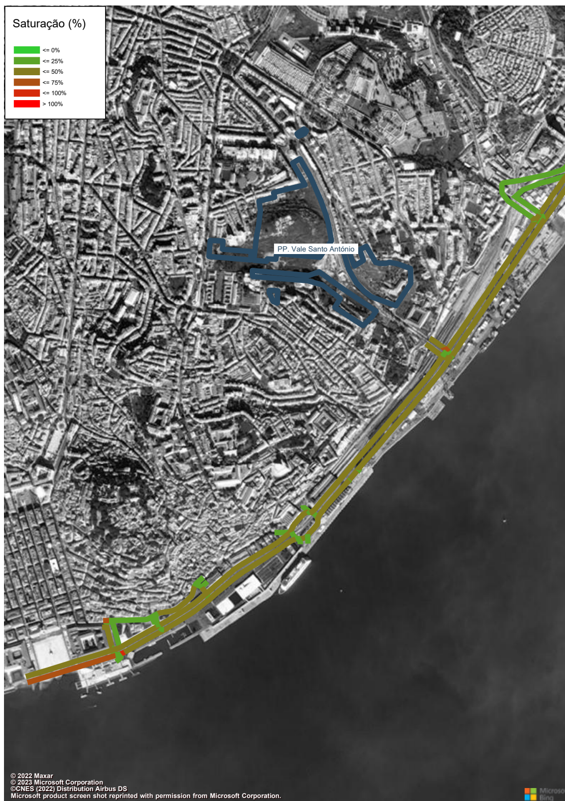
Figura 256 – Grau de Saturação (macro modelo de tráfego em PTV Visum, HPT-DU, Cenário RM3, Troço 1 a 4) (%).
