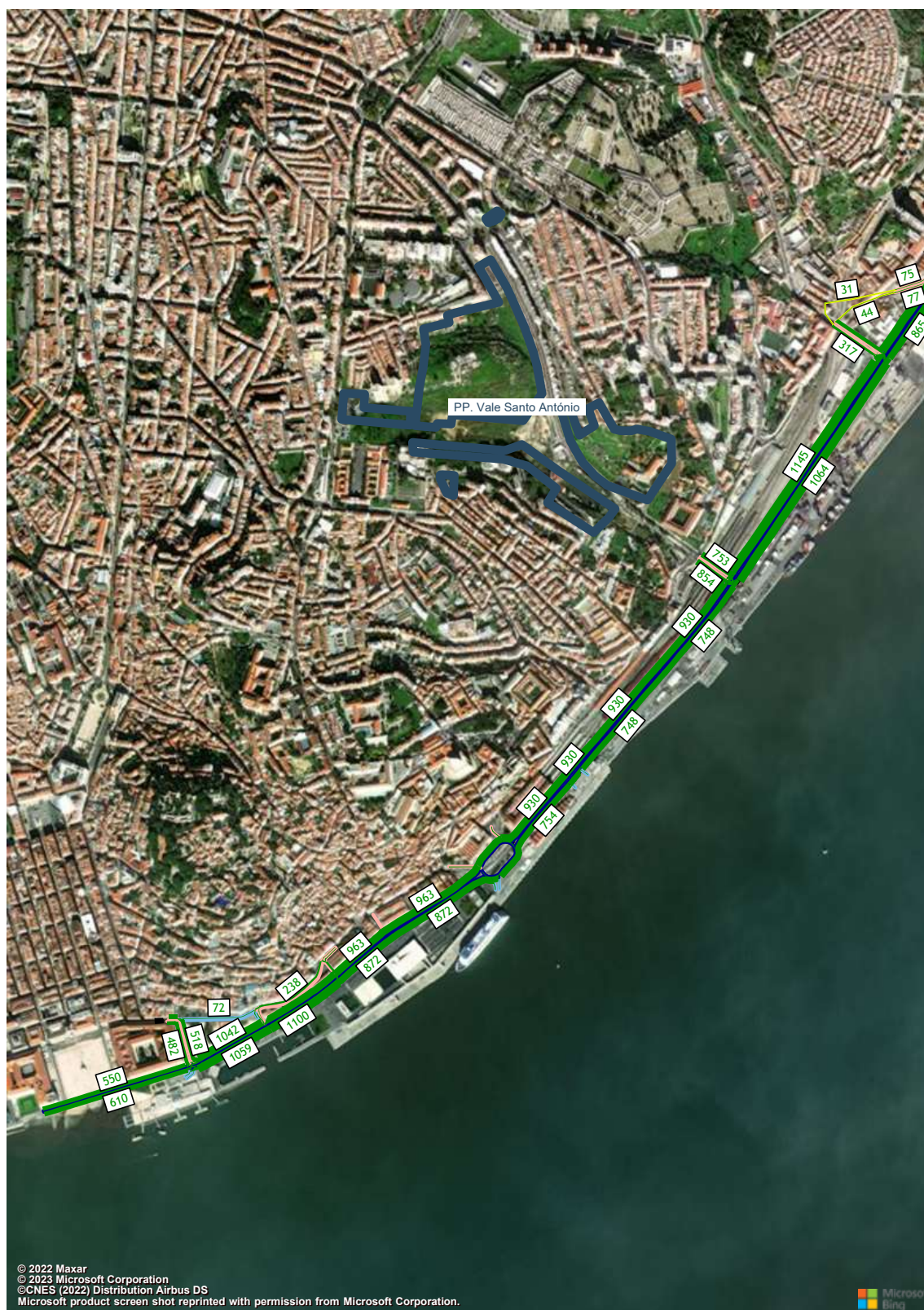
Figura 246 – Volumes de tráfego (macro modelo de tráfego em PTV Visum, HPT-DU, Cenário RM3, Troço 1 a 4) (uvle/hora).
