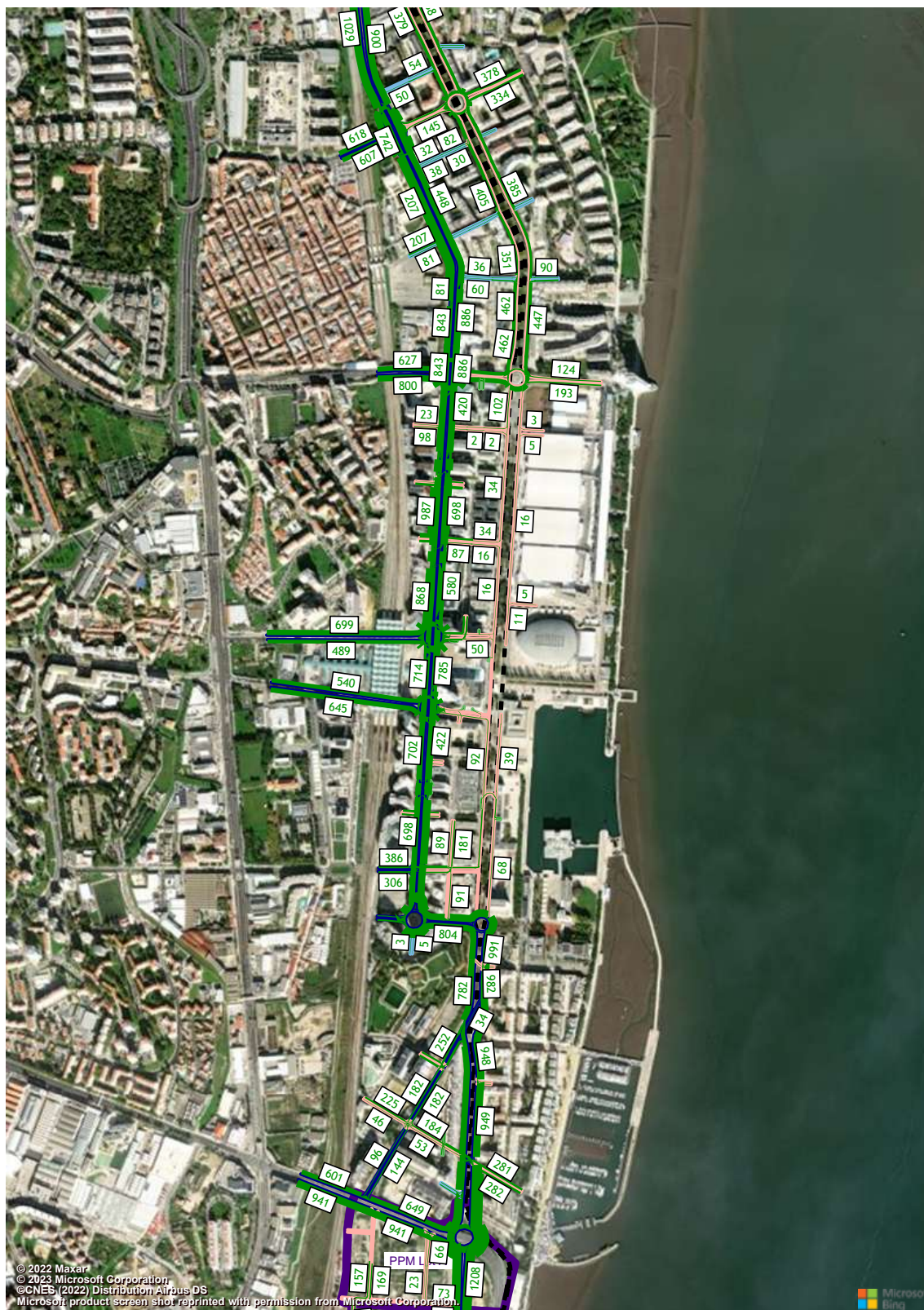
Figura 208 – Volumes de tráfego (macro modelo de tráfego em PTV Visum, HPT-DU, Cenário RM1, Troço 7 a 10) (uvle/hora).
