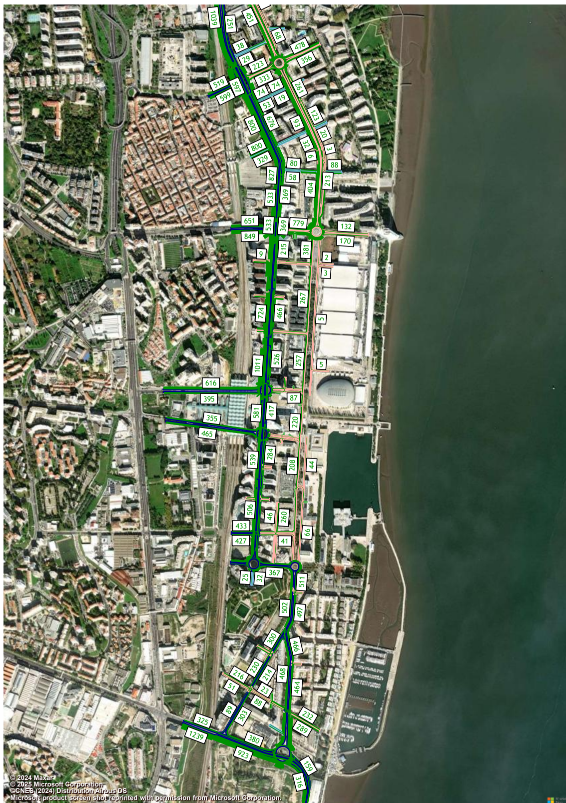
Figura 81 – Volumes de tráfego (macro modelo de tráfego em PTV Visum, HPM-DU, Cenário A0, Troço 7 a 10) (uvle/hora).
