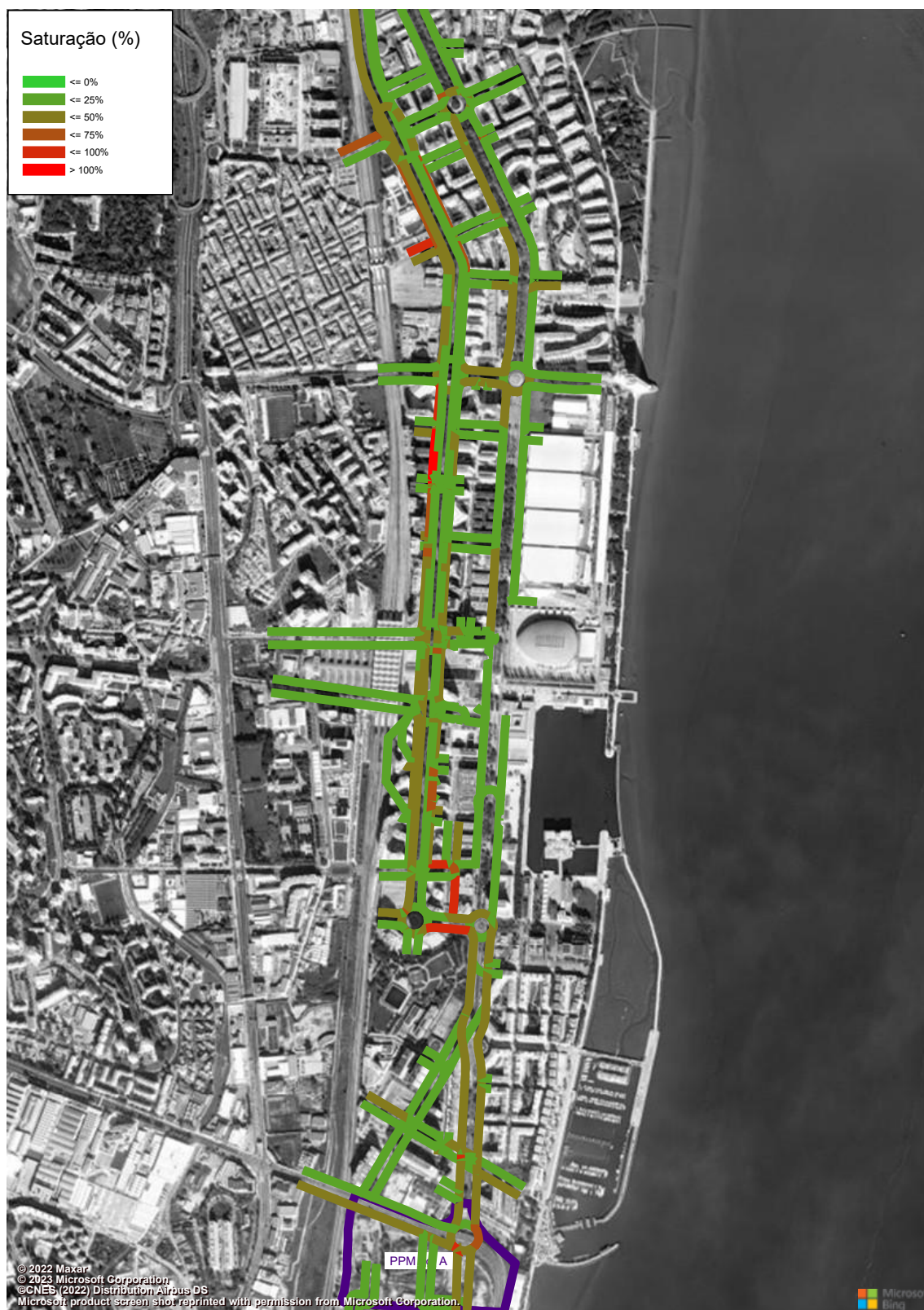
Figura 259 – Grau de Saturação (macro modelo de tráfego em PTV Visum, HPM-DU, Cenário RM3, Troço 7 a 10) (%).
