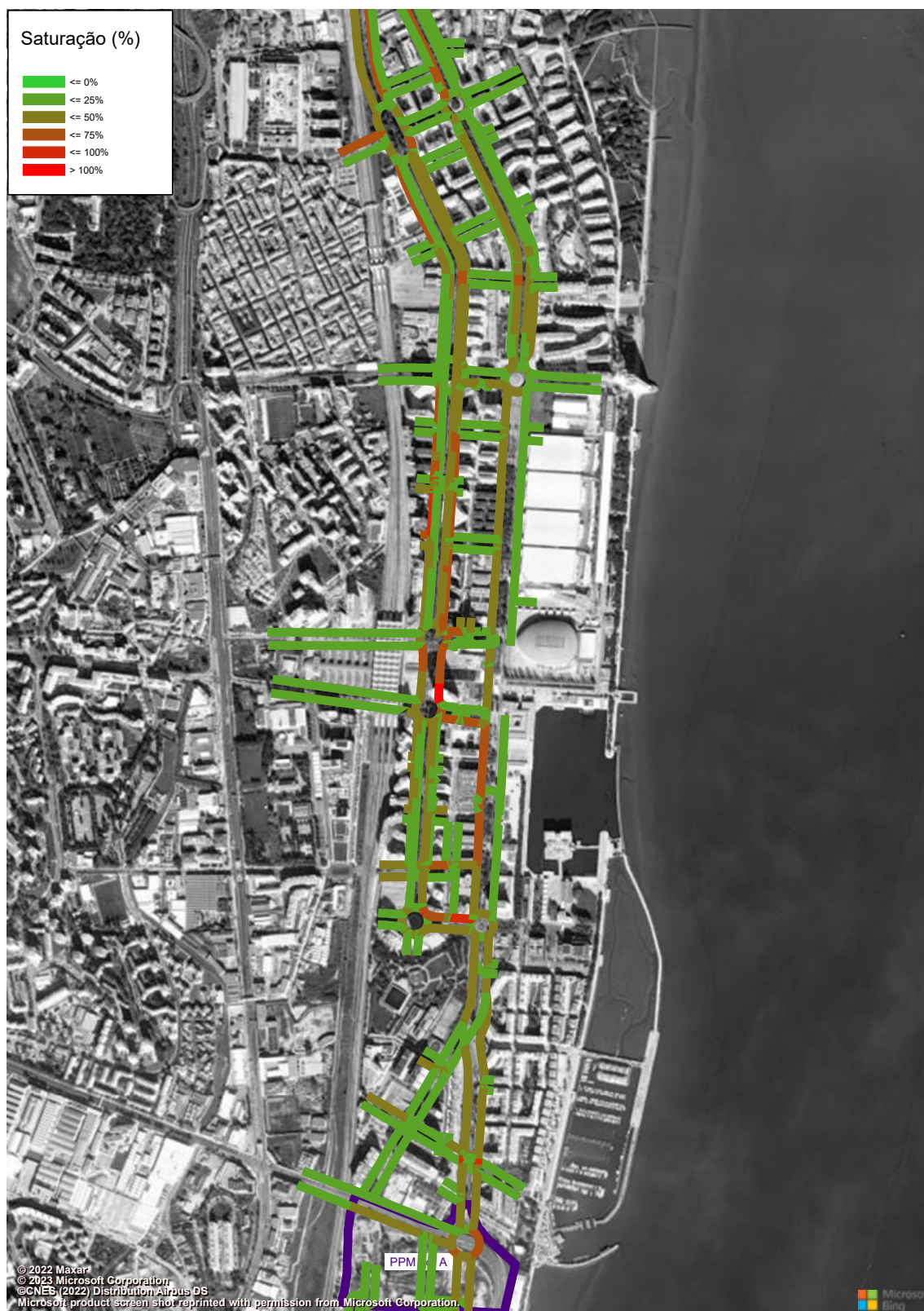
Figura 239 – Grau de Saturação (macro modelo de tráfego em PTV Visum, HPT-DU, Cenário RM2, Troço 7 a 10) (%).
