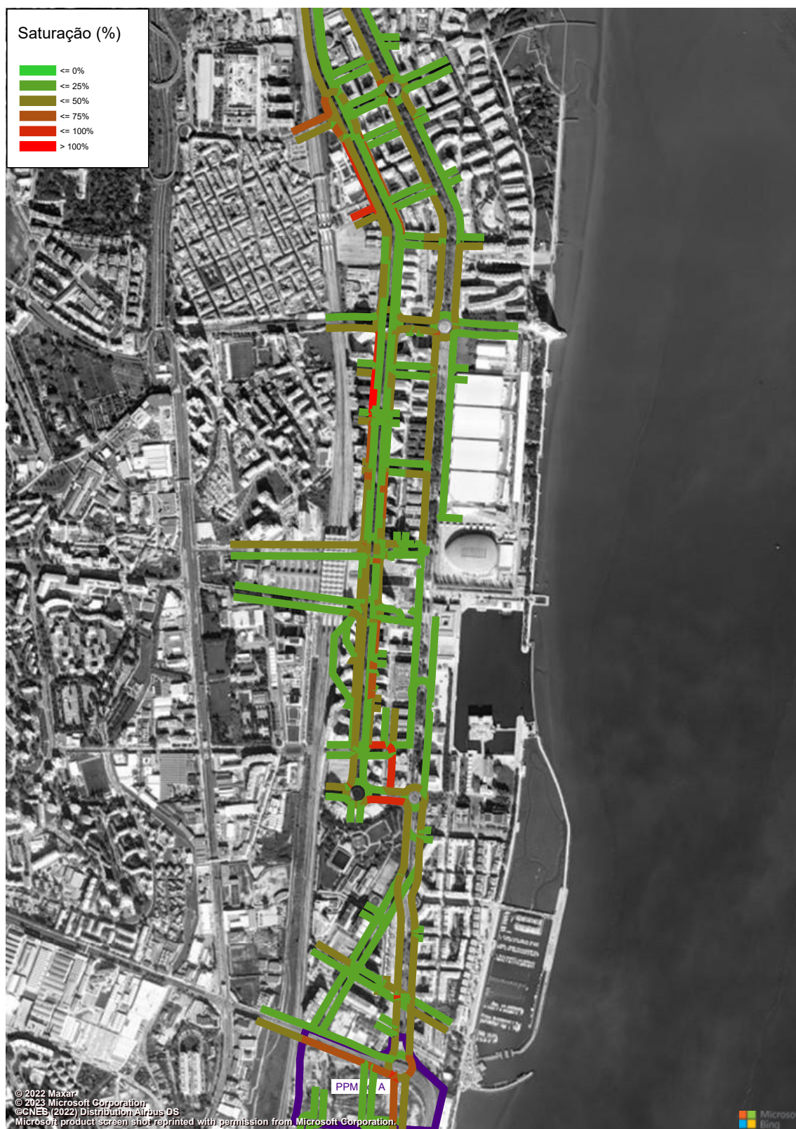
Figura 175 – Grau de Saturação (macro modelo de tráfego em PTV Visum, HPM-DU, Cenário F3, Troço 7 a 10) (%).
