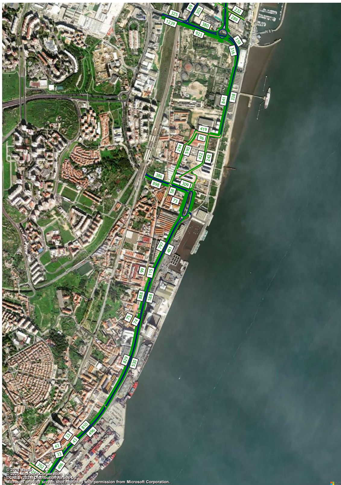
Figura 79 – Volumes de tráfego (macro modelo de tráfego em PTV Visum, HPM-DU, Cenário A0, Troço 5 a 6) (uvle/hora).
