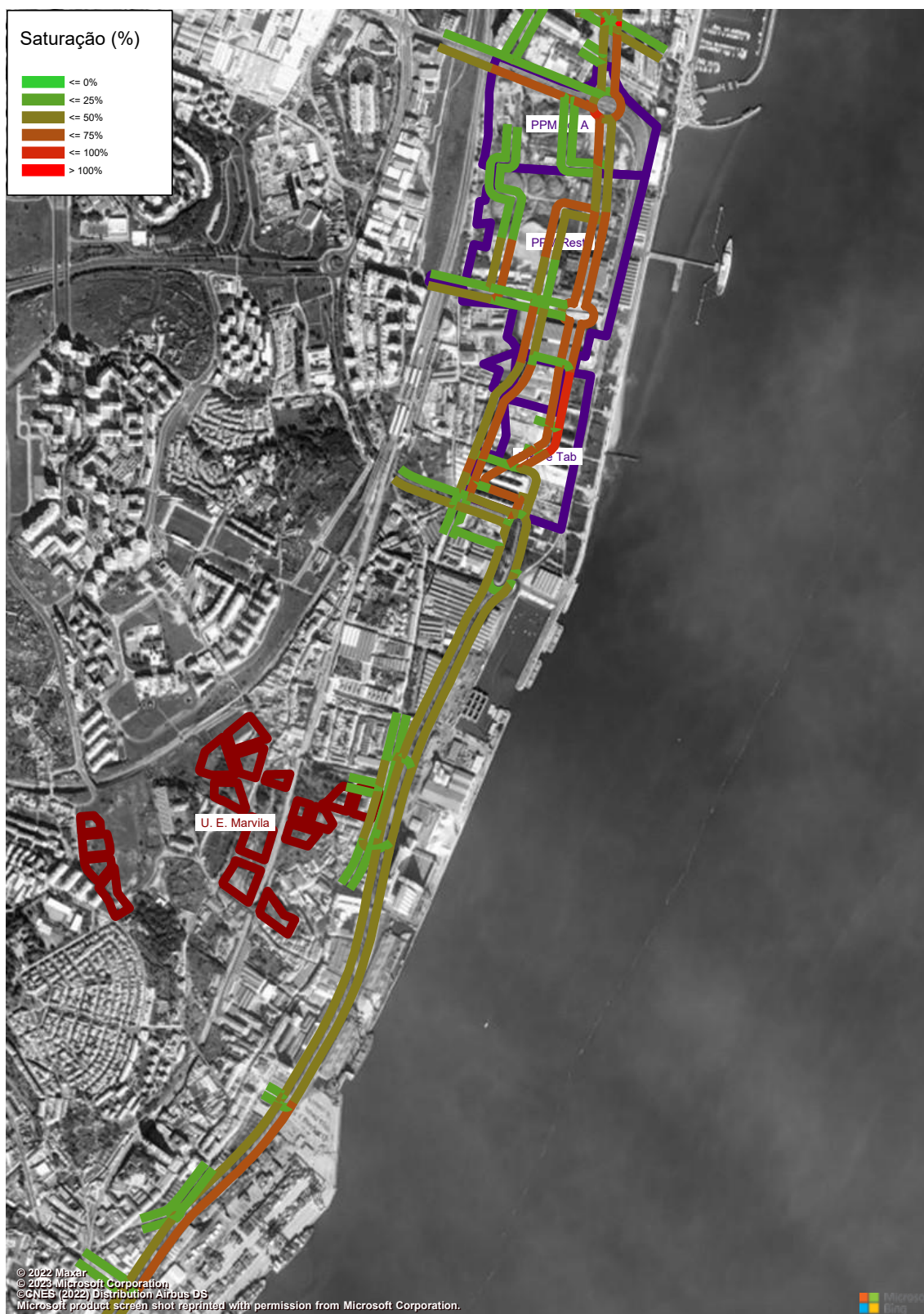
Figura 110 – Grau de Saturação (macro modelo de tráfego em PTV Visum, HPM-DU, Cenário F0, Troço 5 a 6) (%).
