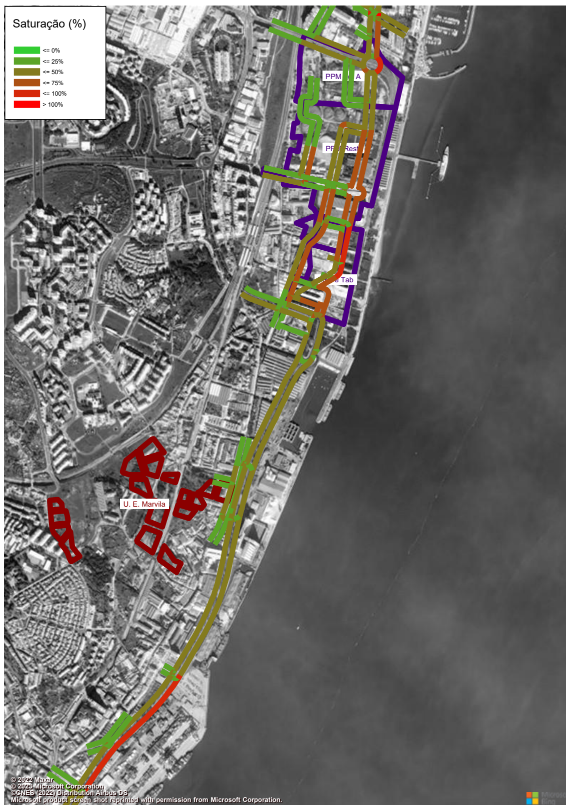
Figura 111 – Grau de Saturação (macro modelo de tráfego em PTV Visum, HPT-DU, Cenário F0, Troço 5 a 6) (%).
