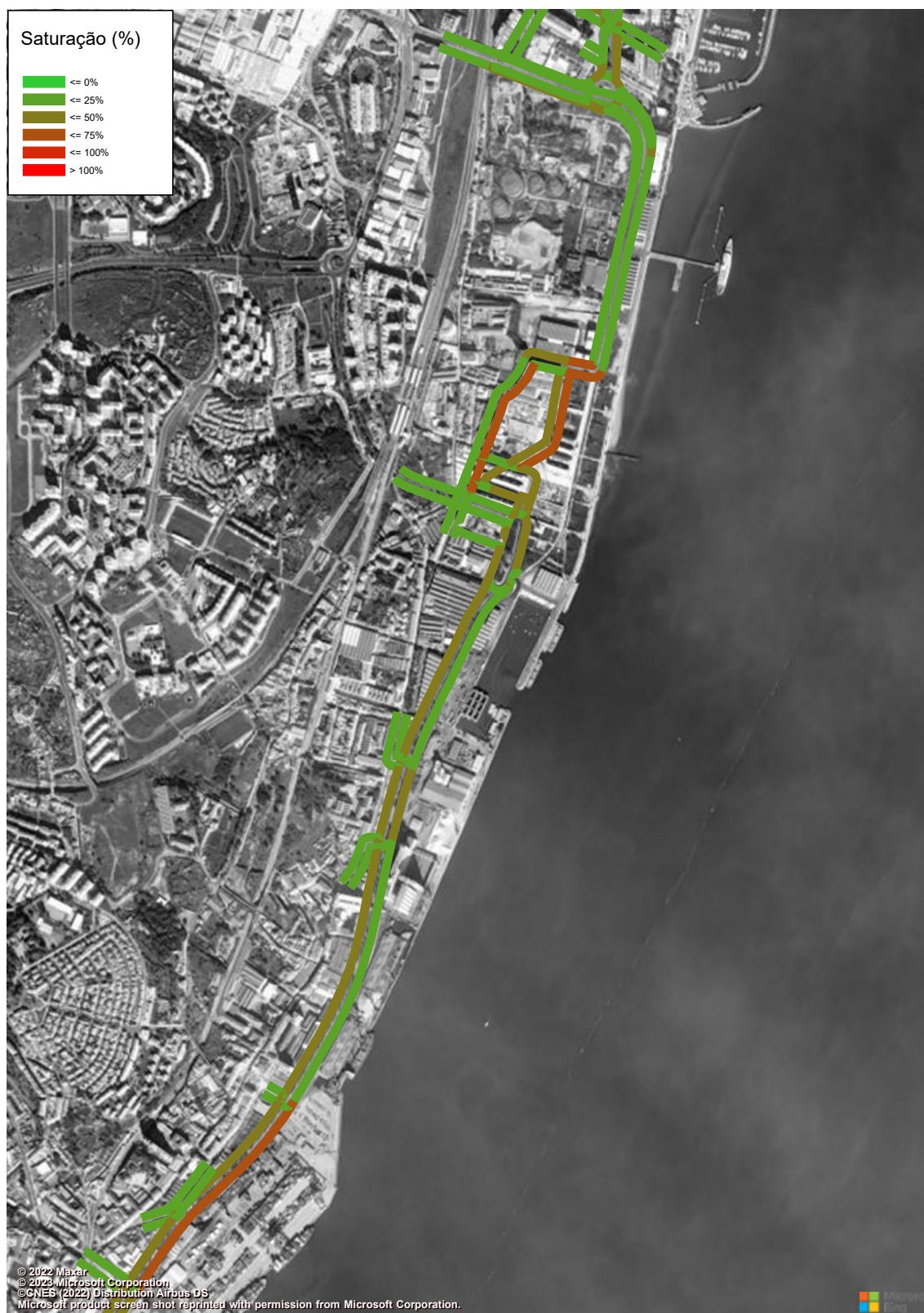
Figura 90 – Grau de Saturação (macro modelo de tráfego em PTV Visum, HPT-DU, Cenário A0, Troço 5 a 6) (%).
