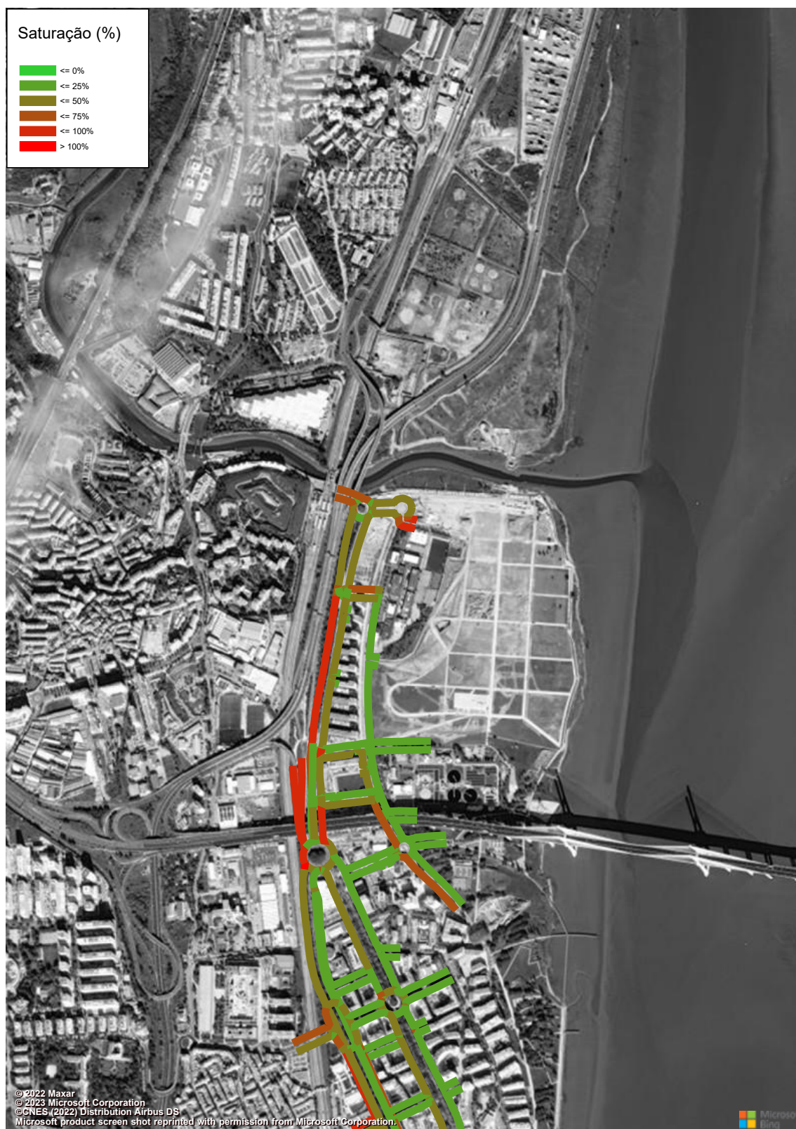
Figura 198 – Grau de Saturação (macro modelo de tráfego em PTV Visum, HPM-DU, Cenário FR, Troço 11 a 12) (%).
