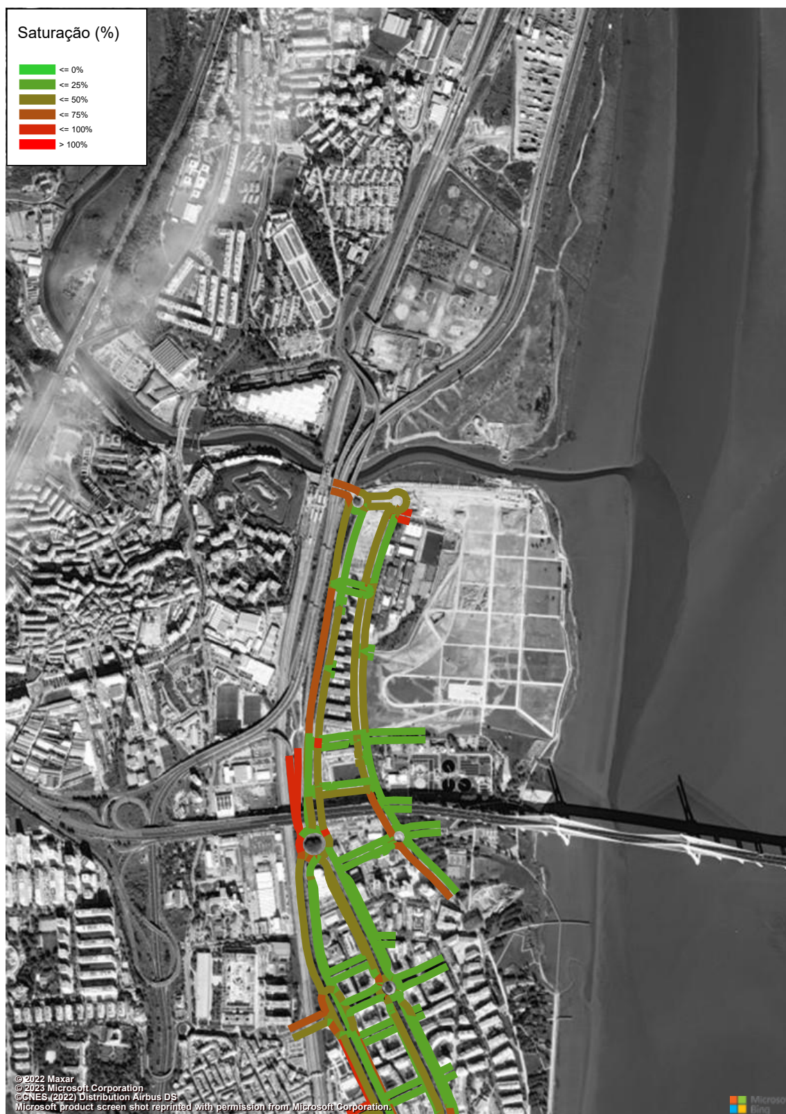
Figura 114 – Grau de Saturação (macro modelo de tráfego em PTV Visum, HPM-DU, Cenário F0, Troço 11 a 12) (%).
