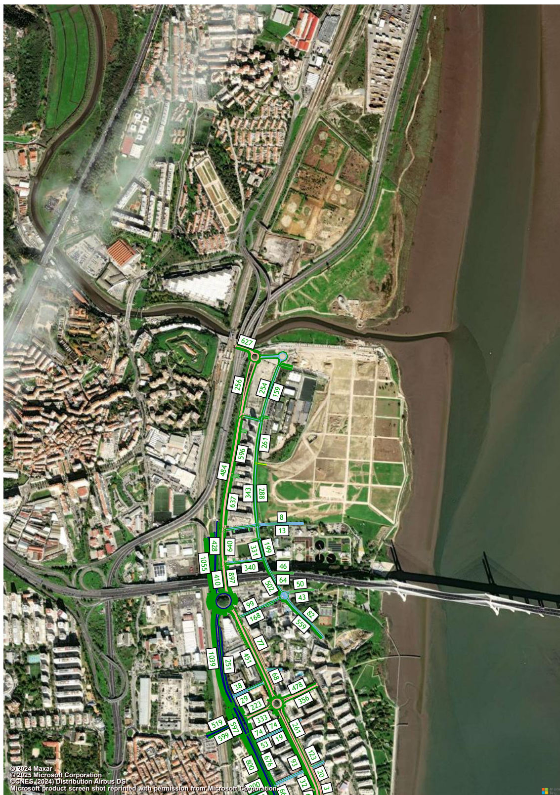
Figura 83 – Volumes de tráfego (macro modelo de tráfego em PTV Visum, HPM-DU, Cenário A0, Troço 11 a 12) (uvle/hora).
