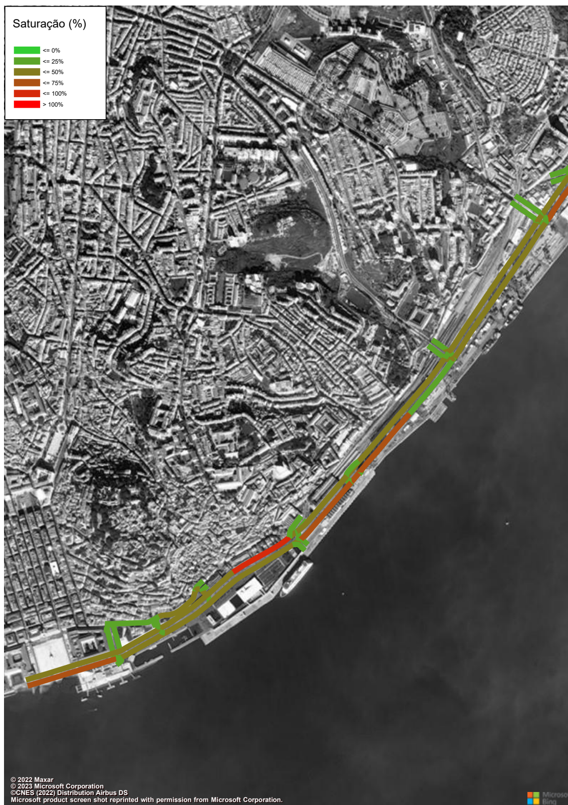
Figura 88 – Grau de Saturação (macro modelo de tráfego em PTV Visum, HPT-DU, Cenário A0, Troço 1 a 4) (%).
