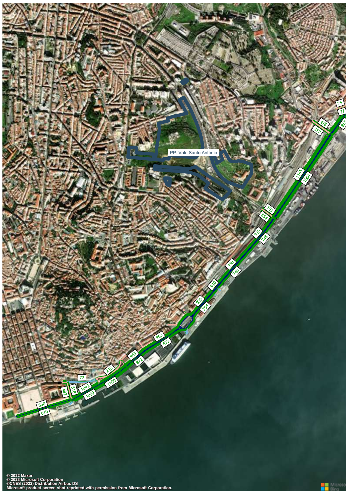
Figura 204 – Volumes de tráfego (macro modelo de tráfego em PTV Visum, HPT-DU, Cenário RM1, Troço 1 a 4) (uvle/hora).
