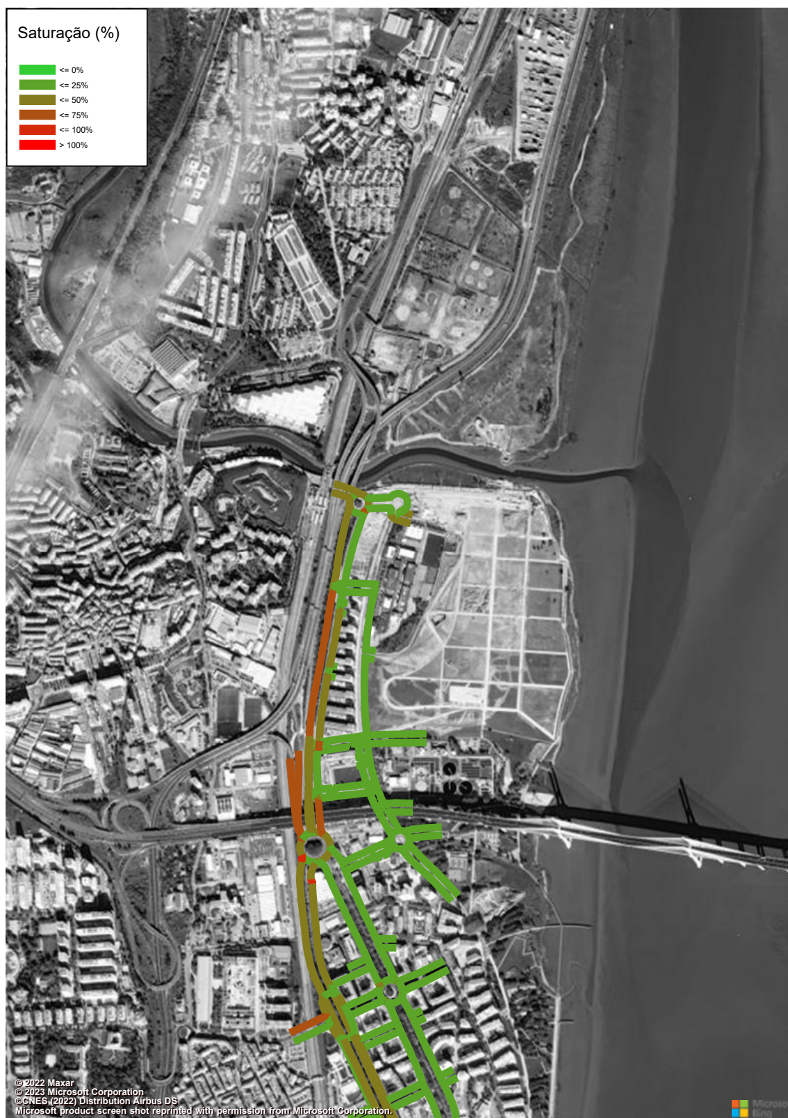
Figura 220 – Grau de Saturação (macro modelo de tráfego em PTV Visum, HPT-DU, Cenário RM1, Troço 11 a 12) (%).
