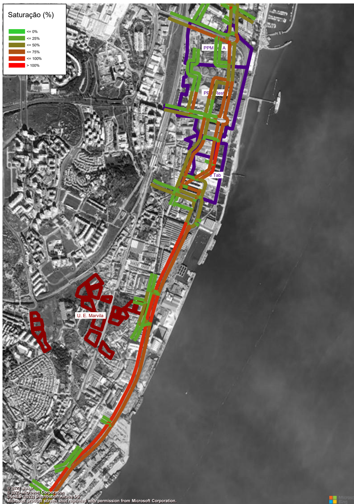
Figura 131 – Grau de Saturação (macro modelo de tráfego em PTV Visum, HPM-DU, Cenário F1, Troço 5 a 6) (%).
