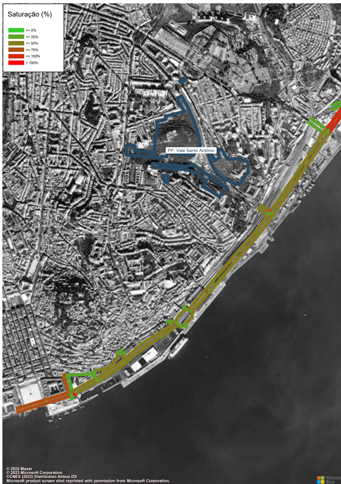
Figura 130 – Grau de Saturação (macro modelo de tráfego em PTV Visum, HPT-DU, Cenário F1, Troço 1 a 4) (%).
