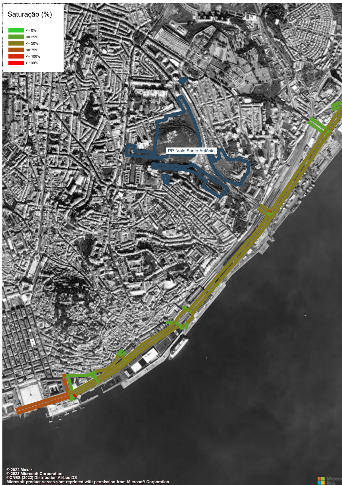
Figura 193 – Grau de Saturação (macro modelo de tráfego em PTV Visum, HPT-DU, Cenário FR, Troço 1 a 4) (%).
