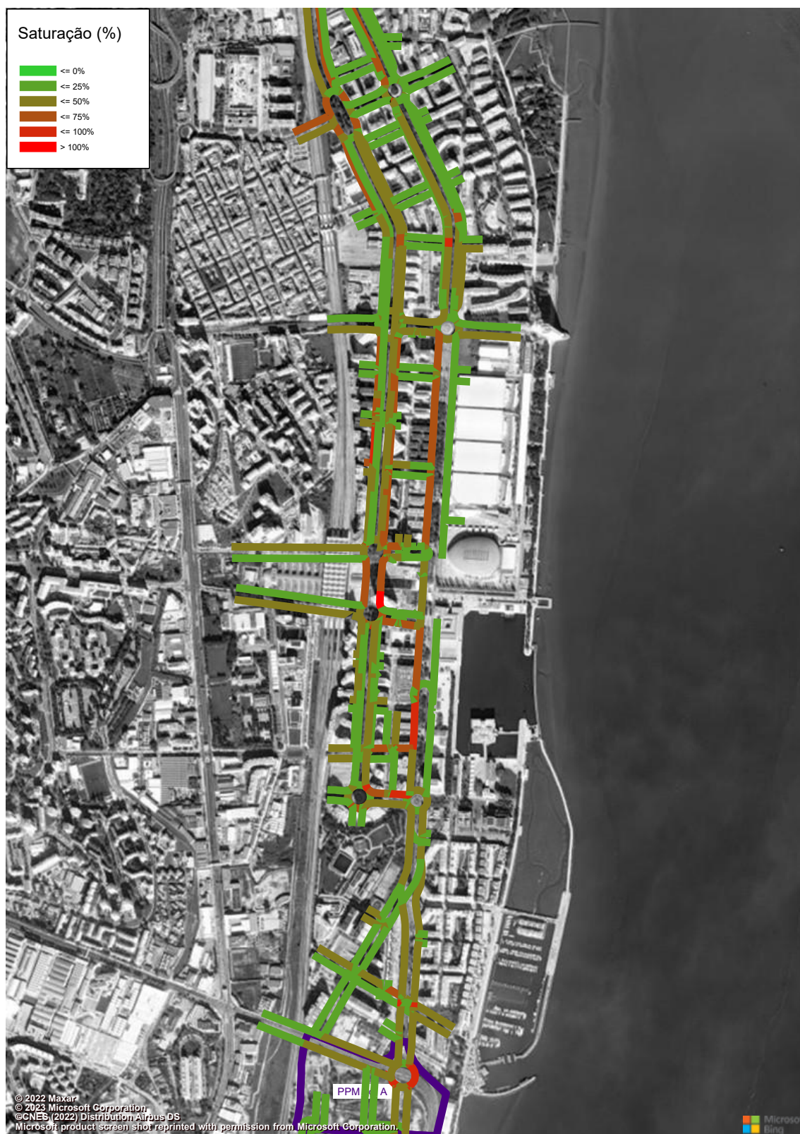
Figura 155 – Grau de Saturação (macro modelo de tráfego em PTV Visum, HPT-DU, Cenário F2, Troço 7 a 10) (%).
