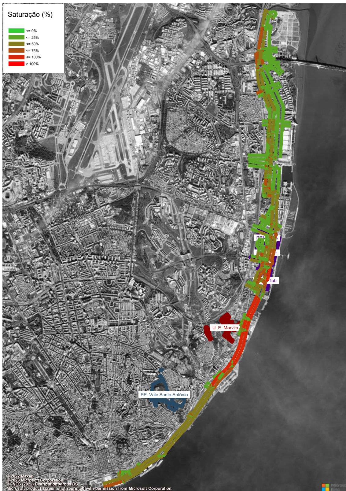
Figura 212 – Grau de Saturação (macro modelo de tráfego em PTV Visum, HPT-DU, Cenário RM1) (%).
