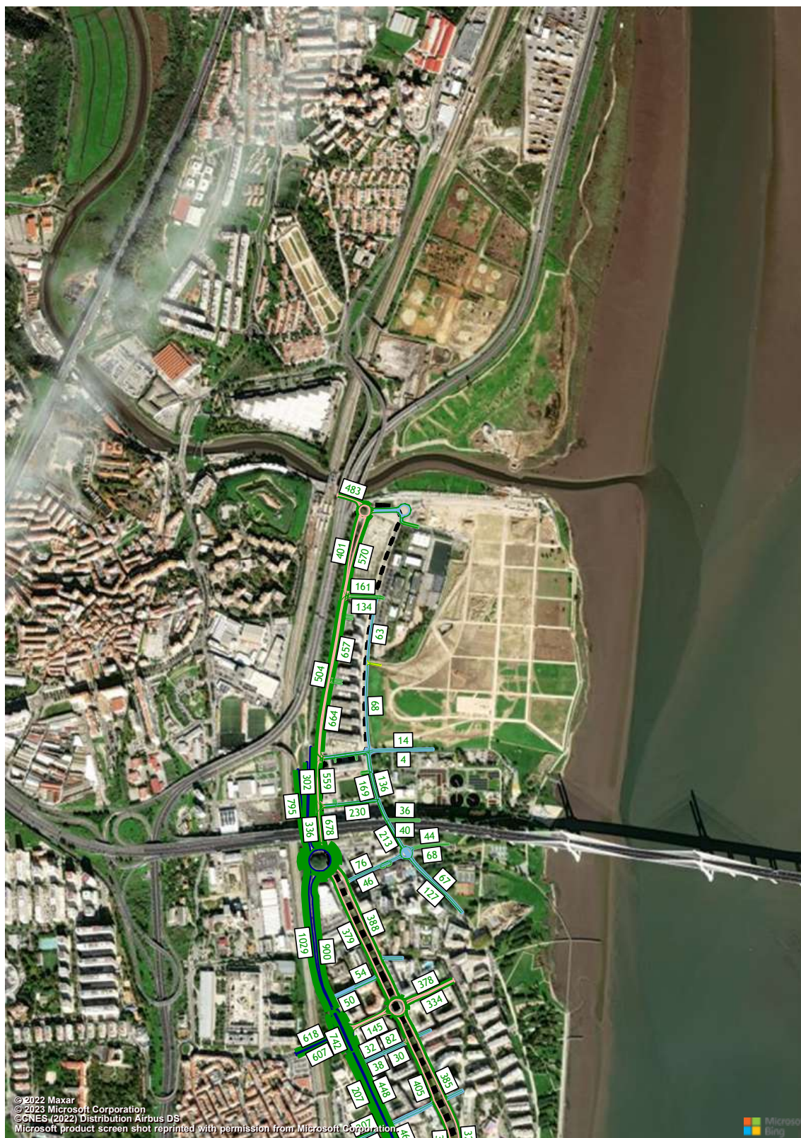
Figura 210 – Volumes de tráfego (macro modelo de tráfego em PTV Visum, HPT-DU, Cenário RM1, Troço 11 a 12) (uvle/hora).
