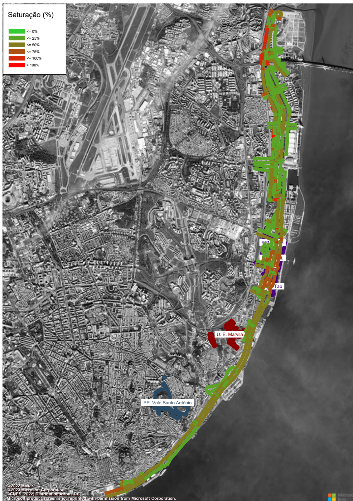
Figura 253 – Grau de Saturação (macro modelo de tráfego em PTV Visum, HPM-DU, Cenário RM3) (%).
