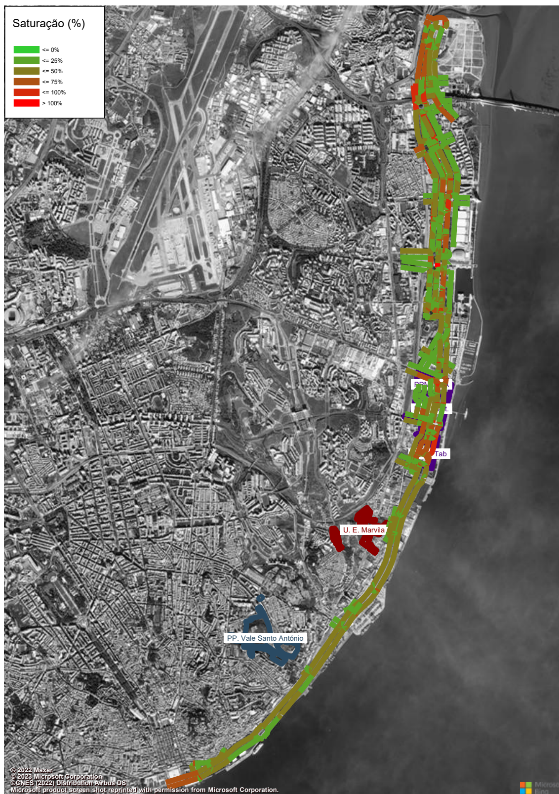
Figura 148 – Grau de Saturação (macro modelo de tráfego em PTV Visum, HPM-DU, Cenário F2) (%).
