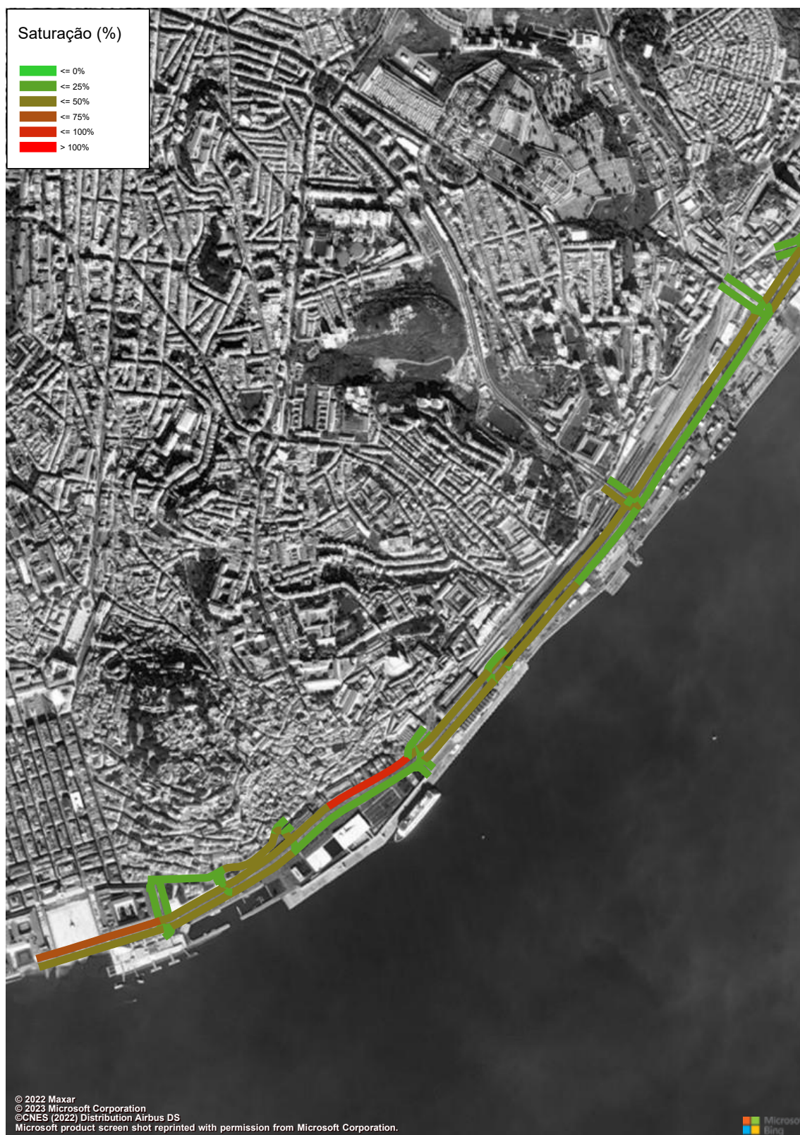
Figura 87 – Grau de Saturação (macro modelo de tráfego em PTV Visum, HPM-DU, Cenário A0, Troço 1 a 4) (%).
