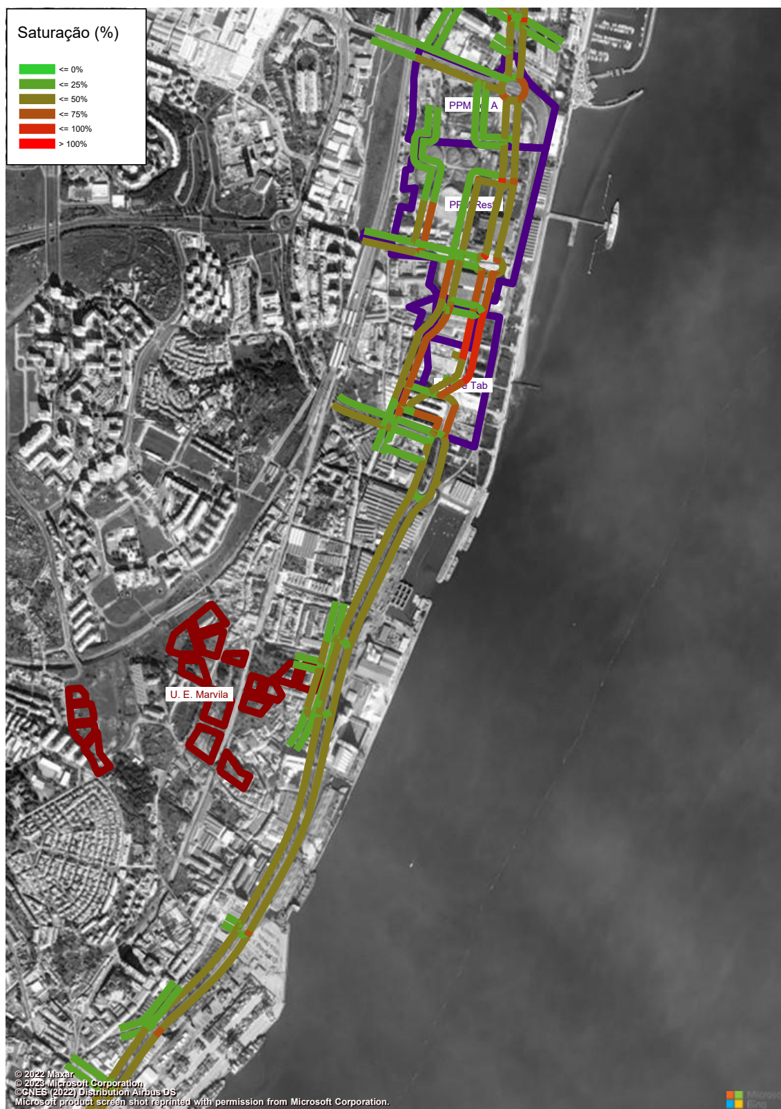
Figura 237 – Grau de Saturação (macro modelo de tráfego em PTV Visum, HPT-DU, Cenário RM2, Troço 5 a 6) (%).
