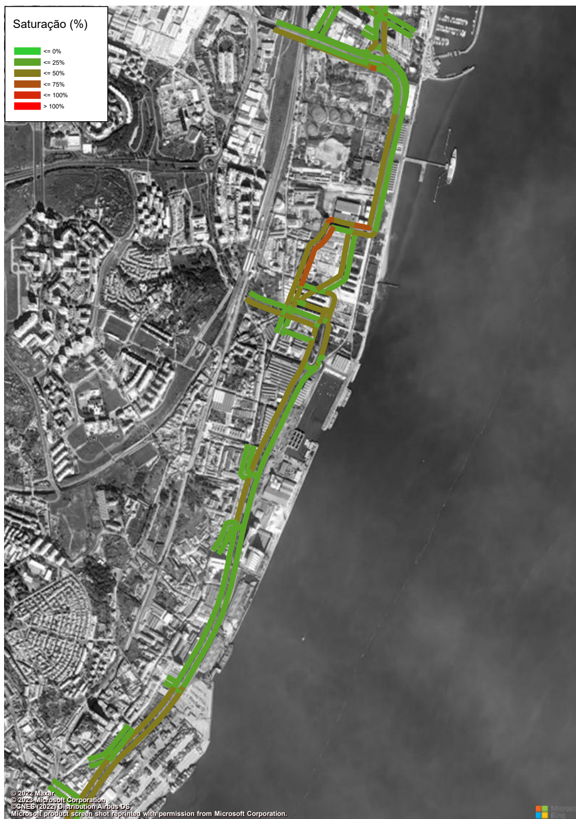
Figura 89 – Grau de Saturação (macro modelo de tráfego em PTV Visum, HPM-DU, Cenário A0, Troço 5 a 6) (%).
