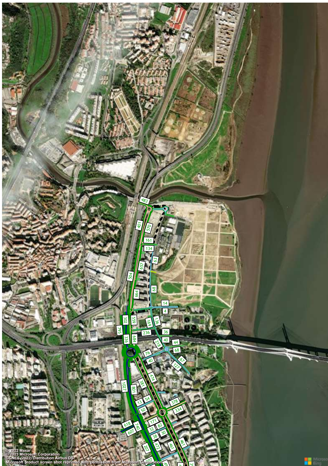
Figura 252 – Volumes de tráfego (macro modelo de tráfego em PTV Visum, HPT-DU, Cenário RM3, Troço 11 a 12) (uvle/hora).
