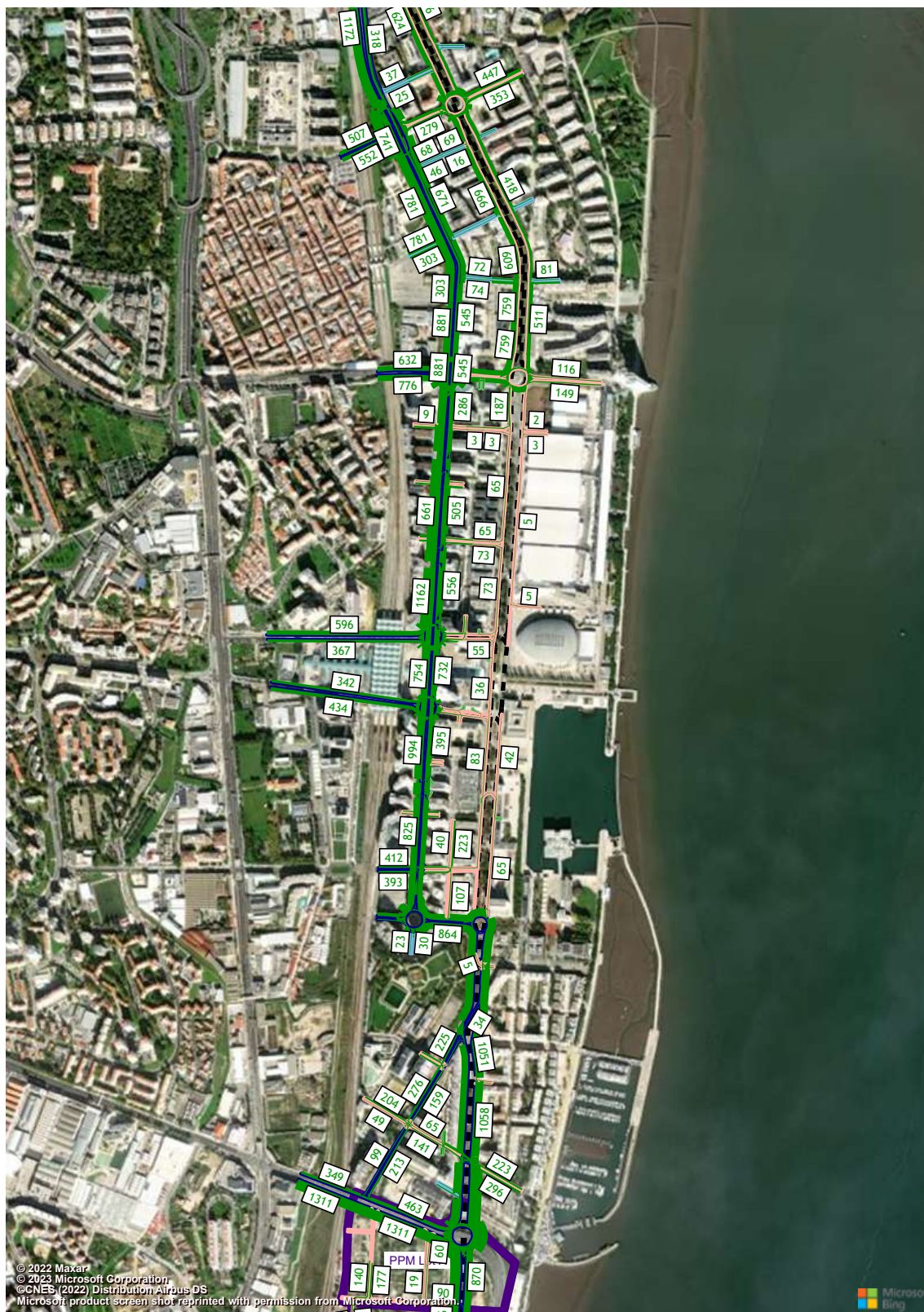
Figura 270 – Volumes de tráfego (macro modelo de tráfego em PTV Visum, HPM-DU, Cenário RMR, Troço 7 a 10) (uvle/hora).
