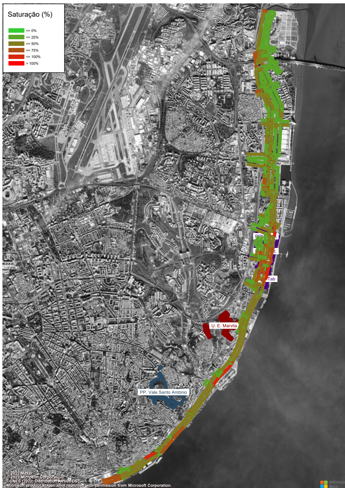
Figura 107 – Grau de Saturação (macro modelo de tráfego em PTV Visum, HPT-DU, Cenário F0) (%).
