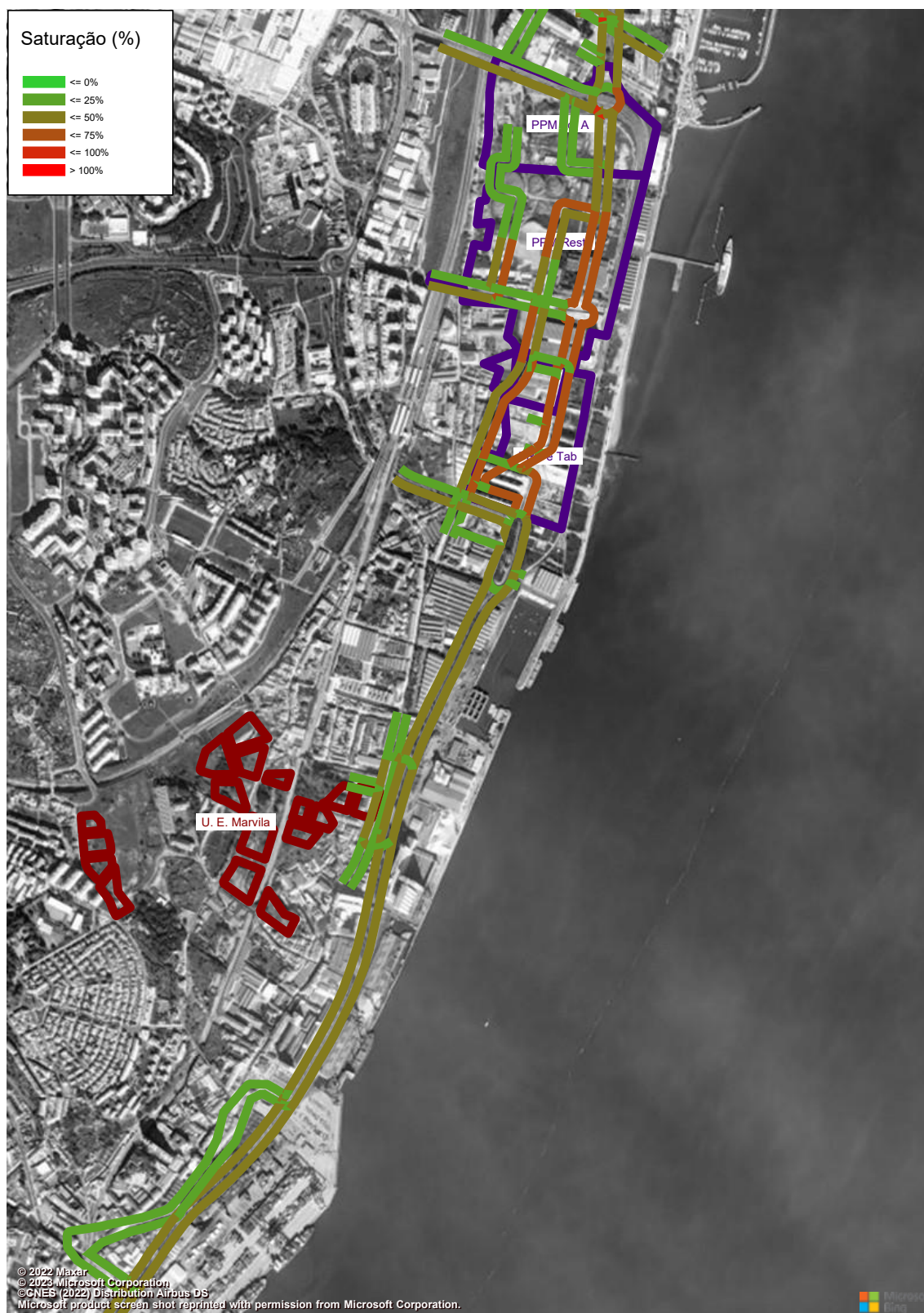
Figura 257 – Grau de Saturação (macro modelo de tráfego em PTV Visum, HPM-DU, Cenário RM3, Troço 5 a 6) (%).
