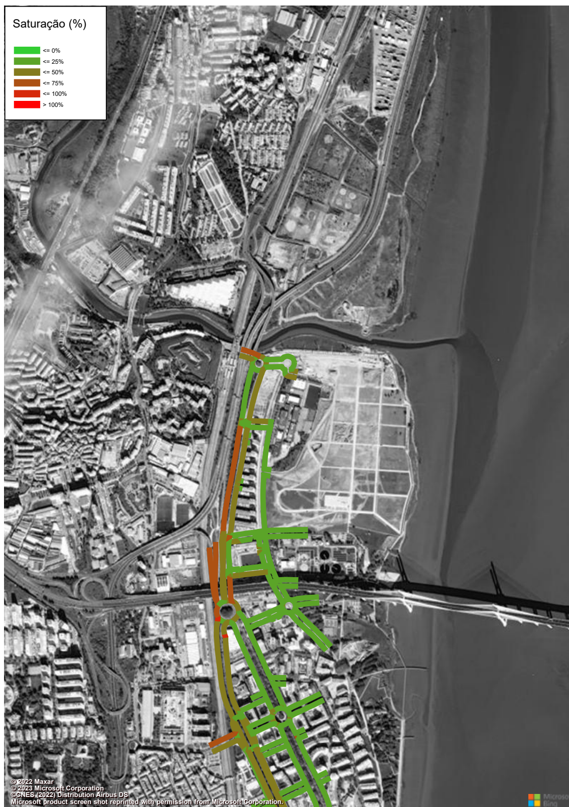
Figura 199 – Grau de Saturação (macro modelo de tráfego em PTV Visum, HPT-DU, Cenário FR, Troço 11 a 12) (%).
