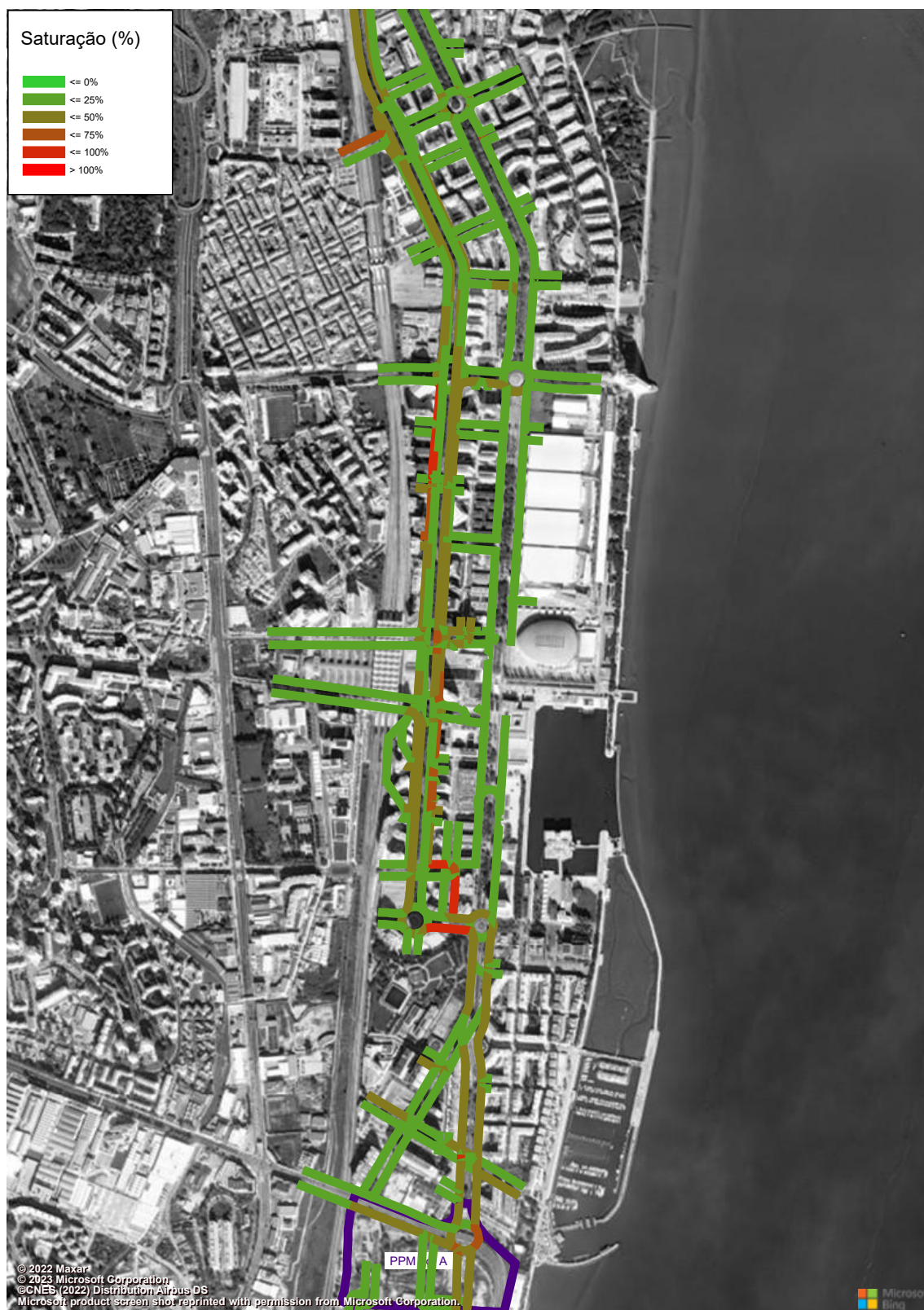
Figura 260 – Grau de Saturação (macro modelo de tráfego em PTV Visum, HPT-DU, Cenário RM3, Troço 7 a 10) (%).
