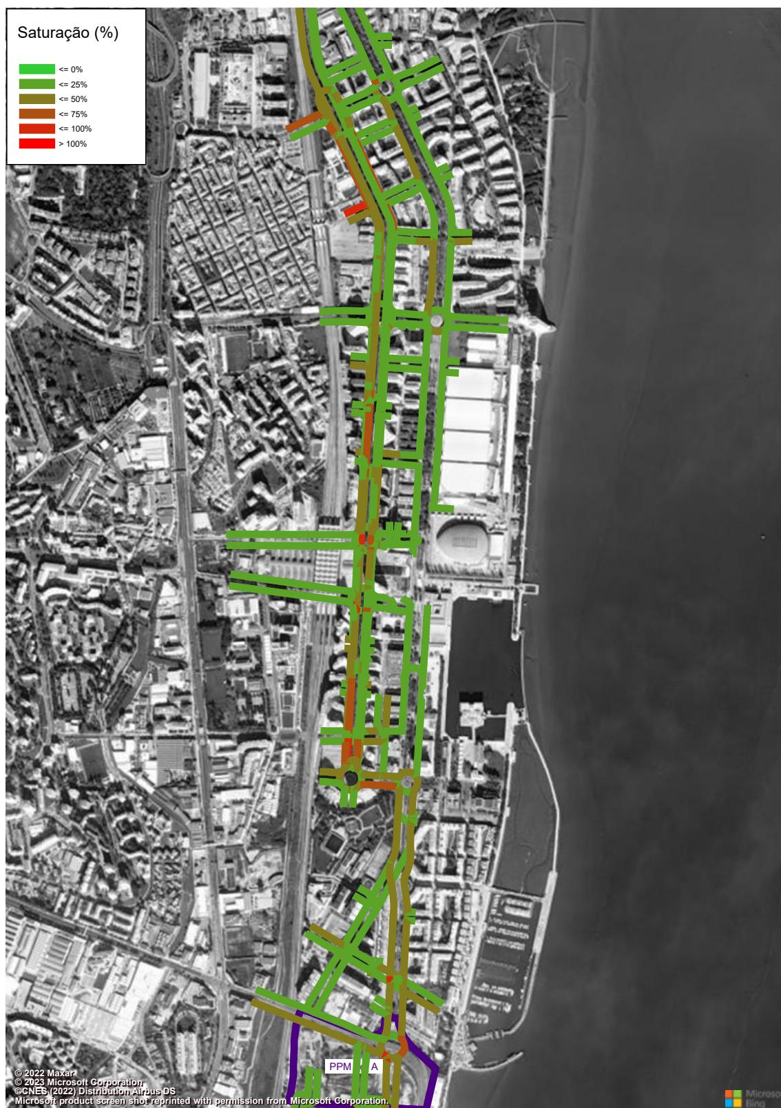
Figura 217 – Grau de Saturação (macro modelo de tráfego em PTV Visum, HPM-DU, Cenário RM1, Troço 7 a 10) (%).
