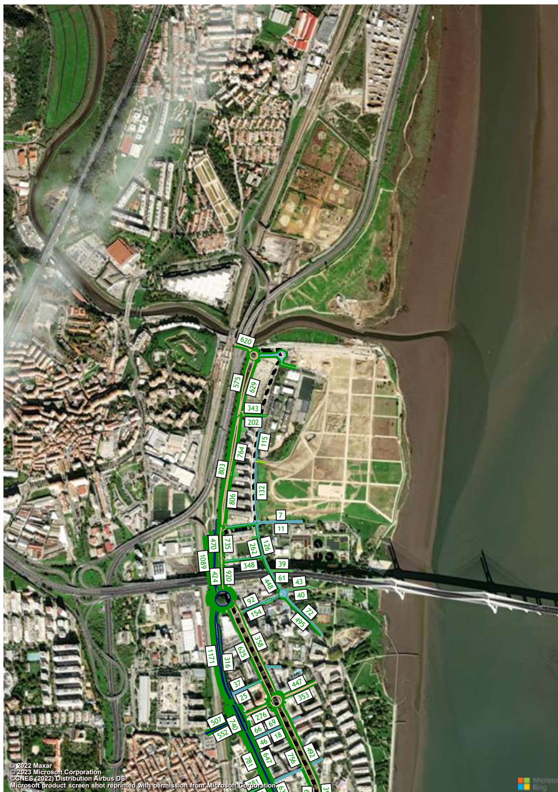
Figura 251 – Volumes de tráfego (macro modelo de tráfego em PTV Visum, HPM-DU, Cenário RM3, Troço 11 a 12) (uvle/hora).
