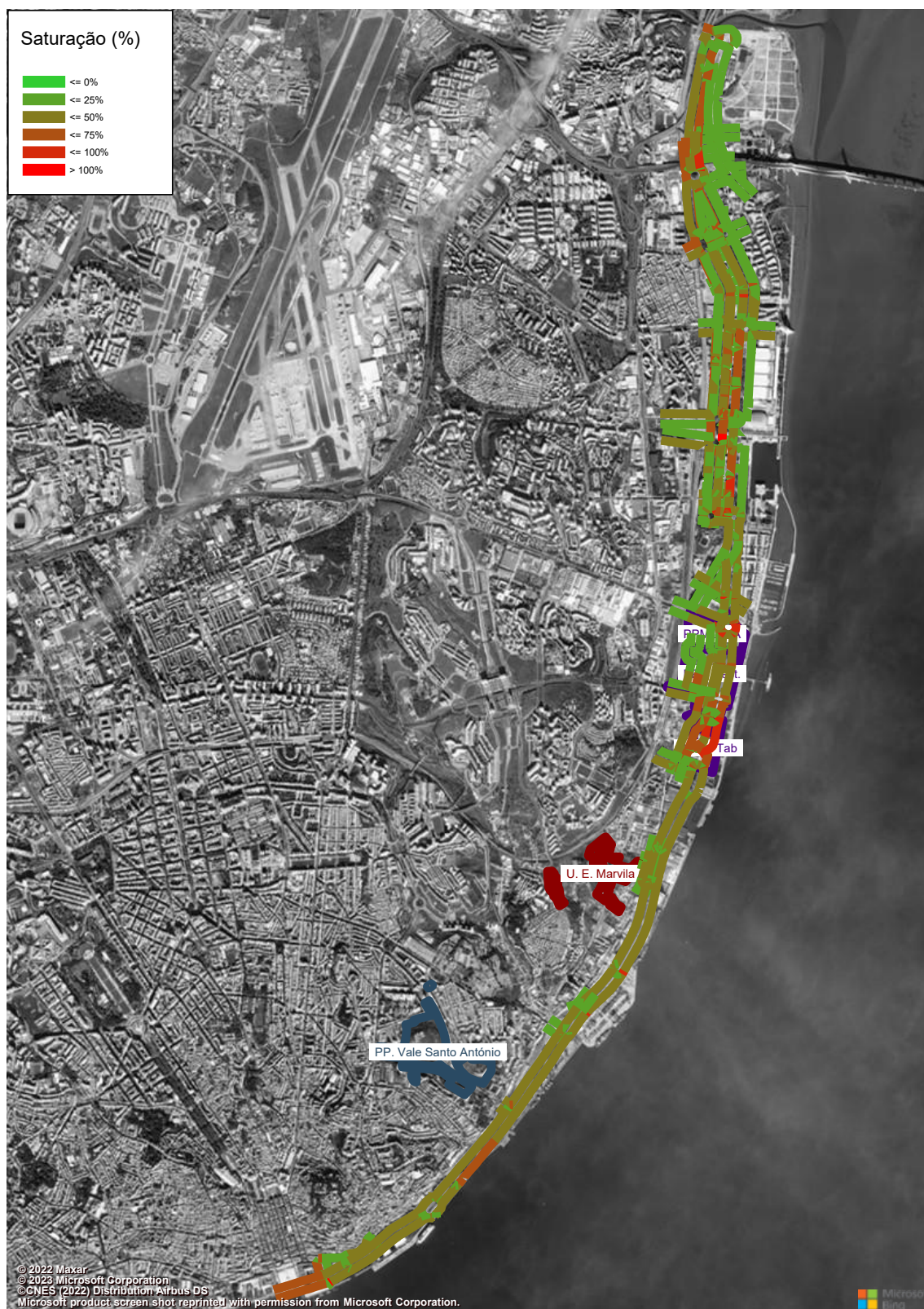
Figura 149 – Grau de Saturação (macro modelo de tráfego em PTV Visum, HPT-DU, Cenário F2) (%).
