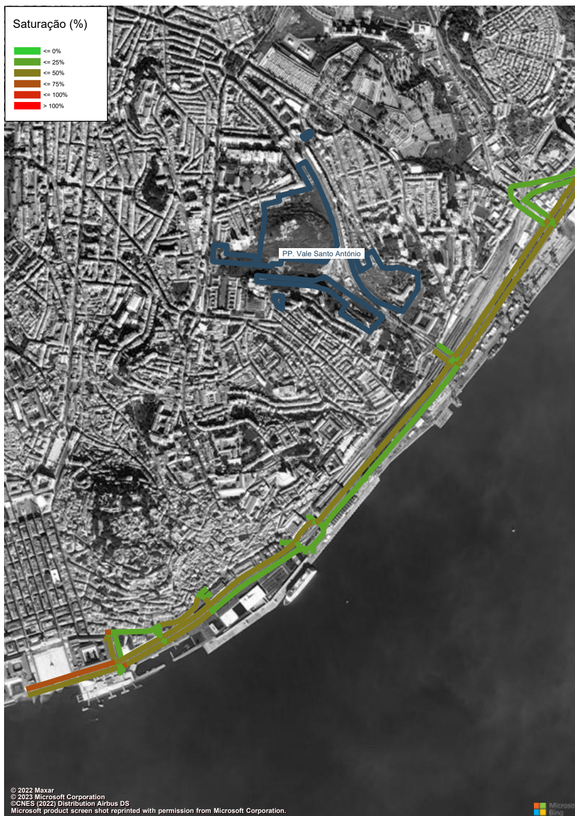
Figura 255 – Grau de Saturação (macro modelo de tráfego em PTV Visum, HPM-DU, Cenário RM3, Troço 1 a 4) (%).
