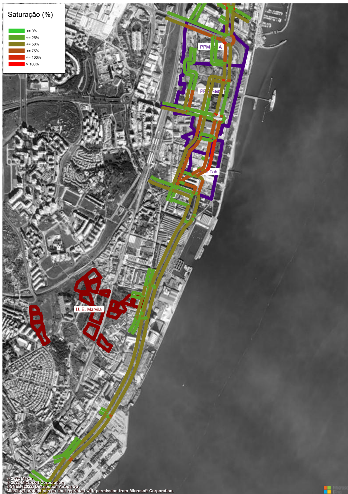
Figura 152 – Grau de Saturação (macro modelo de tráfego em PTV Visum, HPM-DU, Cenário F2, Troço 5 a 6) (%).
