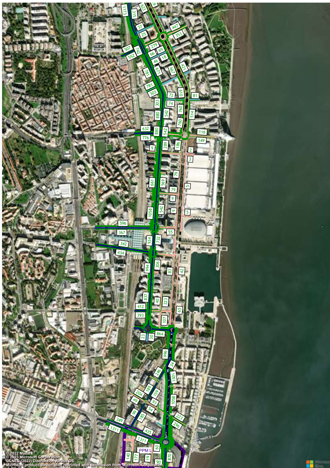
Figura 207 – Volumes de tráfego (macro modelo de tráfego em PTV Visum, HPM-DU, Cenário RM1, Troço 7 a 10) (uvle/hora).
