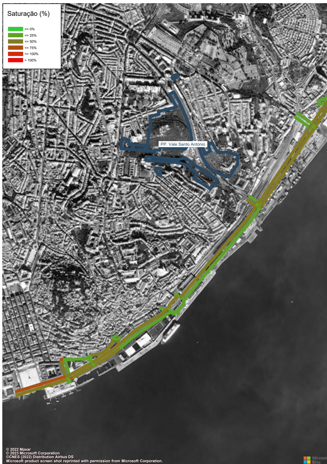
Figura 276 – Grau de Saturação (macro modelo de tráfego em PTV Visum, HPM-DU, Cenário RMR, Troço 1 a 4) (%).
