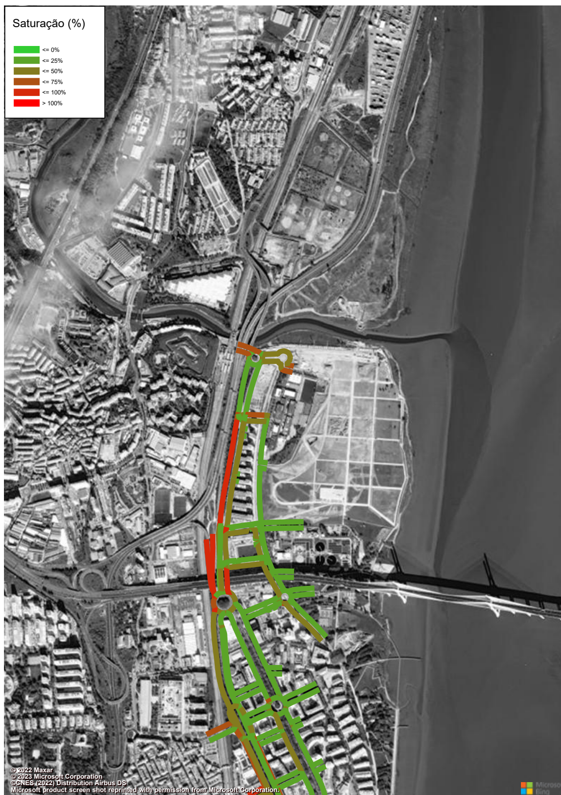
Figura 282 – Grau de Saturação (macro modelo de tráfego em PTV Visum, HPM-DU, Cenário RMR, Troço 11 a 12) (%).
