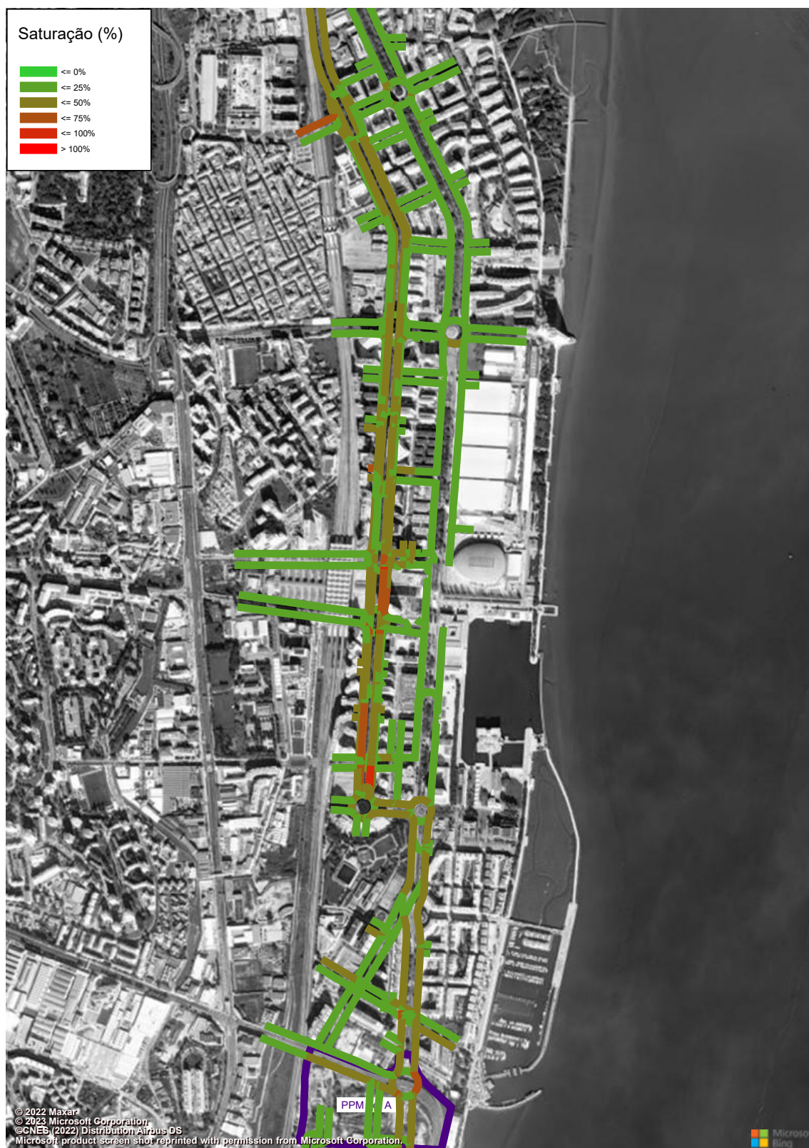
Figura 281 – Grau de Saturação (macro modelo de tráfego em PTV Visum, HPT-DU, Cenário RMR, Troço 7 a 10) (%).
