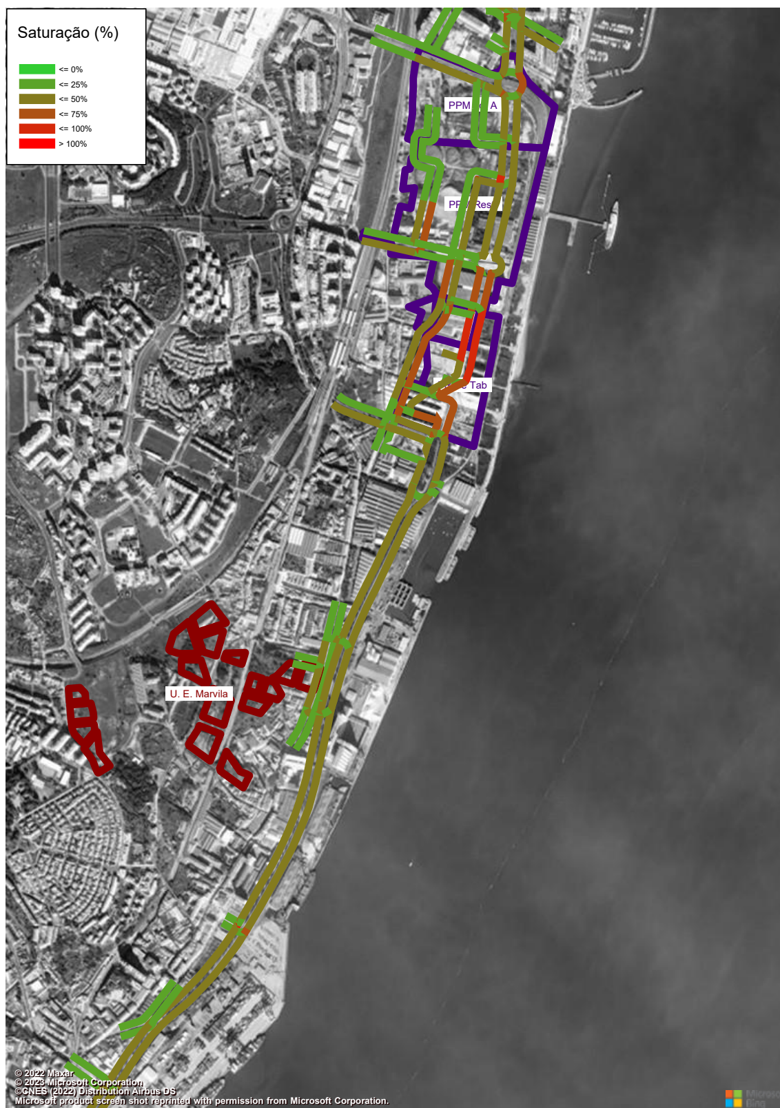
Figura 279 – Grau de Saturação (macro modelo de tráfego em PTV Visum, HPT-DU, Cenário RMR, Troço 5 a 6) (%).
