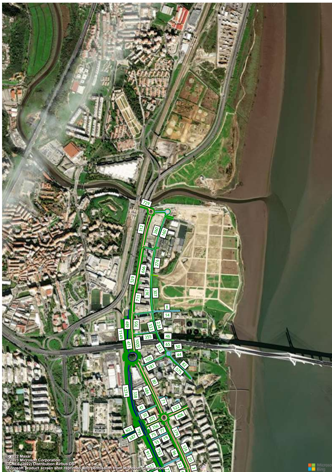
Figura 104 – Volumes de tráfego (macro modelo de tráfego em PTV Visum, HPM-DU, Cenário F0, Troço 11 a 12) (uvle/hora).
