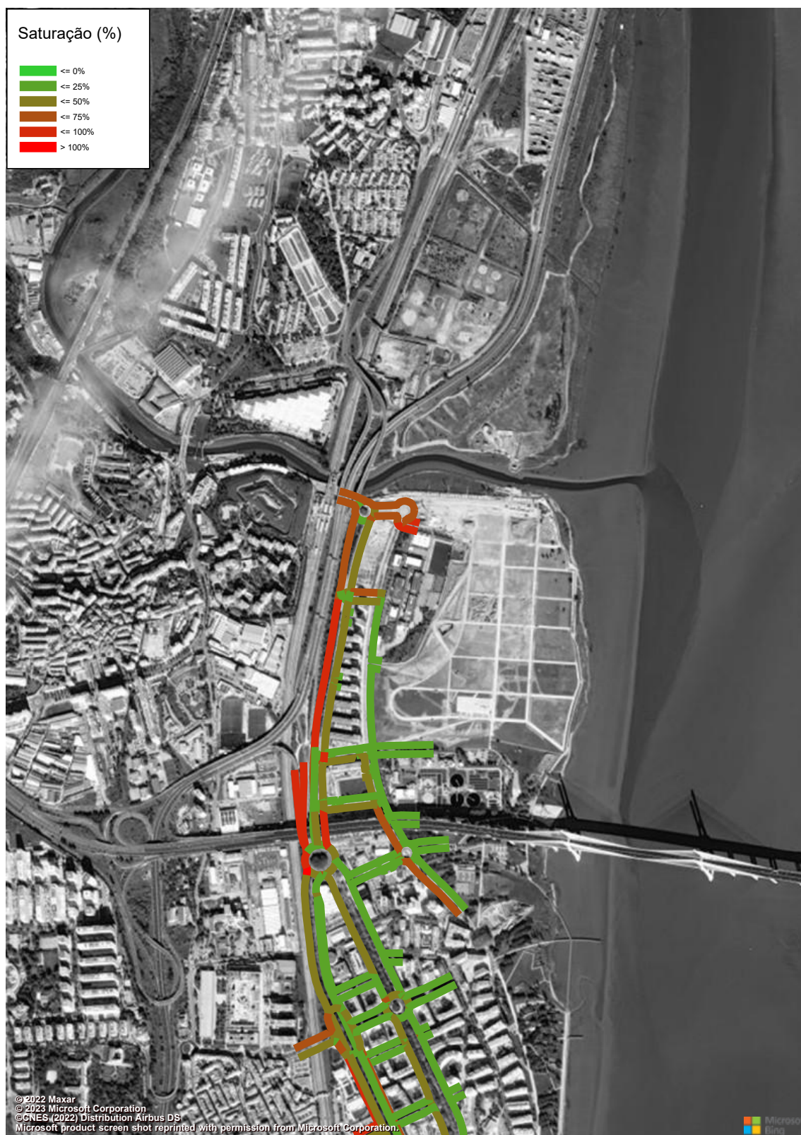
Figura 135 – Grau de Saturação (macro modelo de tráfego em PTV Visum, HPM-DU, Cenário F1, Troço 11 a 12) (%).
