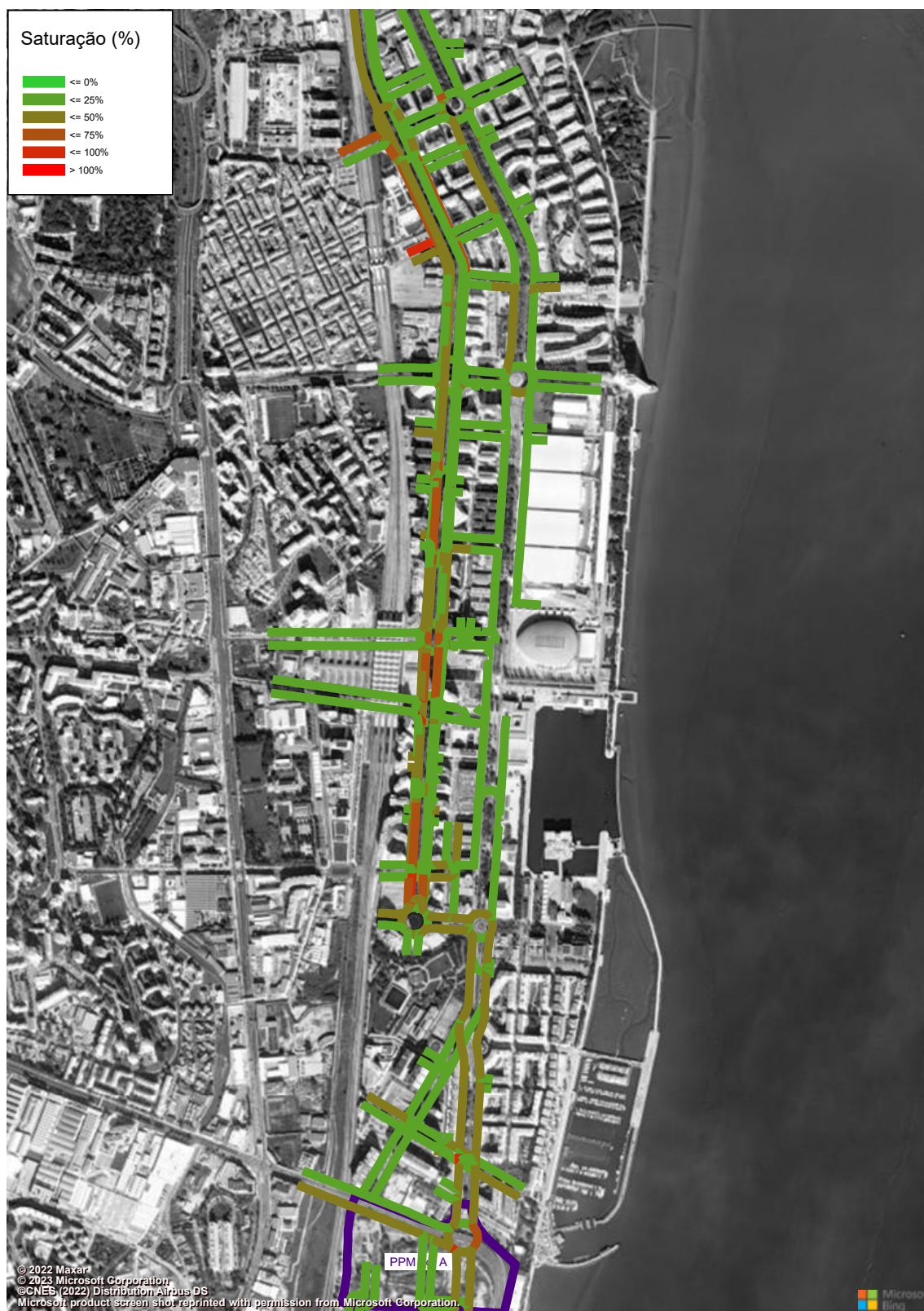
Figura 280 – Grau de Saturação (macro modelo de tráfego em PTV Visum, HPM-DU, Cenário RMR, Troço 7 a 10) (%).
