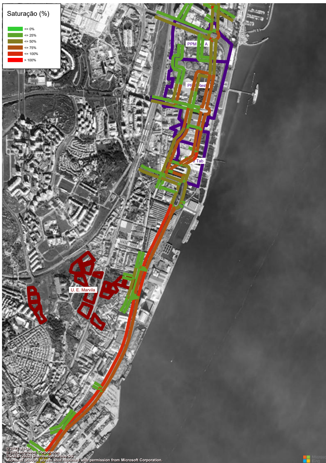
Figura 215 – Grau de Saturação (macro modelo de tráfego em PTV Visum, HPM-DU, Cenário RM1, Troço 5 a 6) (%).
