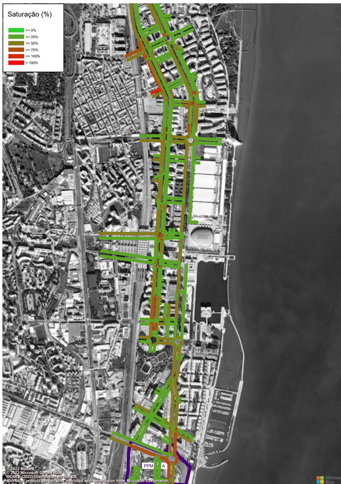
Figura 112 – Grau de Saturação (macro modelo de tráfego em PTV Visum, HPM-DU, Cenário F0, Troço 7 a 10) (%).
