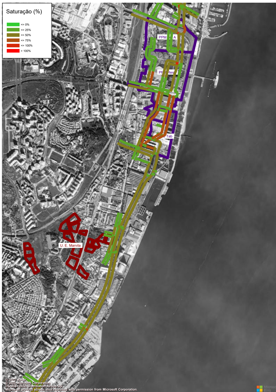
Figura 278 – Grau de Saturação (macro modelo de tráfego em PTV Visum, HPM-DU, Cenário RMR, Troço 5 a 6) (%).
