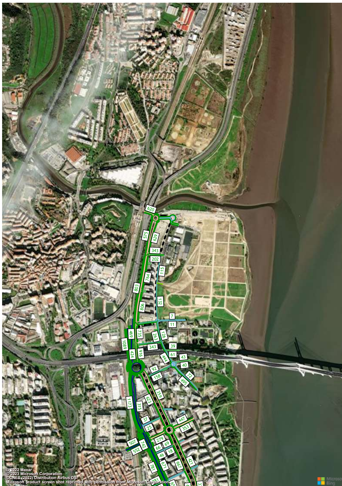
Figura 209 – Volumes de tráfego (macro modelo de tráfego em PTV Visum, HPM-DU, Cenário RM1, Troço 11 a 12) (uvle/hora).
