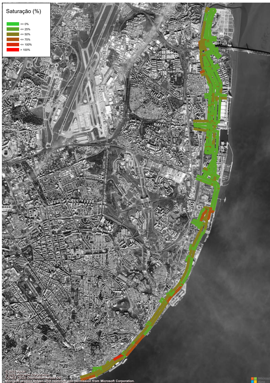
Figura 86 – Grau de Saturação (macro modelo de tráfego em PTV Visum, HPT-DU, Cenário A0) (%).
