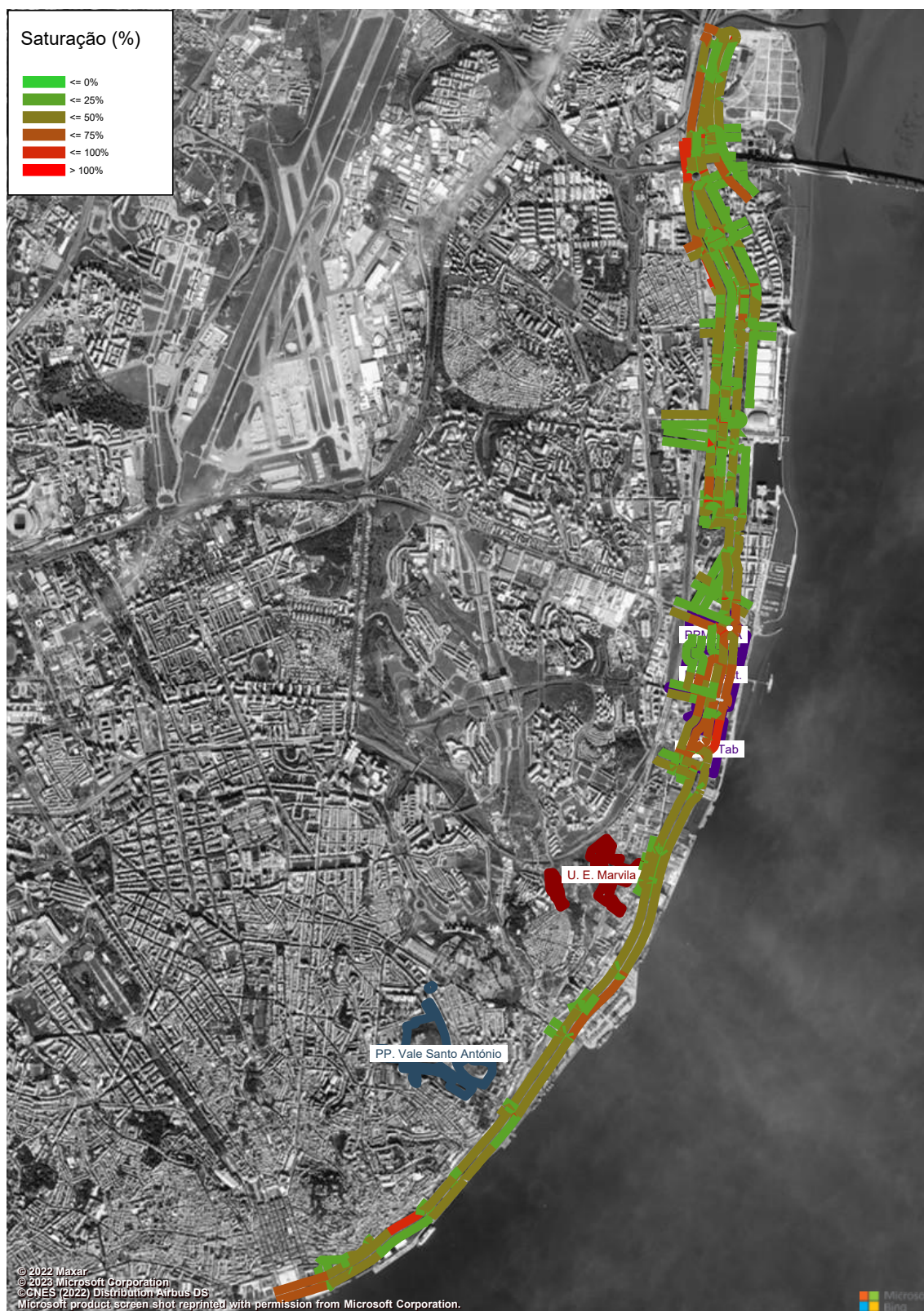
Figura 106 – Grau de Saturação (macro modelo de tráfego em PTV Visum, HPM-DU, Cenário F0) (%).
