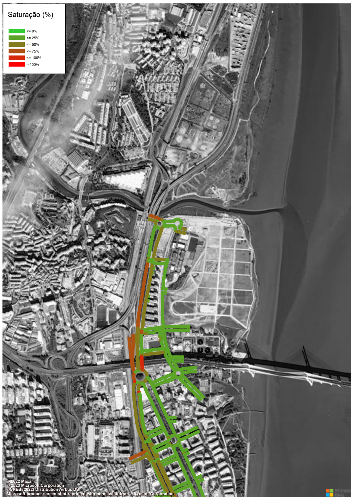
Figura 178 – Grau de Saturação (macro modelo de tráfego em PTV Visum, HPT-DU, Cenário F3, Troço 11 a 12) (%).
