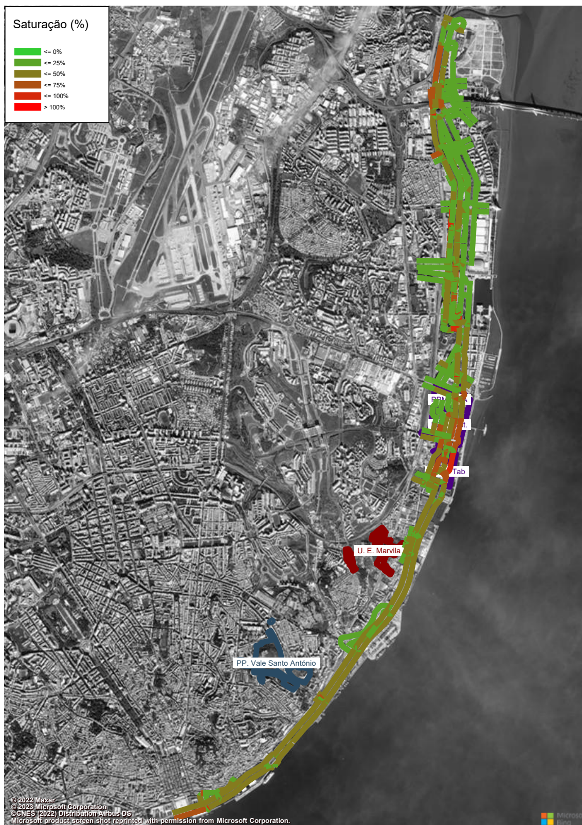
Figura 254 – Grau de Saturação (macro modelo de tráfego em PTV Visum, HPT-DU, Cenário RM3) (%).
