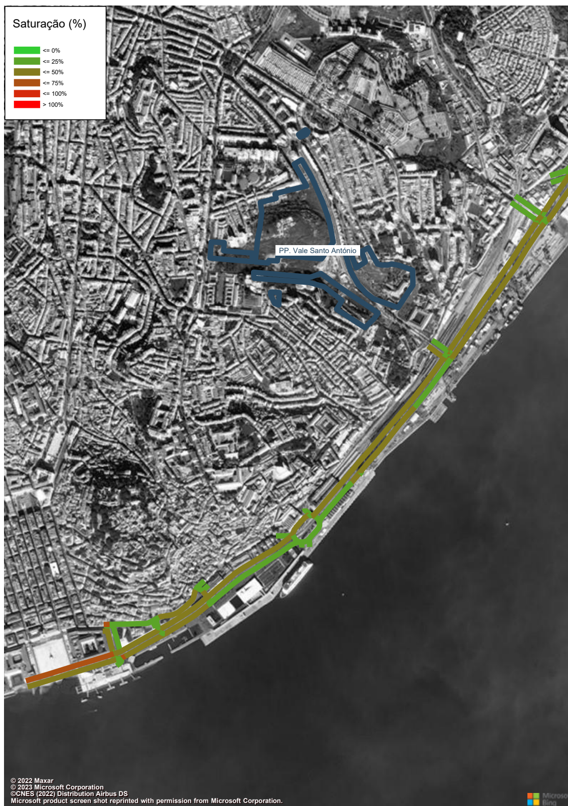
Figura 234 – Grau de Saturação (macro modelo de tráfego em PTV Visum, HPM-DU, Cenário RM2, Troço 1 a 4) (%).
