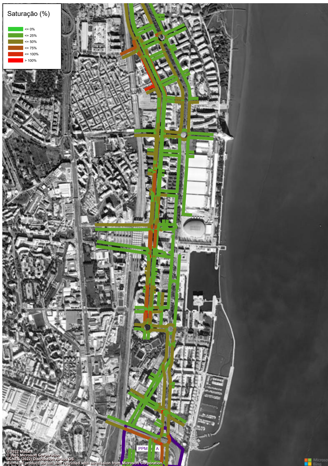
Figura 196 – Grau de Saturação (macro modelo de tráfego em PTV Visum, HPM-DU, Cenário FR, Troço 7 a 10) (%).
