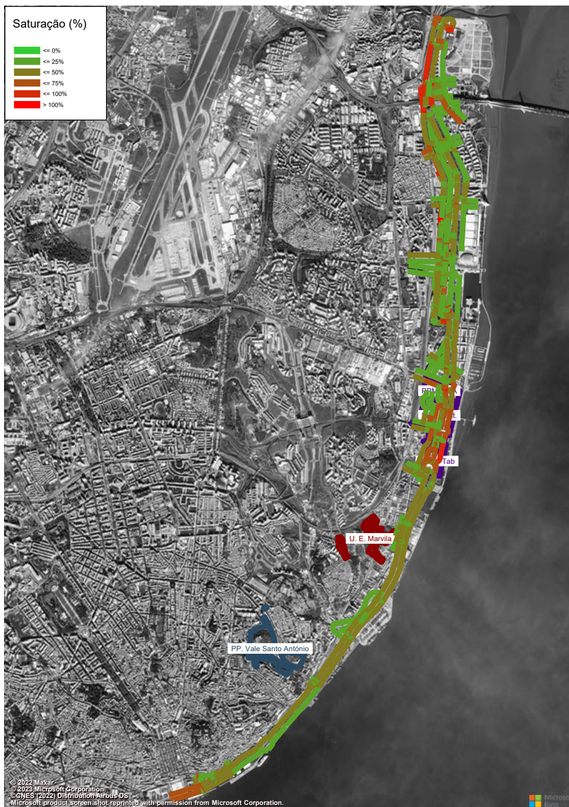
Figura 169 – Grau de Saturação (macro modelo de tráfego em PTV Visum, HPM-DU, Cenário F3) (%).
