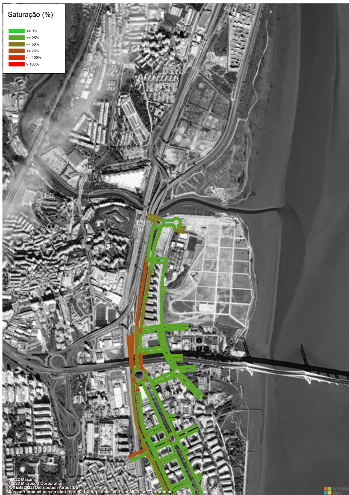
Figura 262 – Grau de Saturação (macro modelo de tráfego em PTV Visum, HPT-DU, Cenário RM3, Troço 11 a 12) (%).
