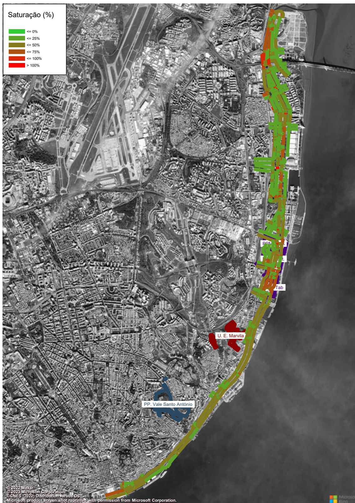
Figura 232 – Grau de Saturação (macro modelo de tráfego em PTV Visum, HPM-DU, Cenário RM2) (%).
