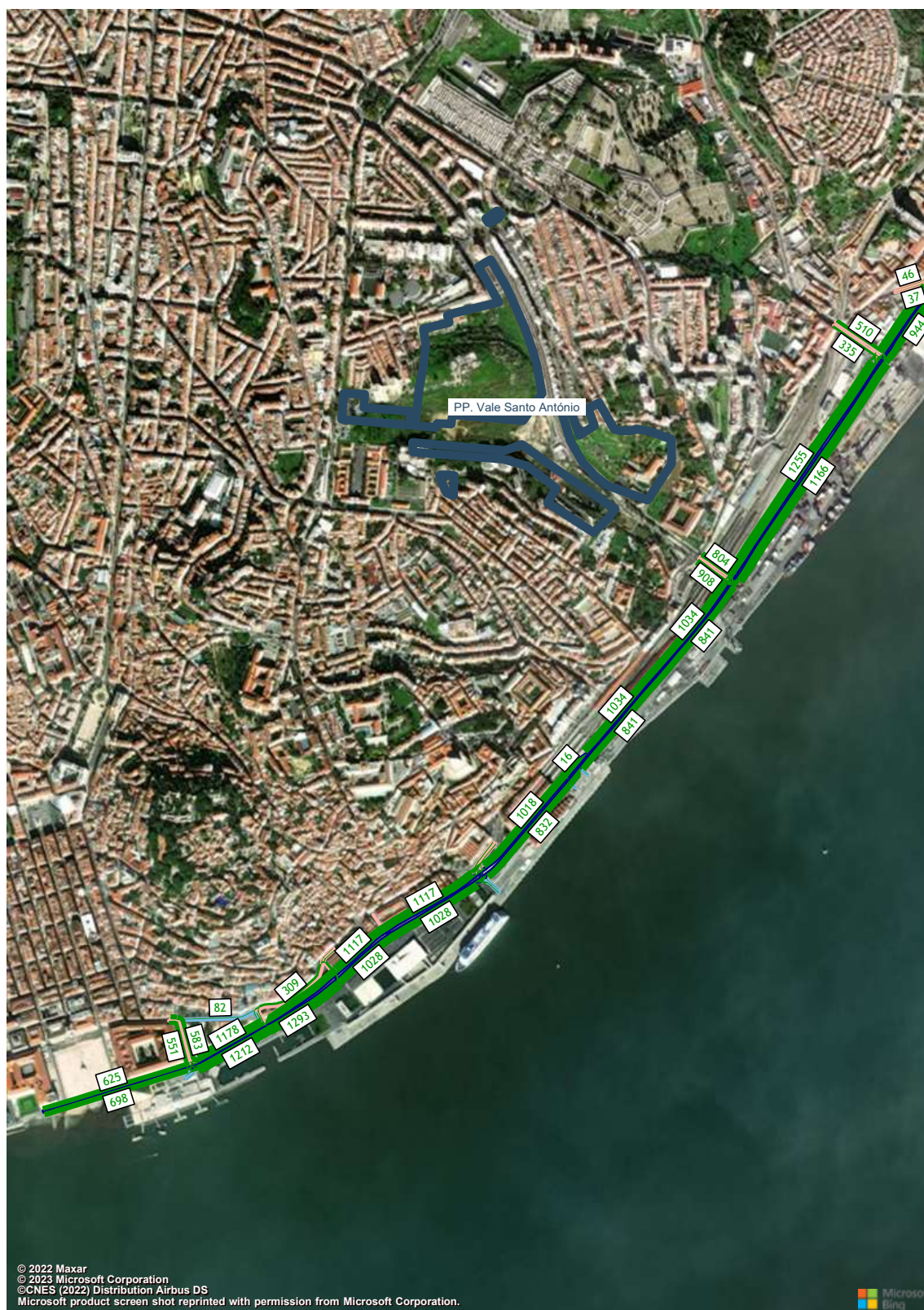
Figura 99 – Volumes de tráfego (macro modelo de tráfego em PTV Visum, HPT-DU, Cenário F0, Troço 1 a 4) (uvle/hora).
