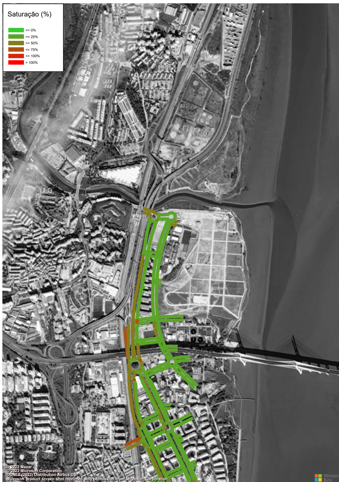
Figura 94 – Grau de Saturação (macro modelo de tráfego em PTV Visum, HPT-DU, Cenário A0, Troço 11 a 12) (%).
