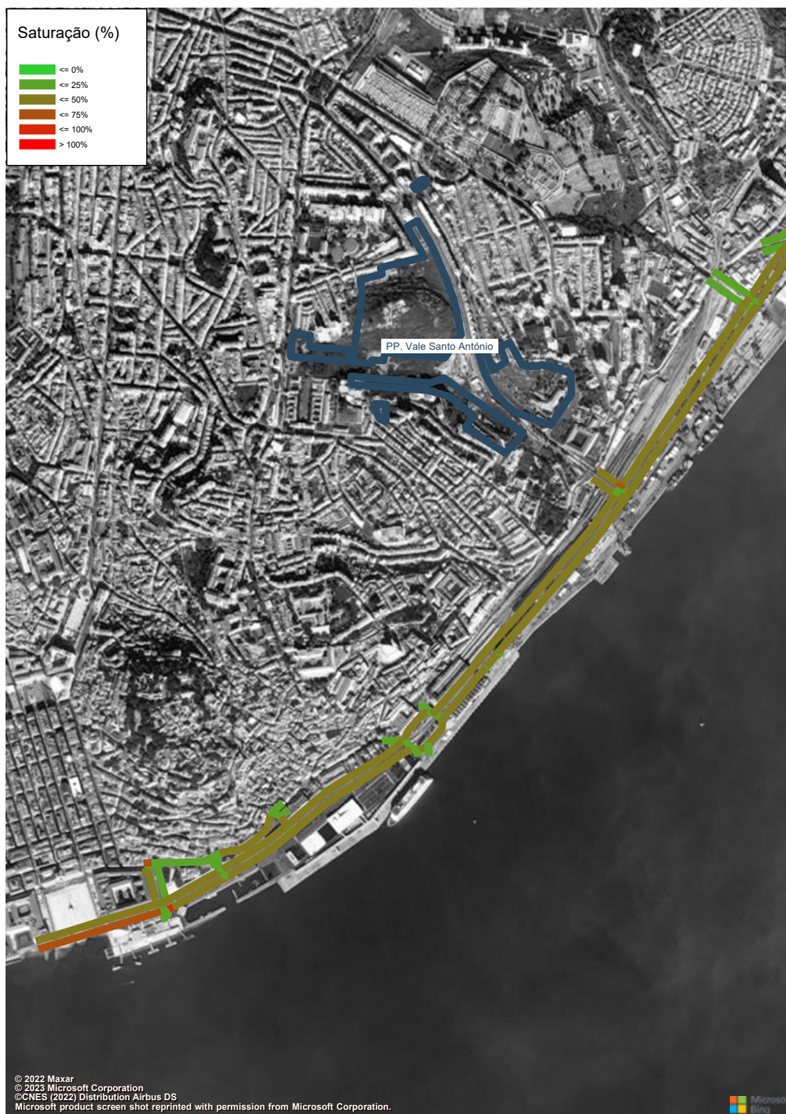
Figura 277 – Grau de Saturação (macro modelo de tráfego em PTV Visum, HPT-DU, Cenário RMR, Troço 1 a 4) (%).
