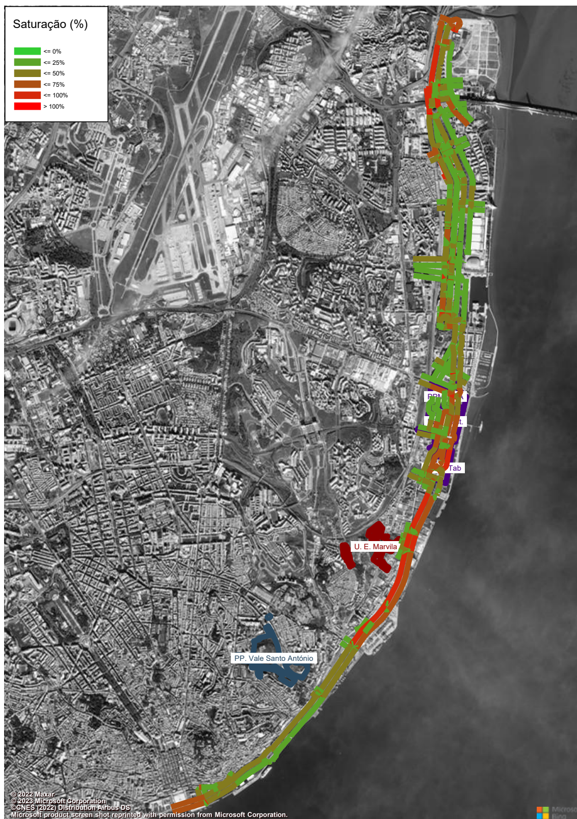
Figura 127 – Grau de Saturação (macro modelo de tráfego em PTV Visum, HPM-DU, Cenário F1) (%).
