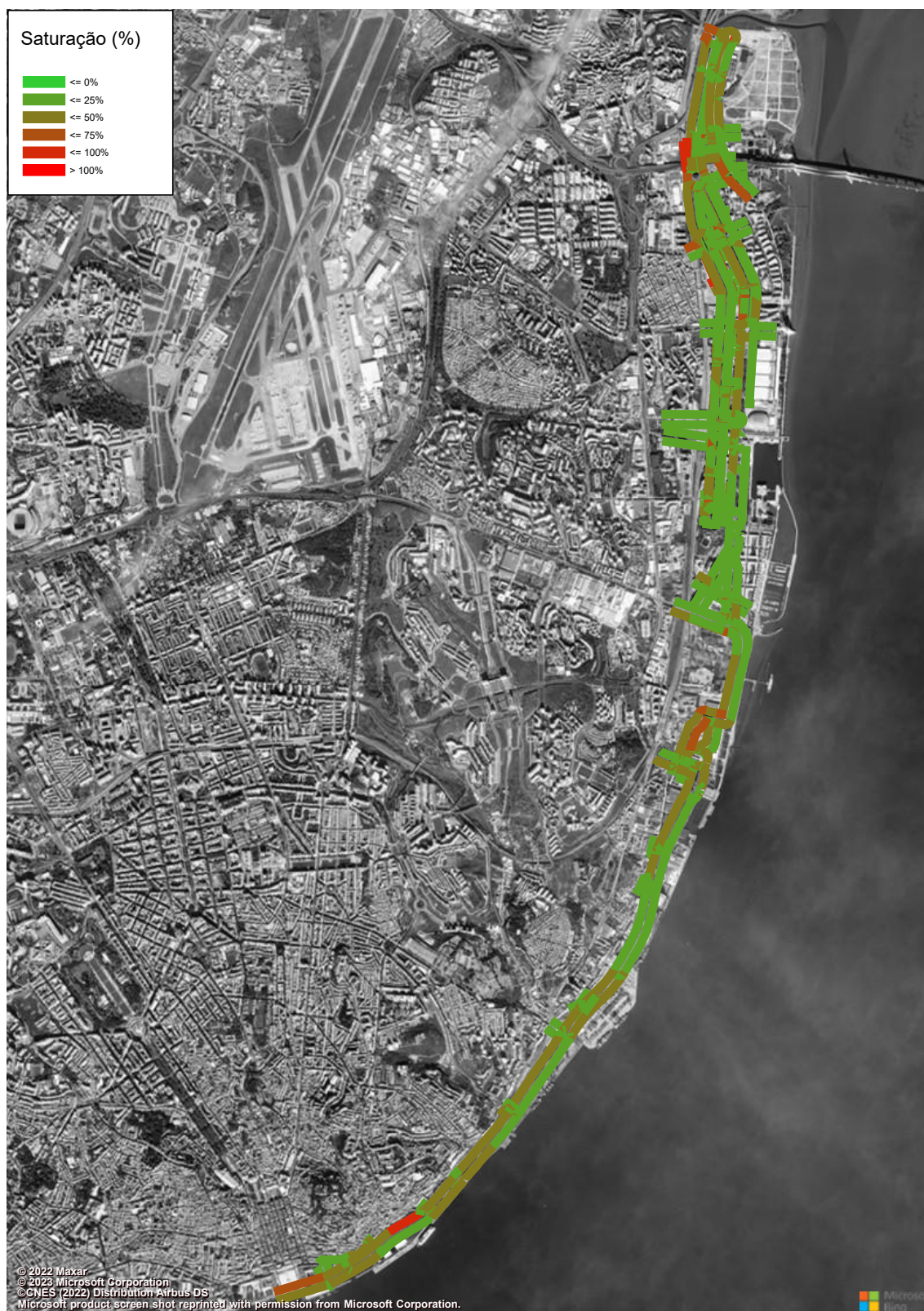
Figura 85 – Grau de Saturação (macro modelo de tráfego em PTV Visum, HPM-DU, Cenário A0) (%).
