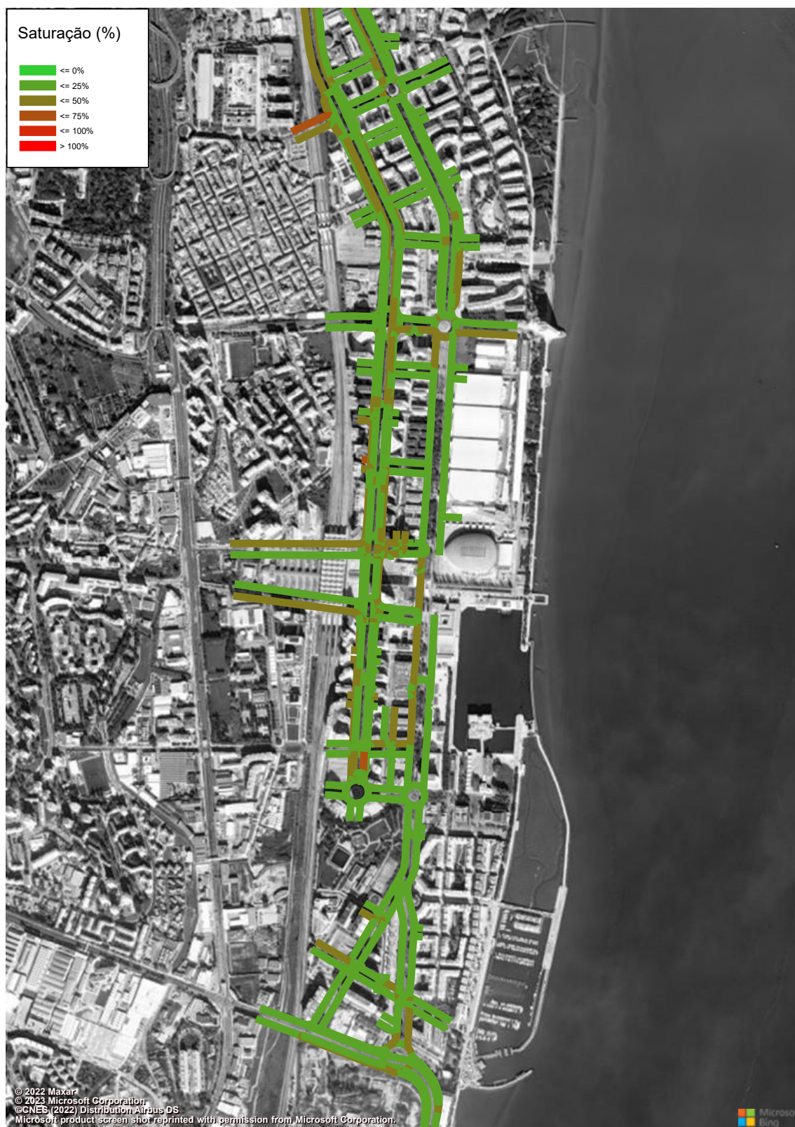
Figura 92 – Grau de Saturação (macro modelo de tráfego em PTV Visum, HPT-DU, Cenário A0, Troço 7 a 10) (%).
