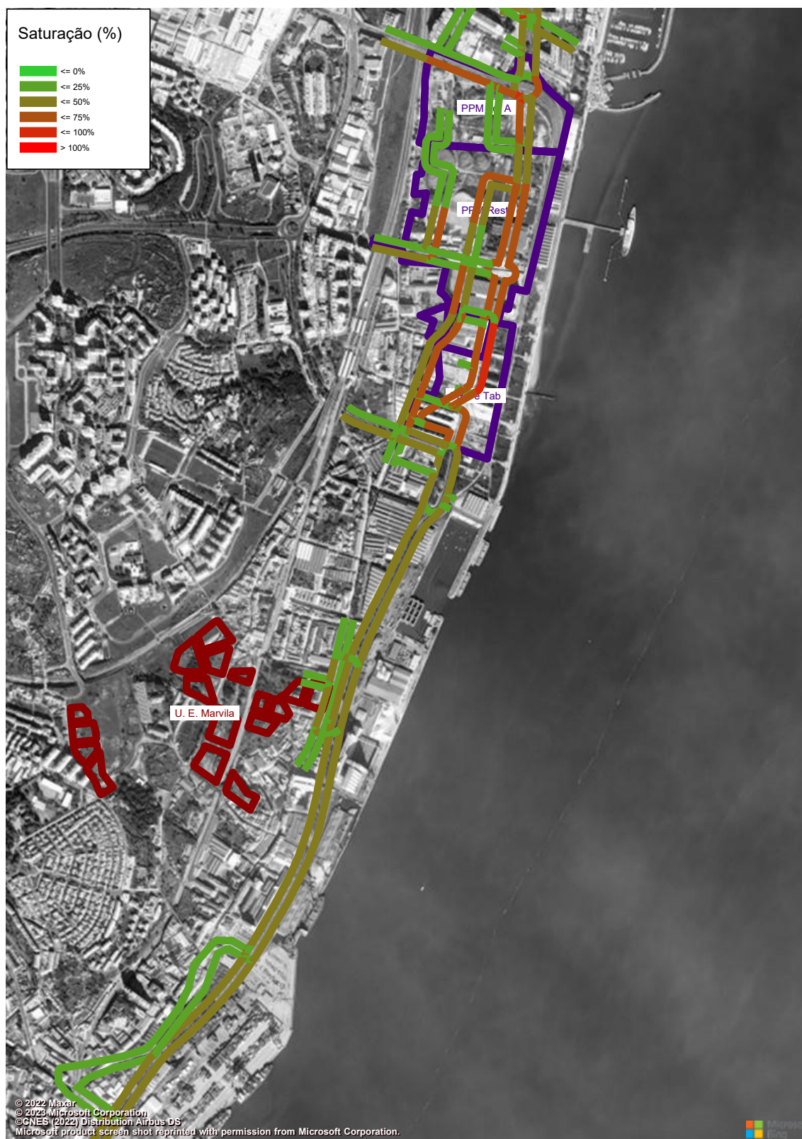
Figura 173 – Grau de Saturação (macro modelo de tráfego em PTV Visum, HPM-DU, Cenário F3, Troço 5 a 6) (%).
