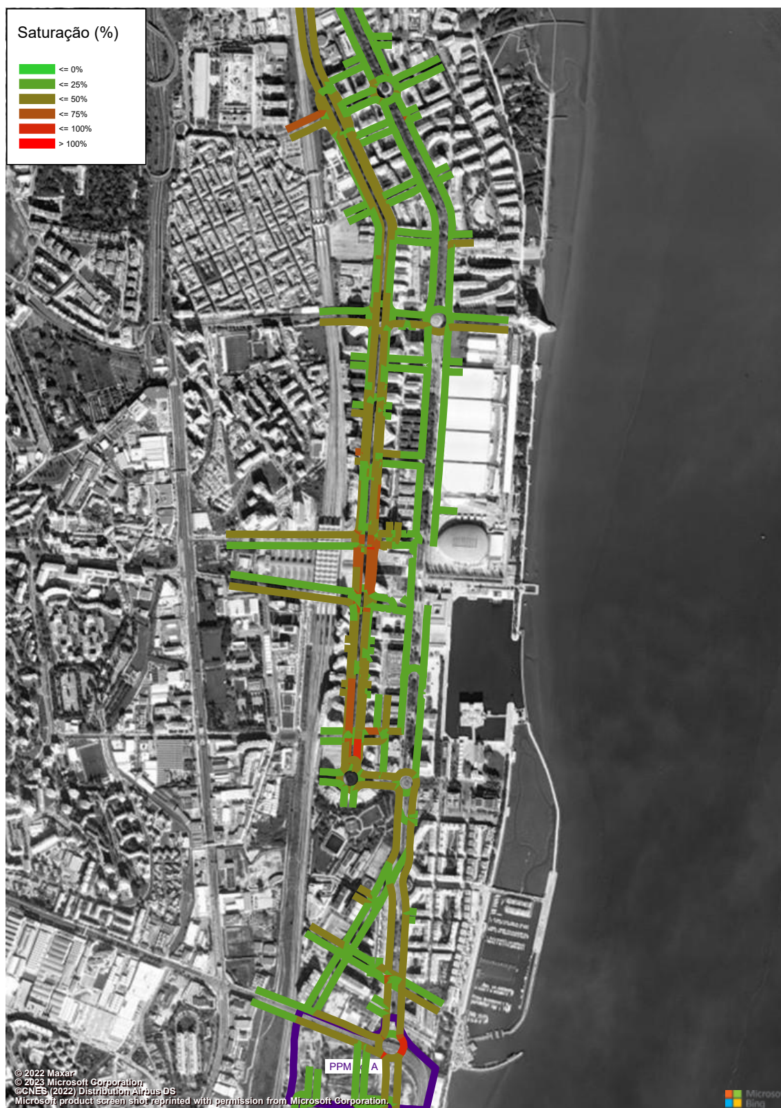
Figura 197 – Grau de Saturação (macro modelo de tráfego em PTV Visum, HPT-DU, Cenário FR, Troço 7 a 10) (%).
