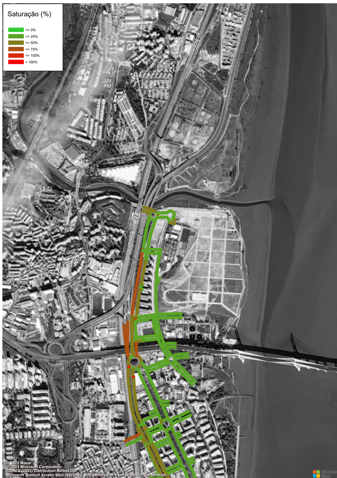
Figura 283 – Grau de Saturação (macro modelo de tráfego em PTV Visum, HPT-DU, Cenário RMR, Troço 11 a 12) (%).
