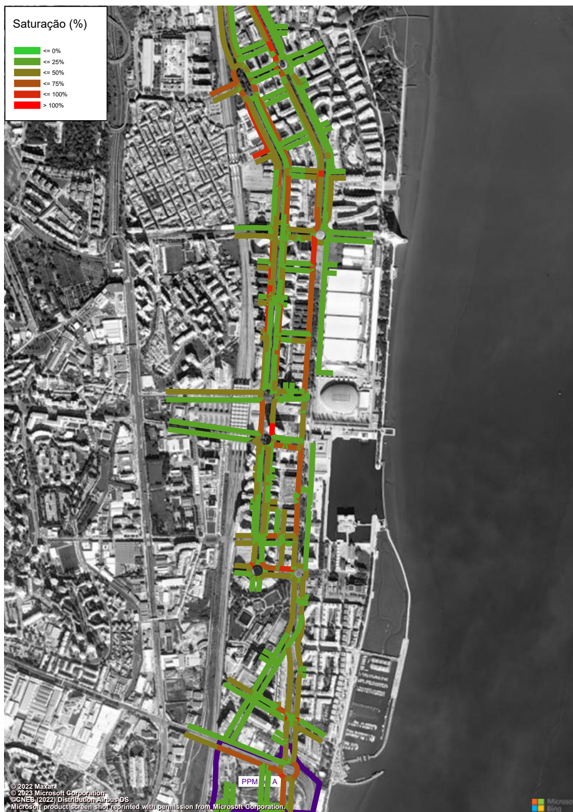
Figura 154 – Grau de Saturação (macro modelo de tráfego em PTV Visum, HPM-DU, Cenário F2, Troço 7 a 10) (%).
