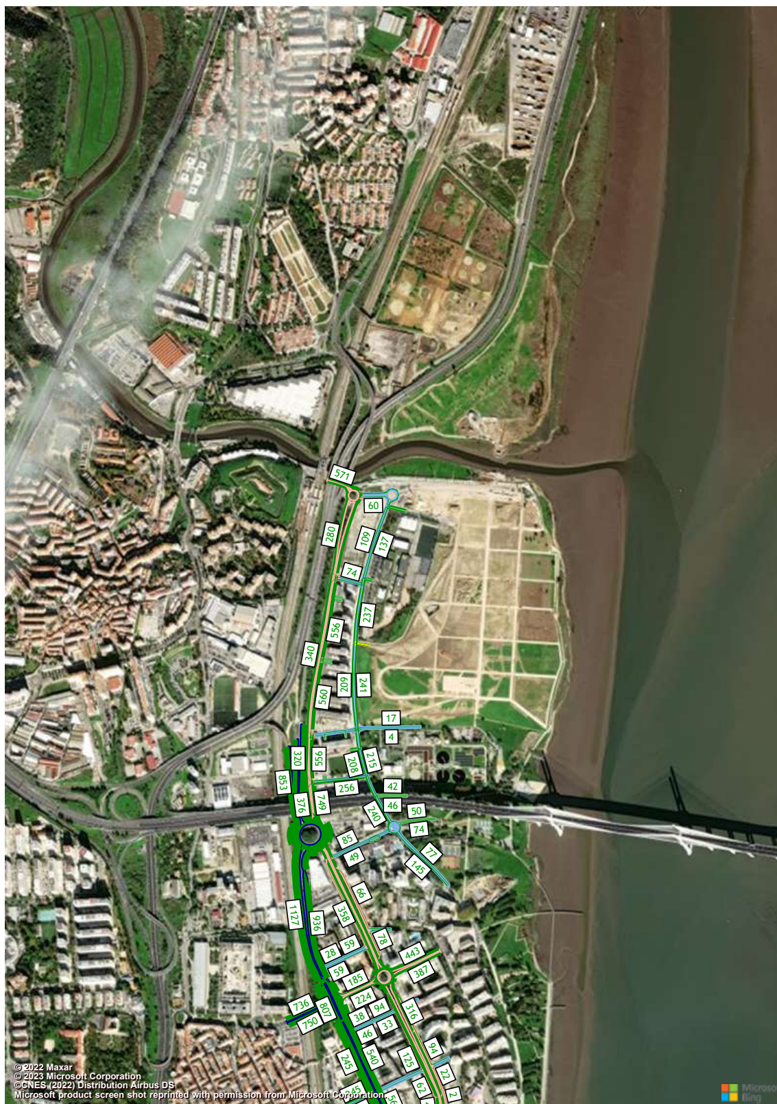
Figura 105 – Volumes de tráfego (macro modelo de tráfego em PTV Visum, HPT-DU, Cenário F0, Troço 11 a 12) (uvle/hora).
