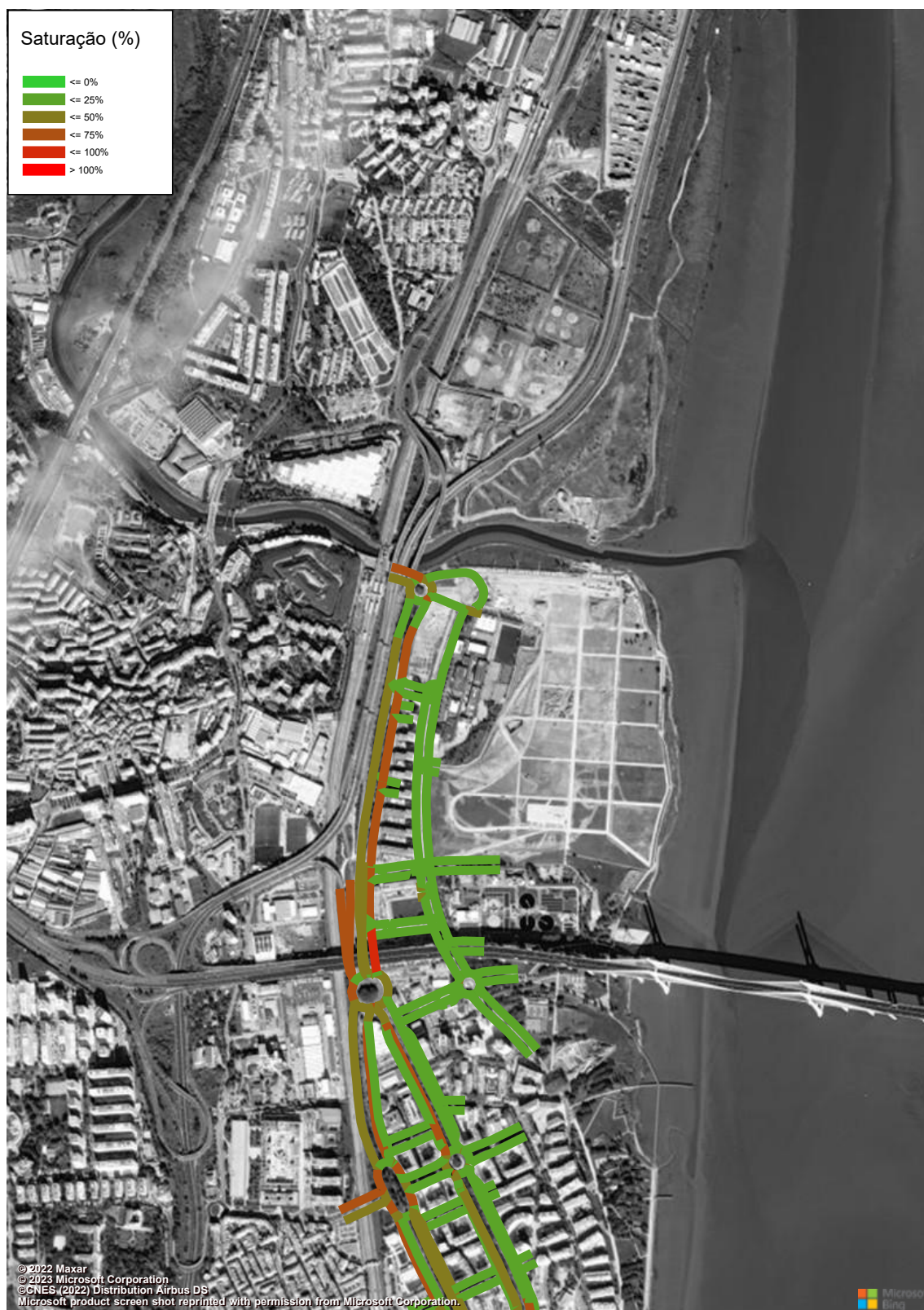
Figura 157 – Grau de Saturação (macro modelo de tráfego em PTV Visum, HPT-DU, Cenário F2, Troço 11 a 12) (%).
