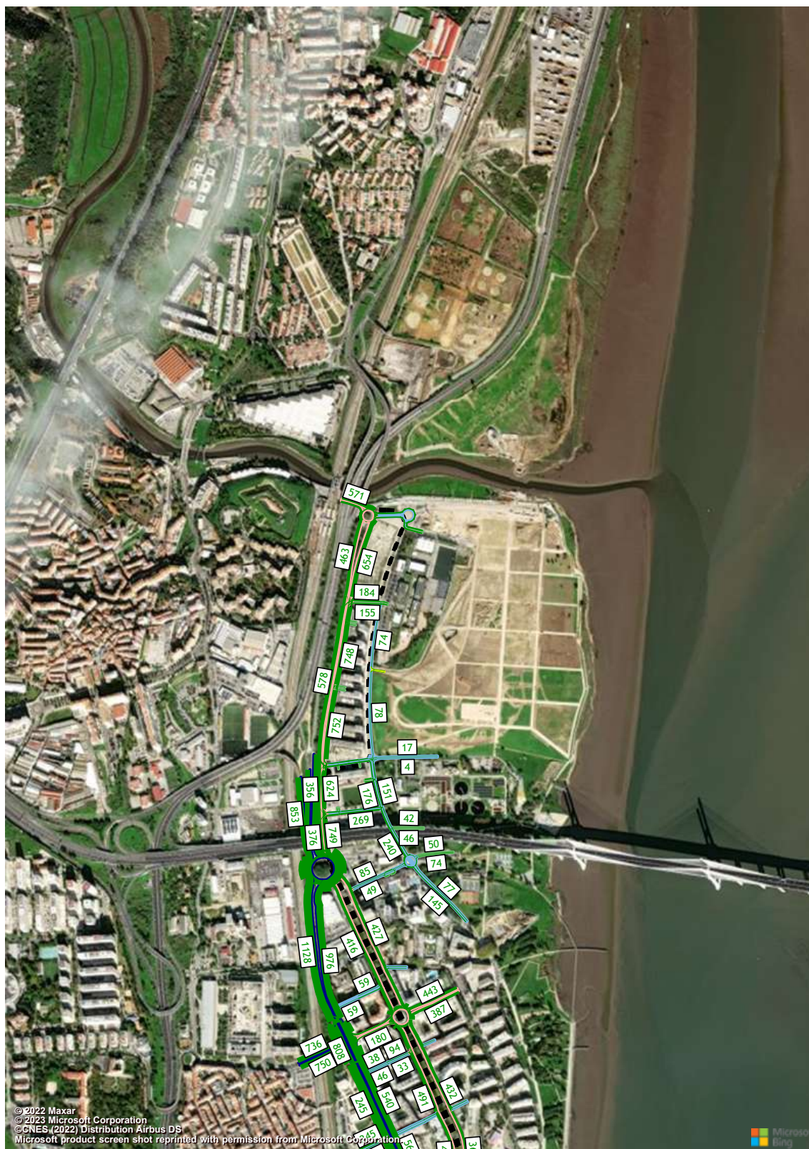
Figura 126 – Volumes de tráfego (macro modelo de tráfego em PTV Visum, HPT-DU, Cenário F1, Troço 11 a 12) (uvle/hora).
