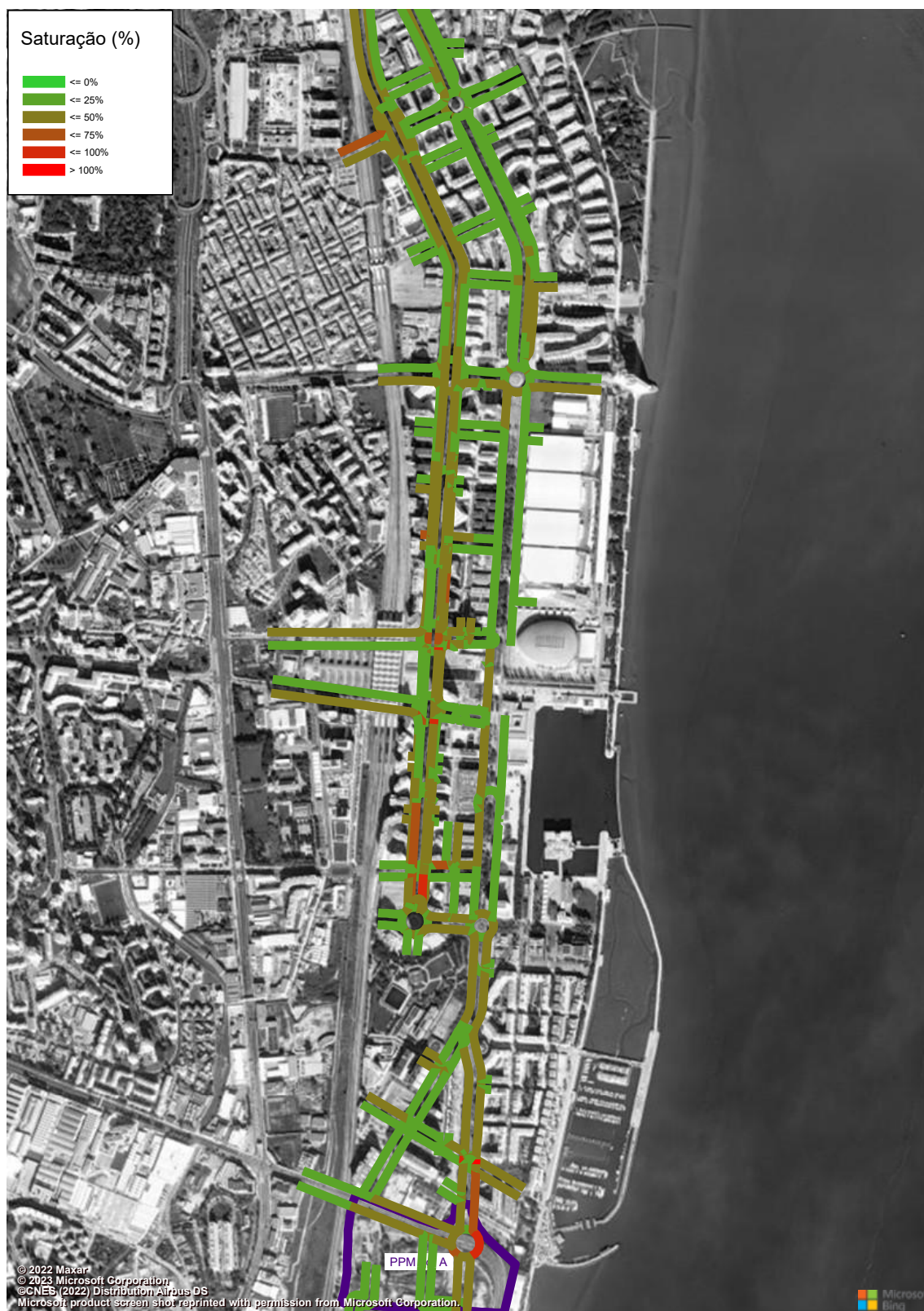
Figura 113 – Grau de Saturação (macro modelo de tráfego em PTV Visum, HPT-DU, Cenário F0, Troço 7 a 10) (%).
