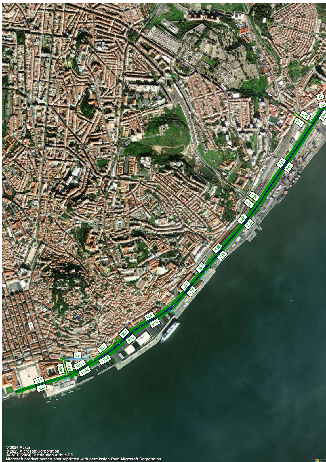
Figura 78 – Volumes de tráfego (macro modelo de tráfego em PTV Visum, HPT-DU, Cenário A0, Troço 1 a 4) (uvle/hora).
