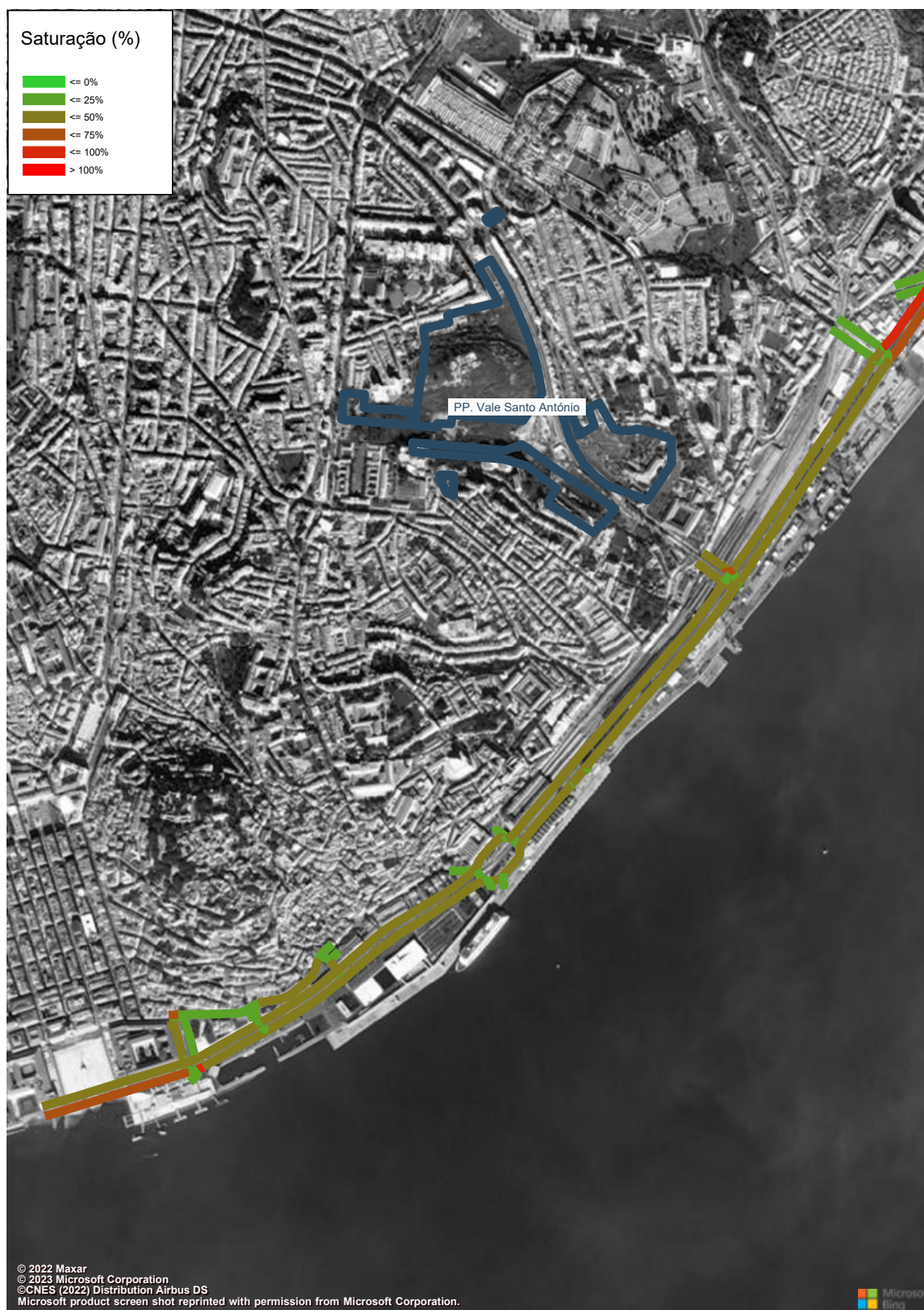
Figura 214 – Grau de Saturação (macro modelo de tráfego em PTV Visum, HPT-DU, Cenário RM1, Troço 1 a 4) (%).
