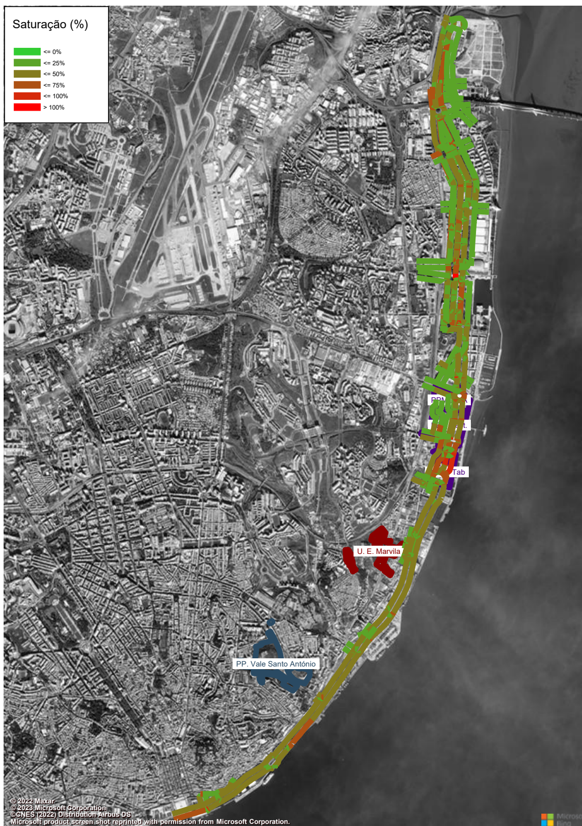
Figura 233 – Grau de Saturação (macro modelo de tráfego em PTV Visum, HPT-DU, Cenário RM2) (%).
