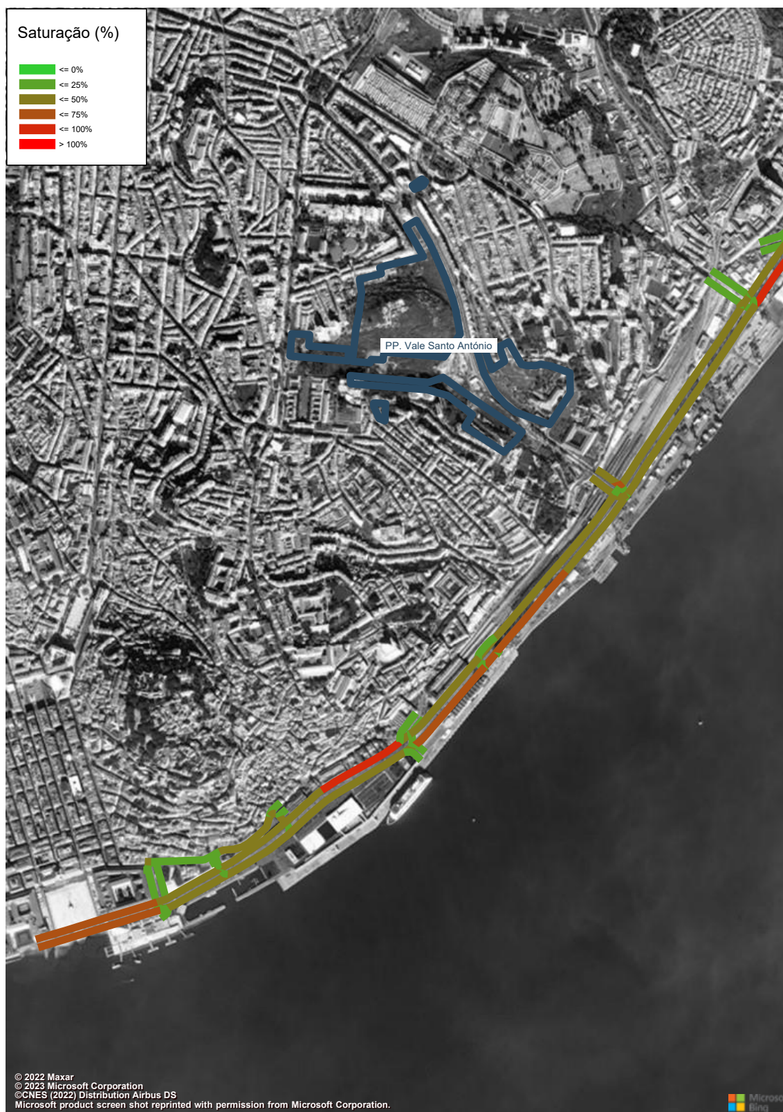
Figura 109 – Grau de Saturação (macro modelo de tráfego em PTV Visum, HPT-DU, Cenário F0, Troço 1 a 4) (%).
