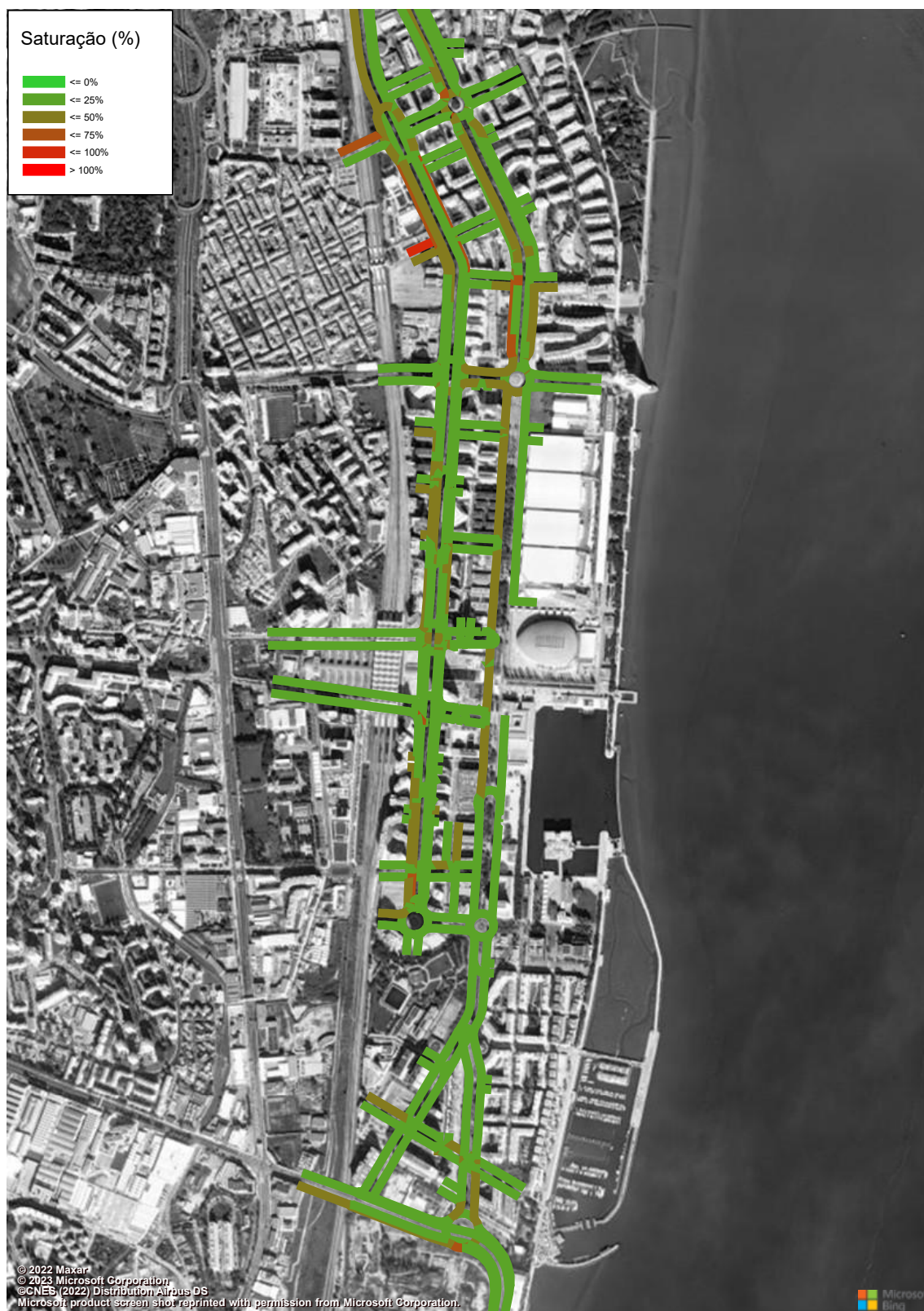
Figura 91 – Grau de Saturação (macro modelo de tráfego em PTV Visum, HPM-DU, Cenário A0, Troço 7 a 10) (%).
