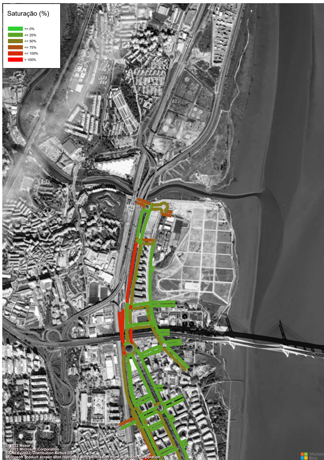
Figura 261 – Grau de Saturação (macro modelo de tráfego em PTV Visum, HPM-DU, Cenário RM3, Troço 11 a 12) (%).
