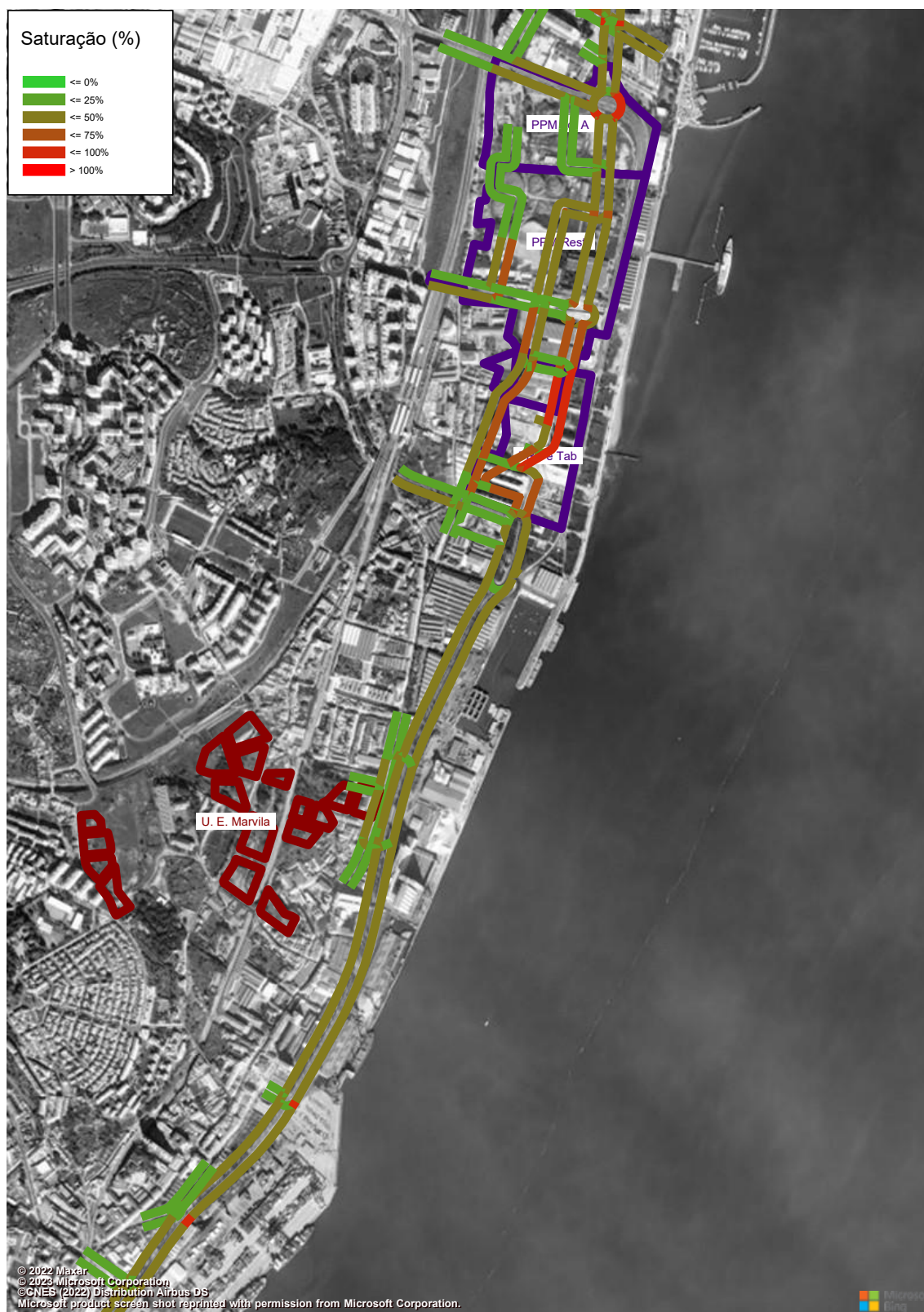
Figura 153 – Grau de Saturação (macro modelo de tráfego em PTV Visum, HPT-DU, Cenário F2, Troço 5 a 6) (%).
