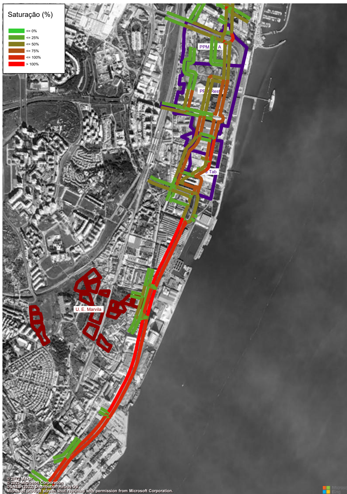
Figura 132 – Grau de Saturação (macro modelo de tráfego em PTV Visum, HPT-DU, Cenário F1, Troço 5 a 6) (%).
