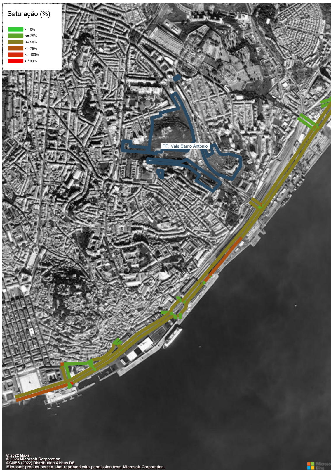
Figura 235 – Grau de Saturação (macro modelo de tráfego em PTV Visum, HPT-DU, Cenário RM2, Troço 1 a 4) (%).
