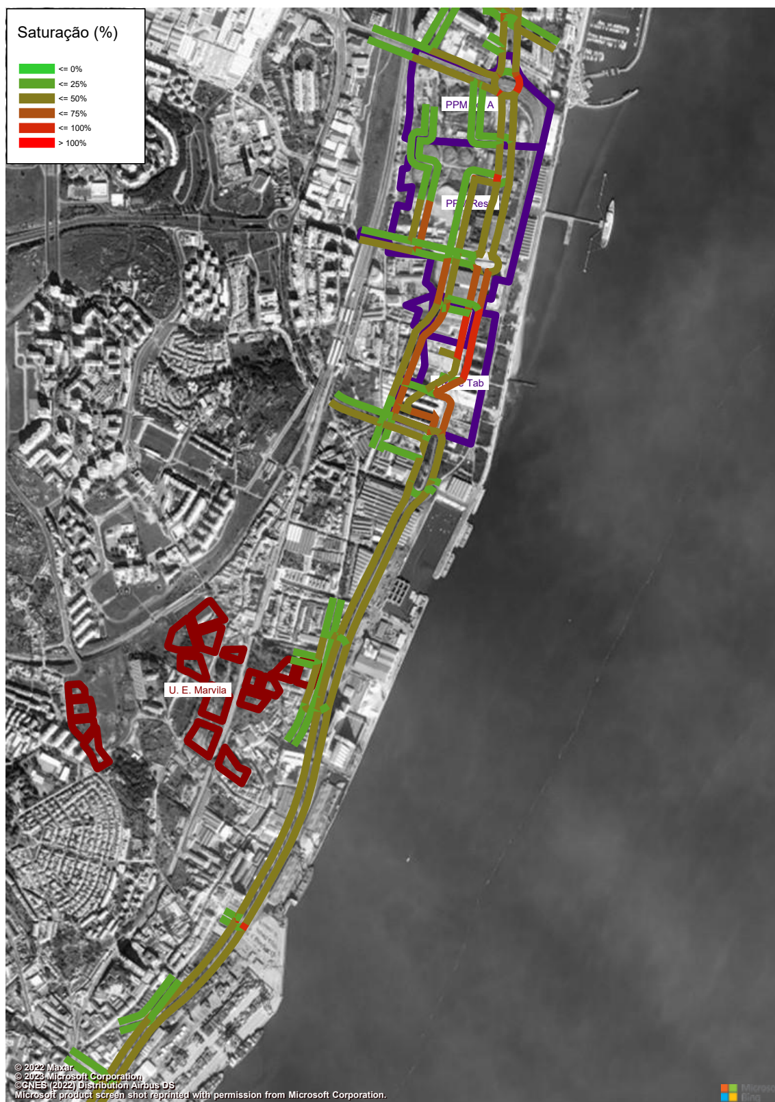
Figura 195 – Grau de Saturação (macro modelo de tráfego em PTV Visum, HPT-DU, Cenário FR, Troço 5 a 6) (%).
