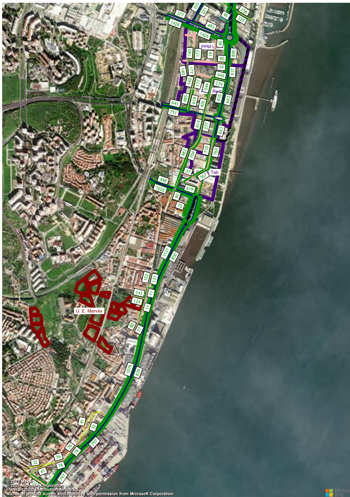
Figura 163 – Volumes de tráfego (macro modelo de tráfego em PTV Visum, HPM-DU, Cenário F3, Troço 5 a 6) (uvle/hora).
