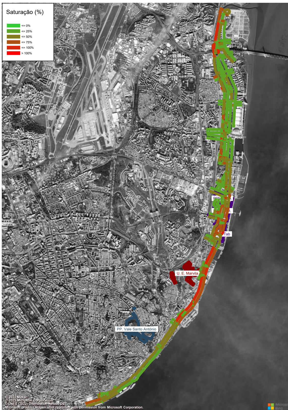
Figura 211 – Grau de Saturação (macro modelo de tráfego em PTV Visum, HPM-DU, Cenário RM1) (%).
