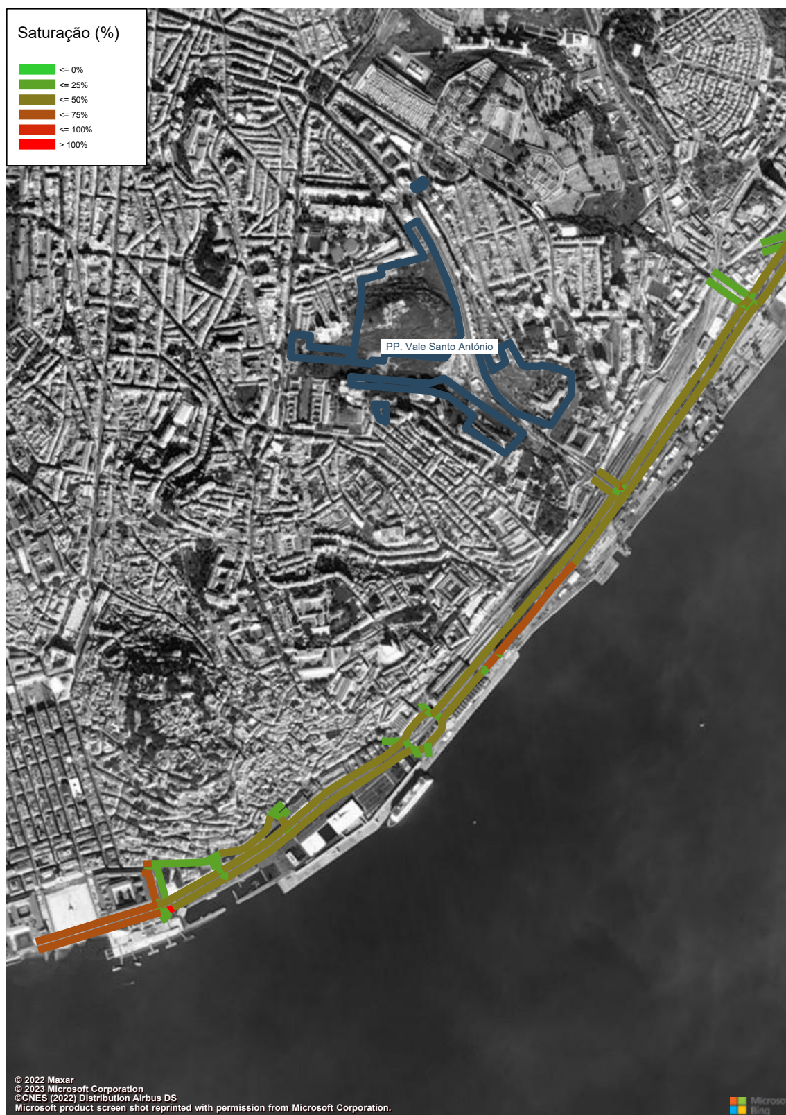
Figura 151 – Grau de Saturação (macro modelo de tráfego em PTV Visum, HPT-DU, Cenário F2, Troço 1 a 4) (%).
