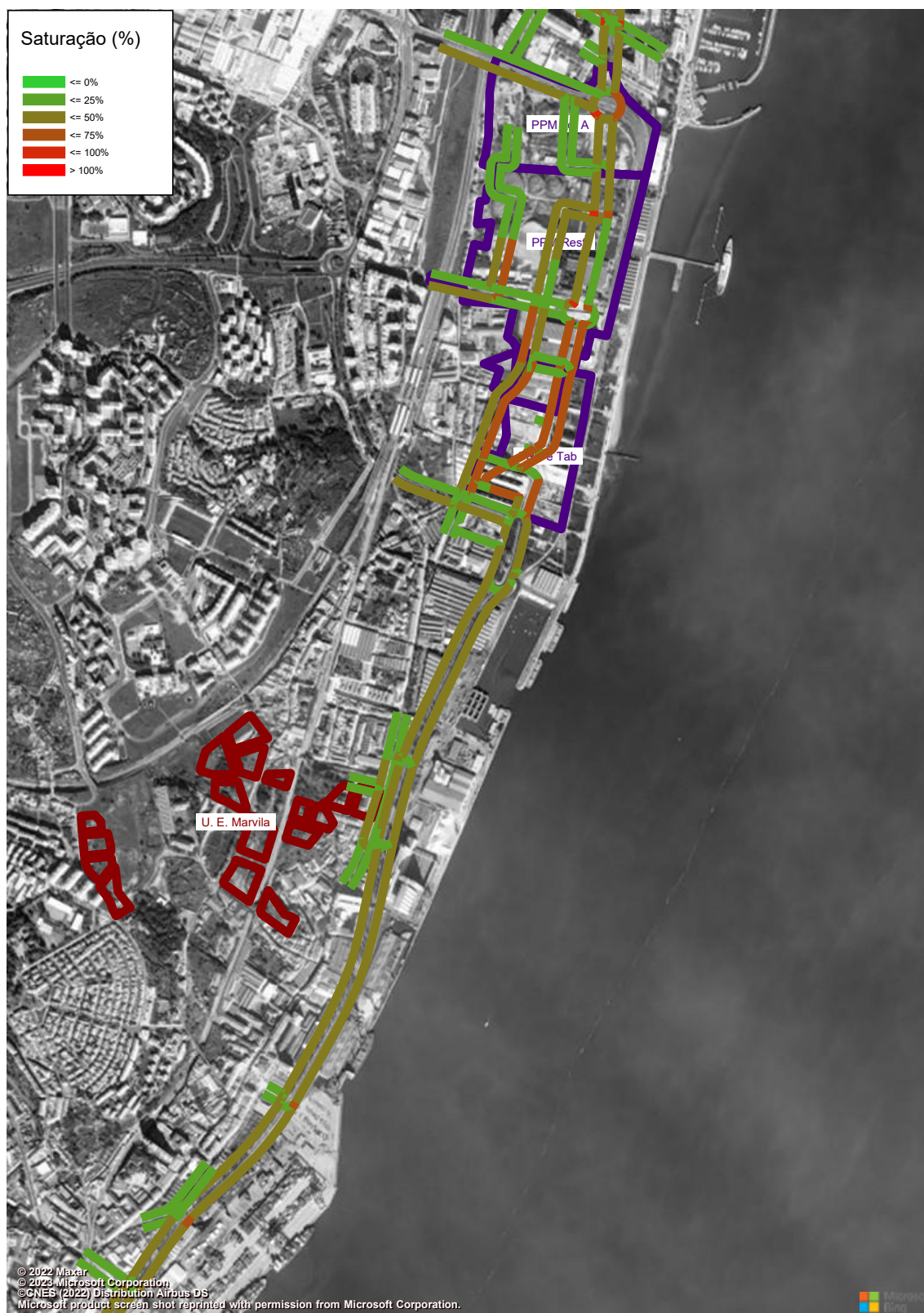
Figura 236 – Grau de Saturação (macro modelo de tráfego em PTV Visum, HPM-DU, Cenário RM2, Troço 5 a 6) (%).
