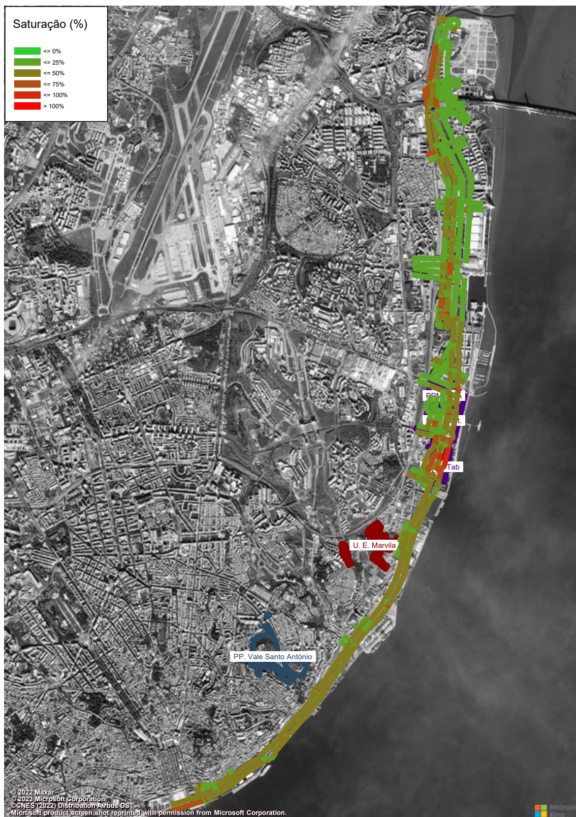
Figura 275 – Grau de Saturação (macro modelo de tráfego em PTV Visum, HPT-DU, Cenário RMR) (%).
