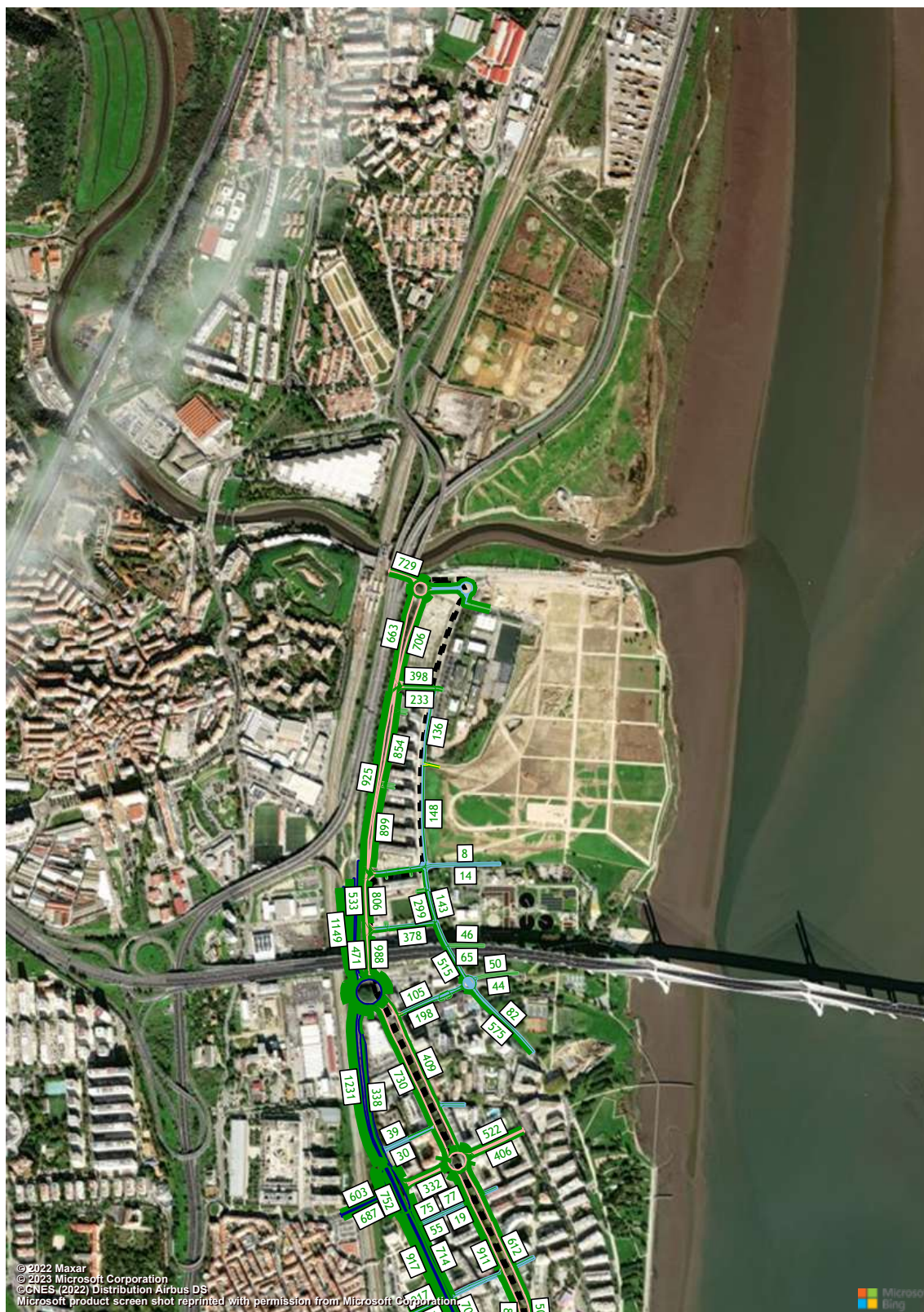
Figura 167 – Volumes de tráfego (macro modelo de tráfego em PTV Visum, HPM-DU, Cenário F3, Troço 11 a 12) (uvle/hora).
