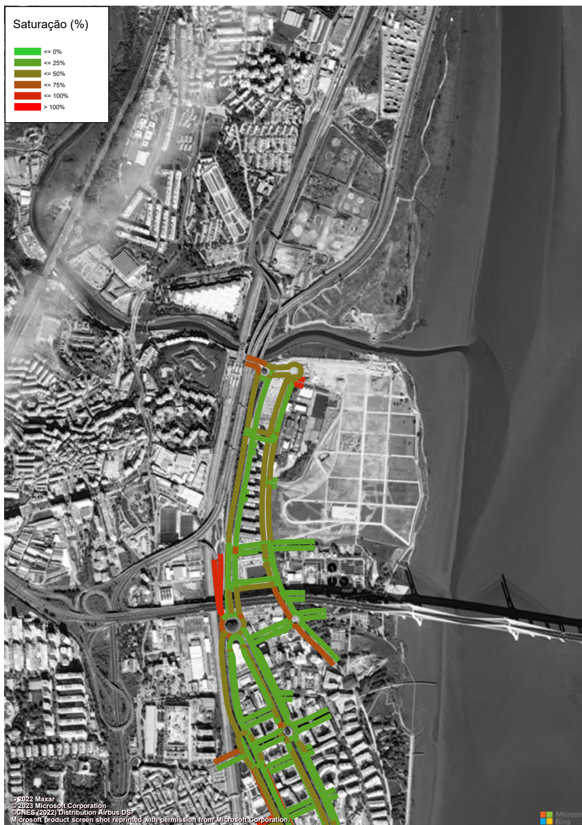
Figura 93 – Grau de Saturação (macro modelo de tráfego em PTV Visum, HPM-DU, Cenário A0, Troço 11 a 12) (%).
