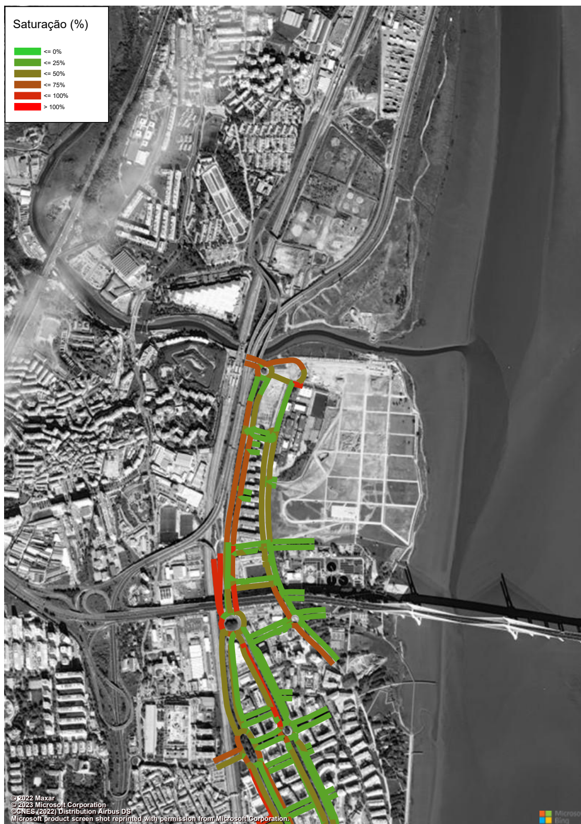
Figura 156 – Grau de Saturação (macro modelo de tráfego em PTV Visum, HPM-DU, Cenário F2, Troço 11 a 12) (%).
