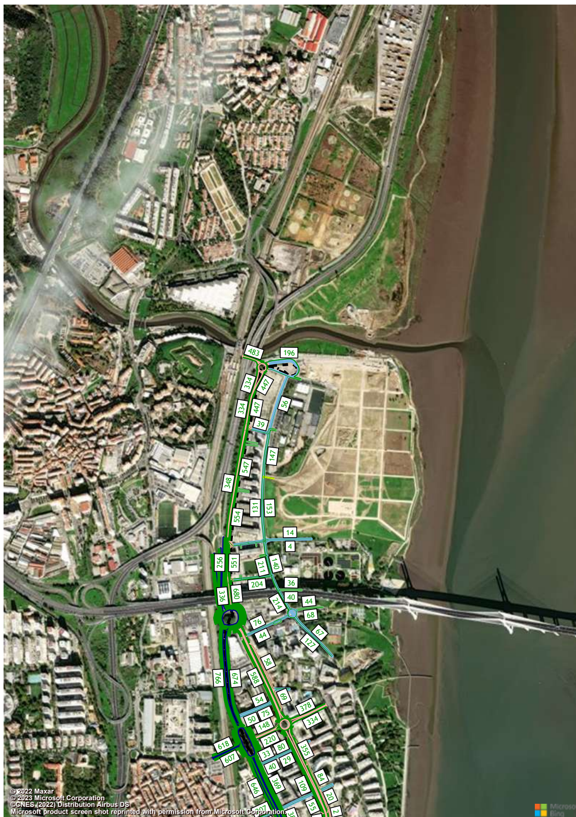
Figura 231 – Volumes de tráfego (macro modelo de tráfego em PTV Visum, HPT-DU, Cenário RM2, Troço 11 a 12) (uvle/hora).
