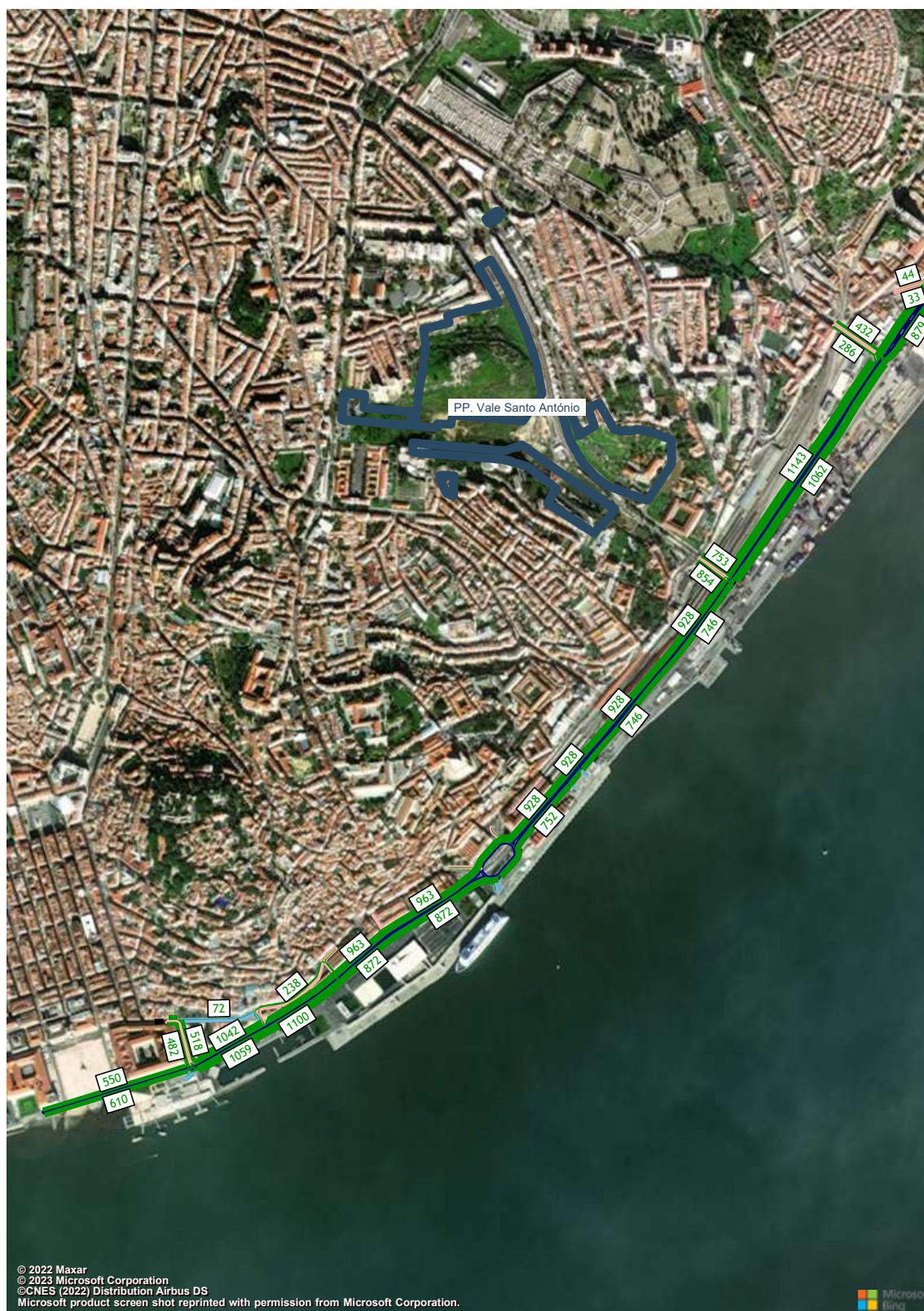
Figura 225 – Volumes de tráfego (macro modelo de tráfego em PTV Visum, HPT-DU, Cenário RM2, Troço 1 a 4) (uvle/hora).
