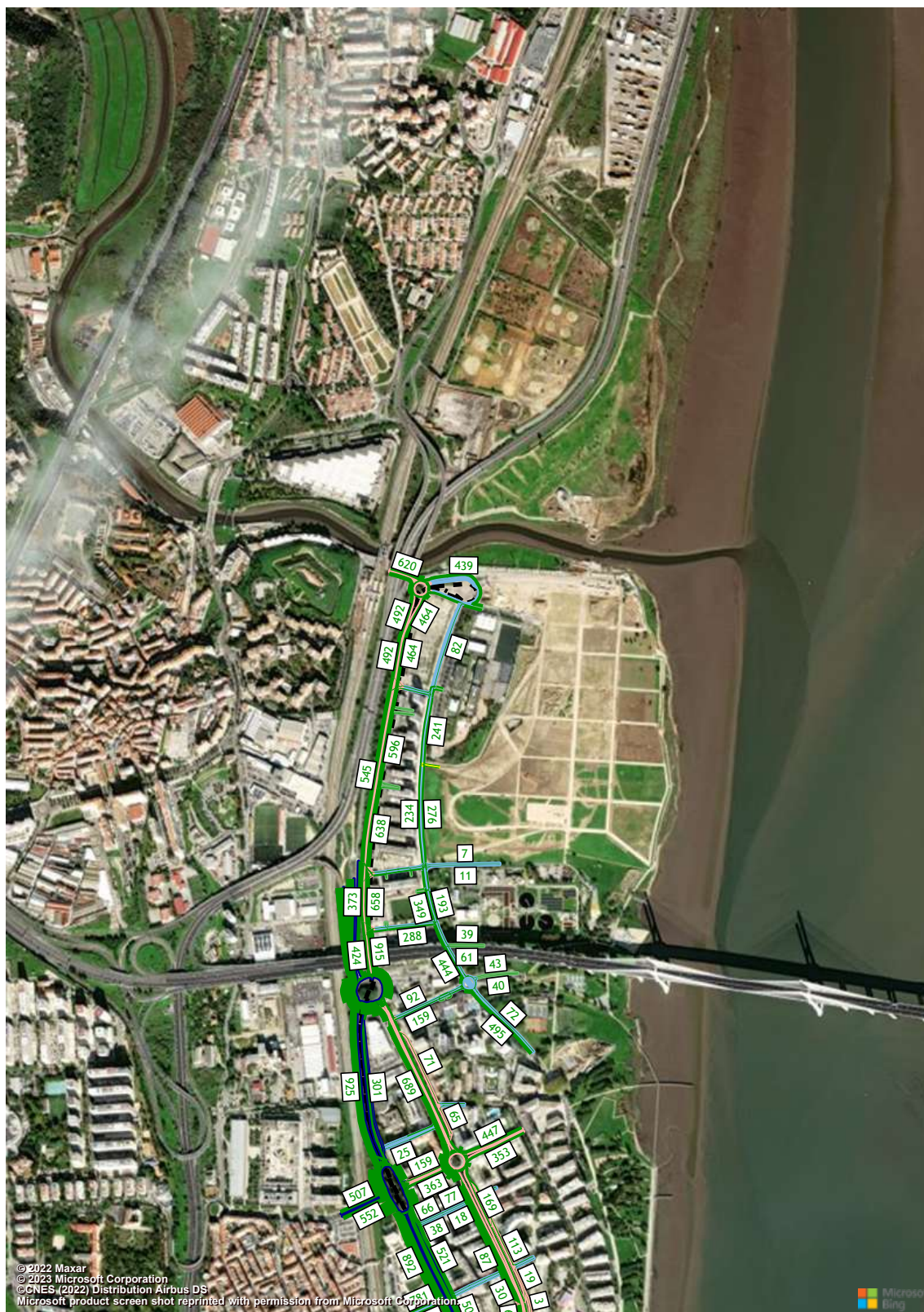
Figura 230 – Volumes de tráfego (macro modelo de tráfego em PTV Visum, HPM-DU, Cenário RM2, Troço 11 a 12) (uvle/hora).
