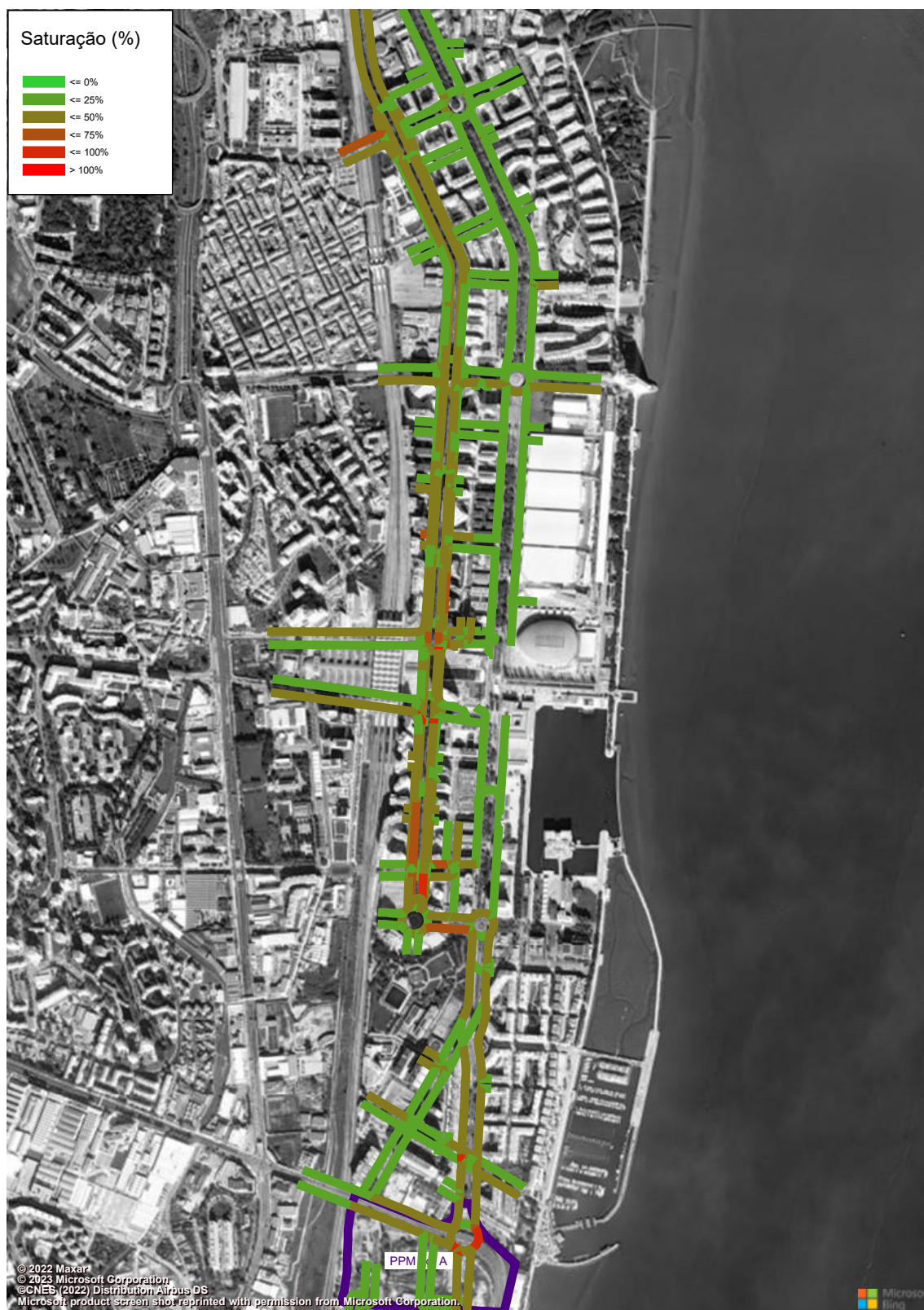
Figura 134 – Grau de Saturação (macro modelo de tráfego em PTV Visum, HPT-DU, Cenário F1, Troço 7 a 10) (%).
