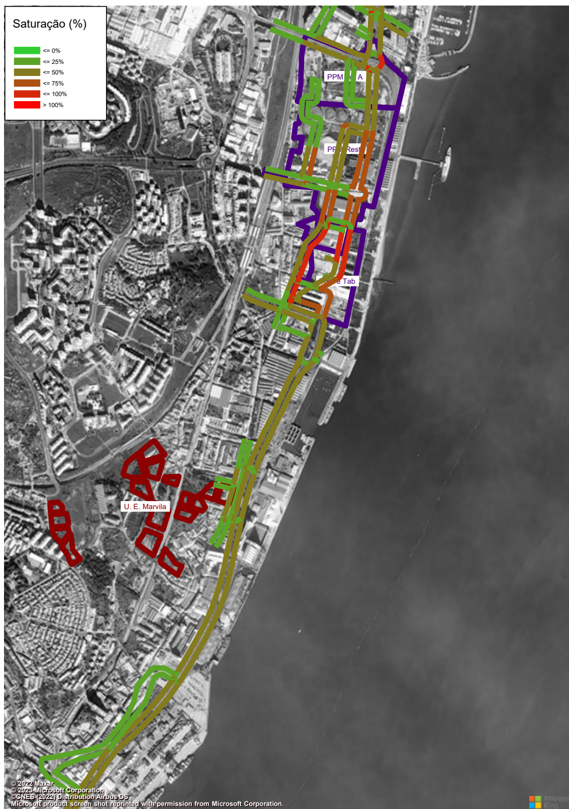
Figura 174 – Grau de Saturação (macro modelo de tráfego em PTV Visum, HPT-DU, Cenário F3, Troço 5 a 6) (%).
