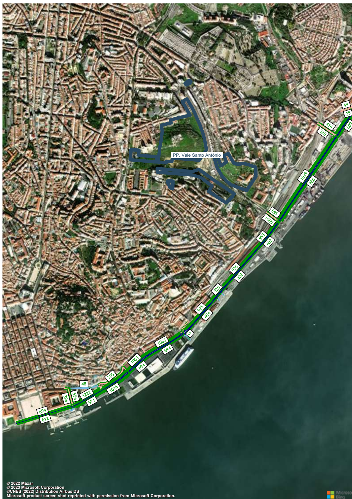
Figura 98 – Volumes de tráfego (macro modelo de tráfego em PTV Visum, HPM-DU, Cenário F0, Troço 1 a 4) (uvle/hora).
