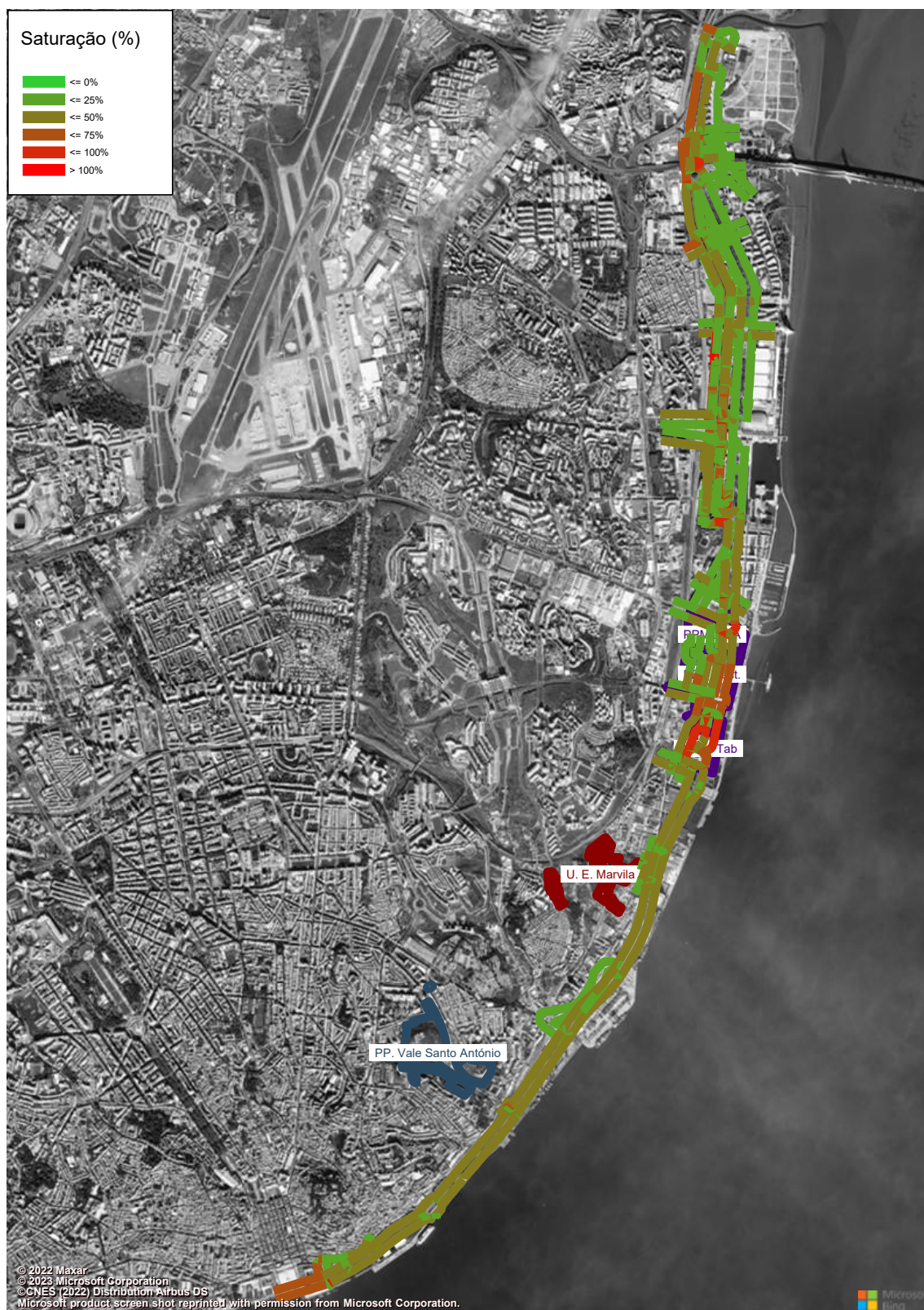
Figura 170 – Grau de Saturação (macro modelo de tráfego em PTV Visum, HPT-DU, Cenário F3) (%).
