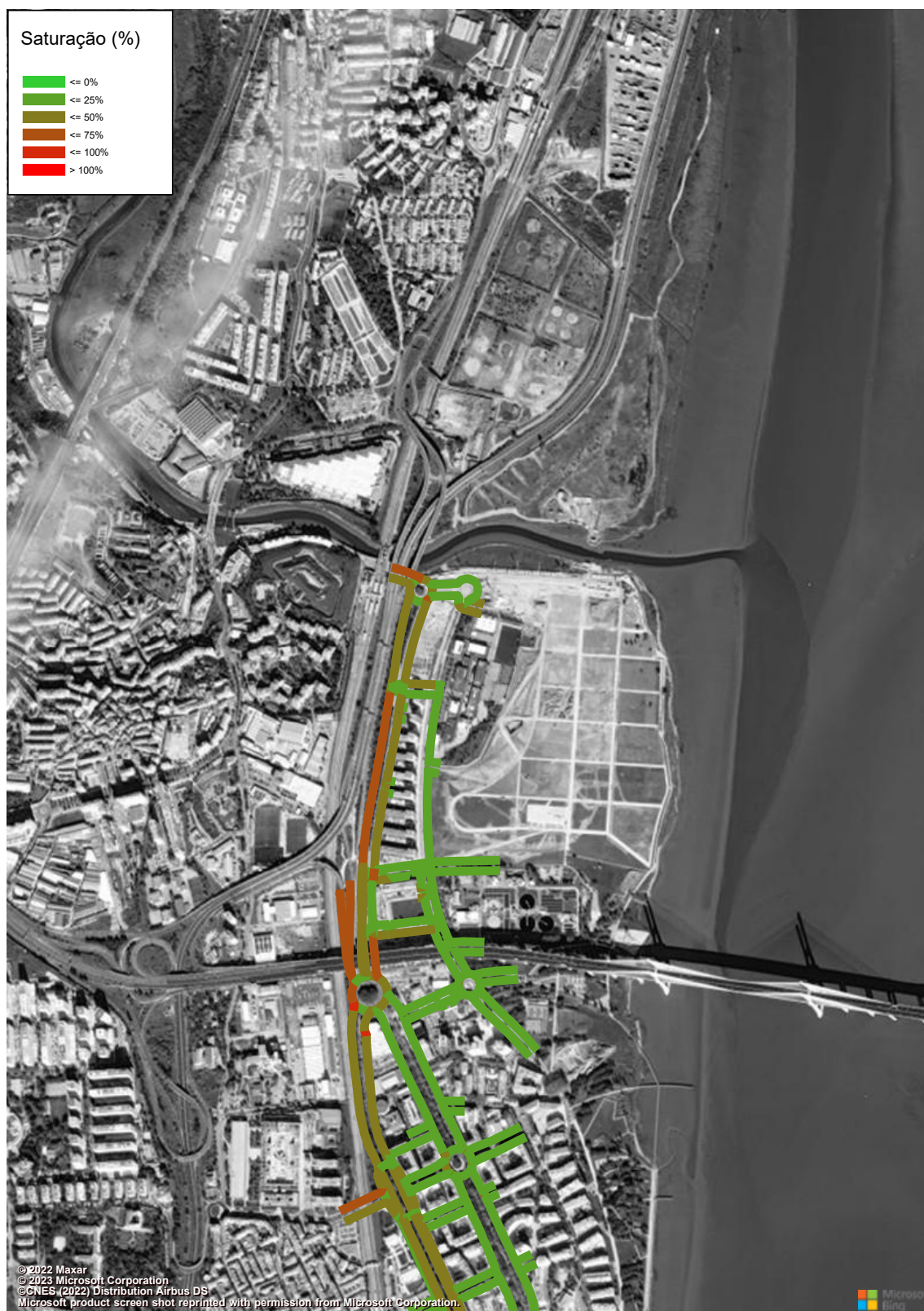
Figura 136 – Grau de Saturação (macro modelo de tráfego em PTV Visum, HPT-DU, Cenário F1, Troço 11 a 12) (%).
