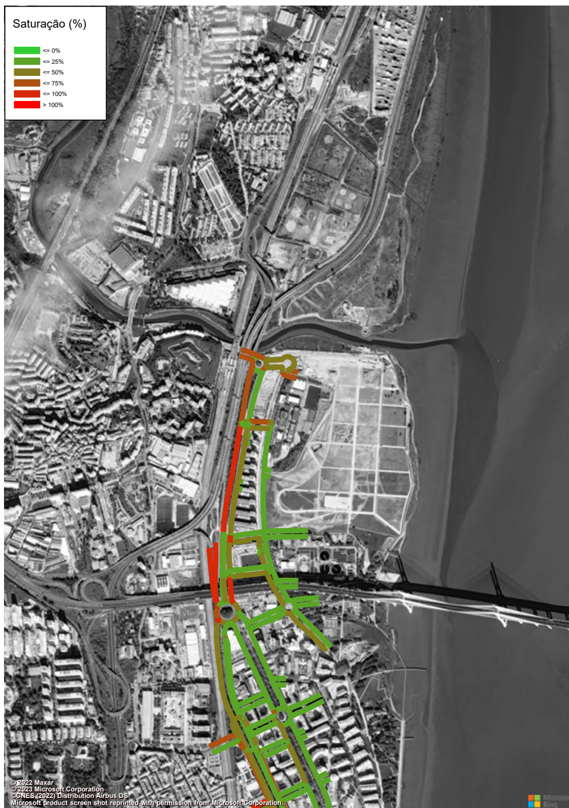
Figura 219 – Grau de Saturação (macro modelo de tráfego em PTV Visum, HPM-DU, Cenário RM1, Troço 11 a 12) (%).
