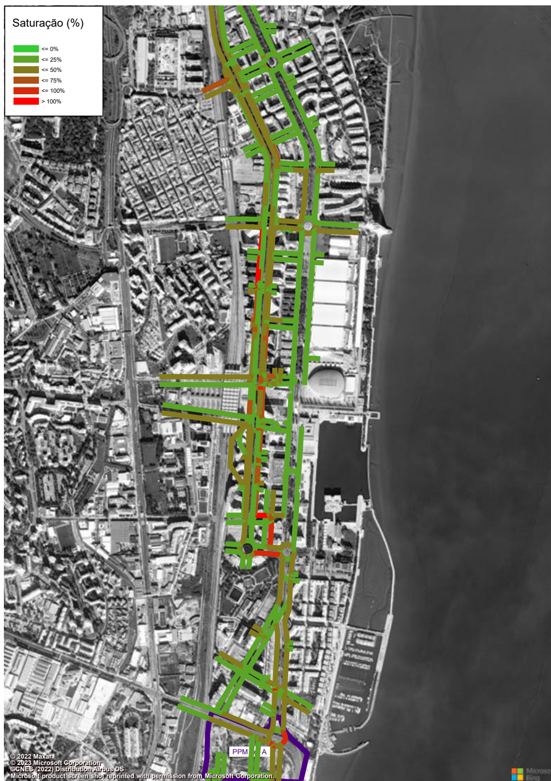
Figura 176 – Grau de Saturação (macro modelo de tráfego em PTV Visum, HPT-DU, Cenário F3, Troço 7 a 10) (%).
