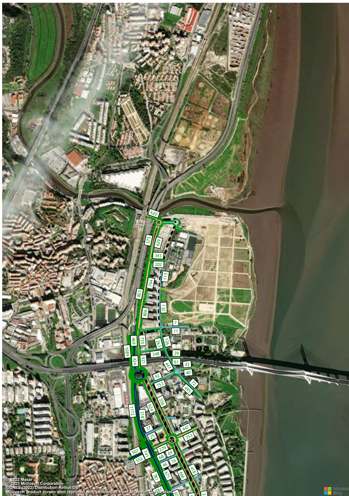
Figura 272 – Volumes de tráfego (macro modelo de tráfego em PTV Visum, HPM-DU, Cenário RMR, Troço 11 a 12) (uvle/hora).
