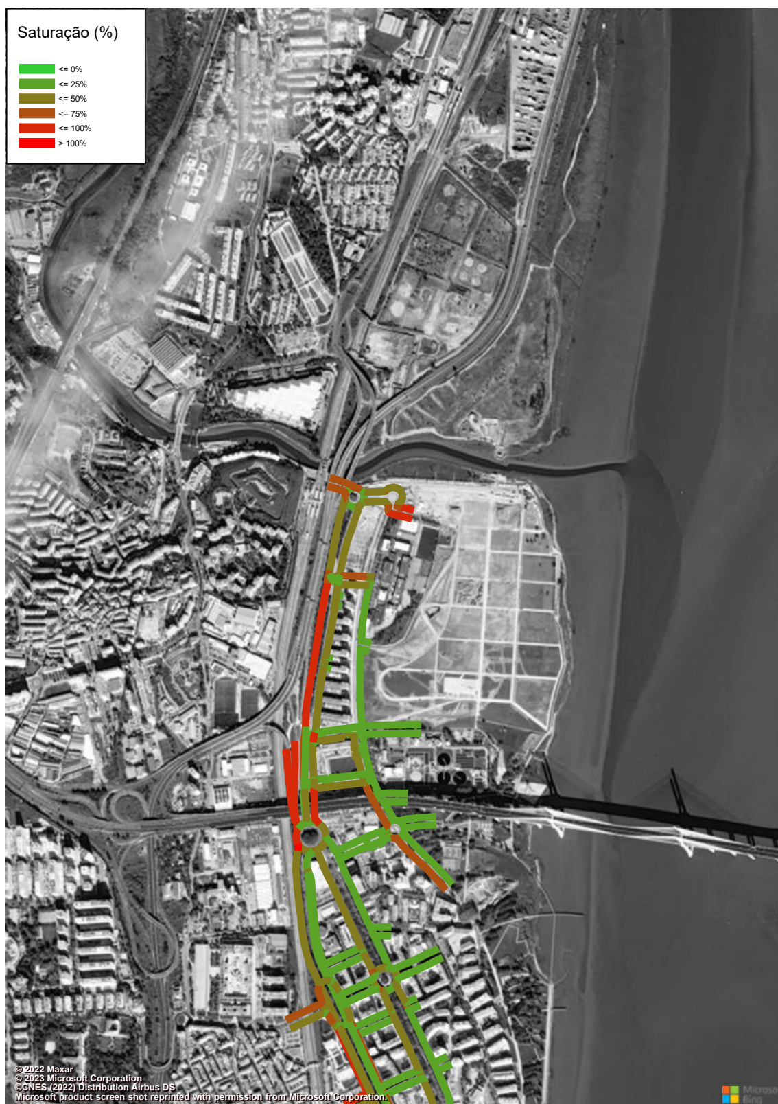
Figura 177 – Grau de Saturação (macro modelo de tráfego em PTV Visum, HPM-DU, Cenário F3, Troço 11 a 12) (%).
