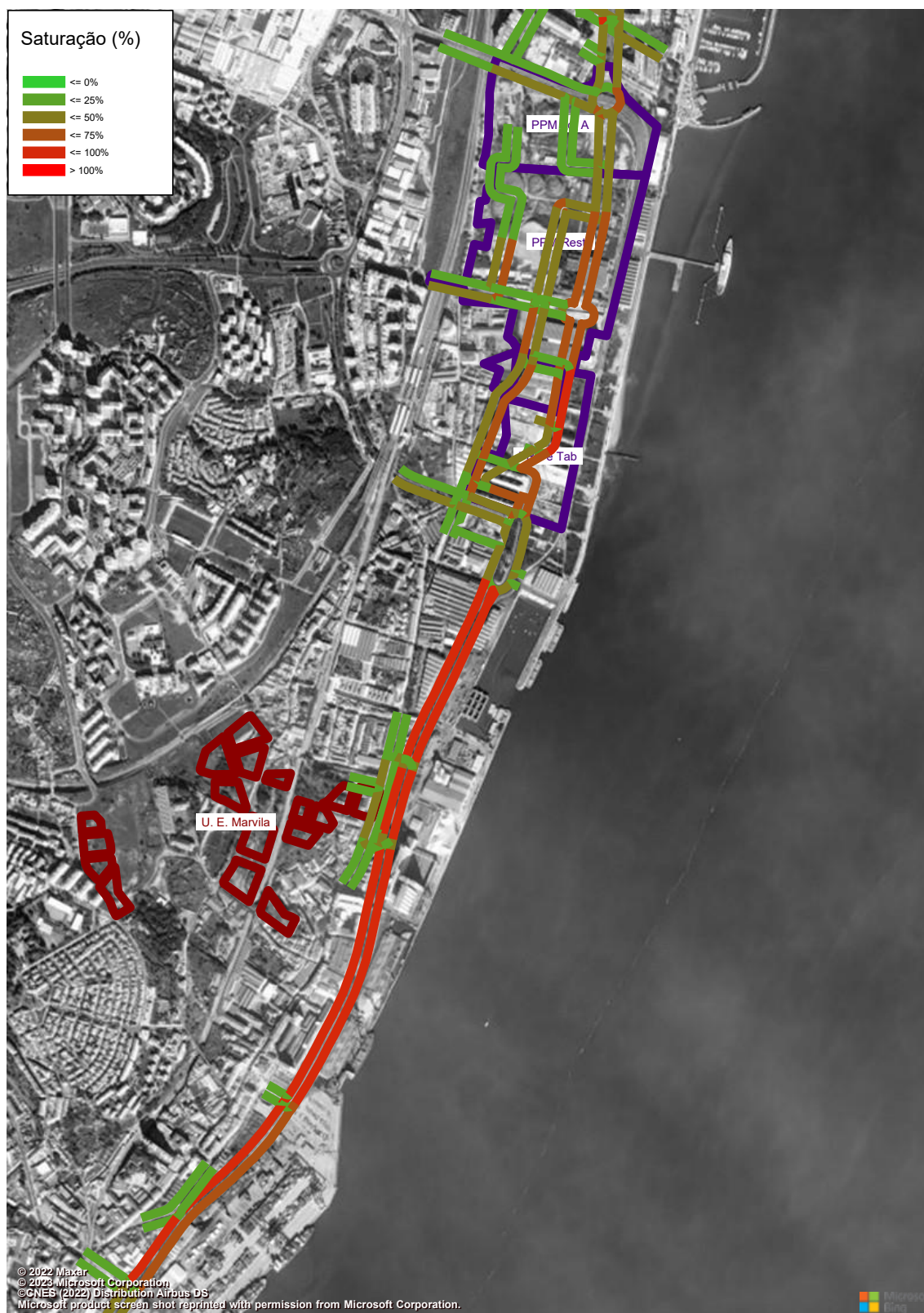
Figura 216 – Grau de Saturação (macro modelo de tráfego em PTV Visum, HPT-DU, Cenário RM1, Troço 5 a 6) (%).
