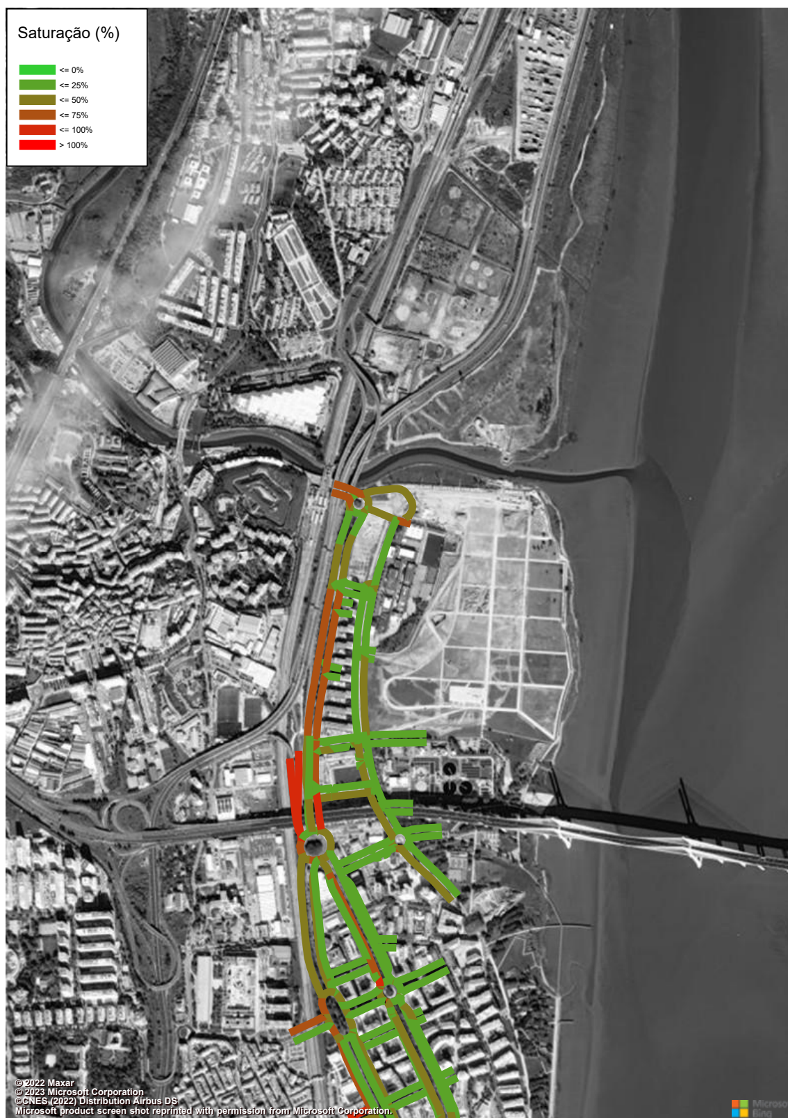
Figura 240 – Grau de Saturação (macro modelo de tráfego em PTV Visum, HPM-DU, Cenário RM2, Troço 11 a 12) (%).
