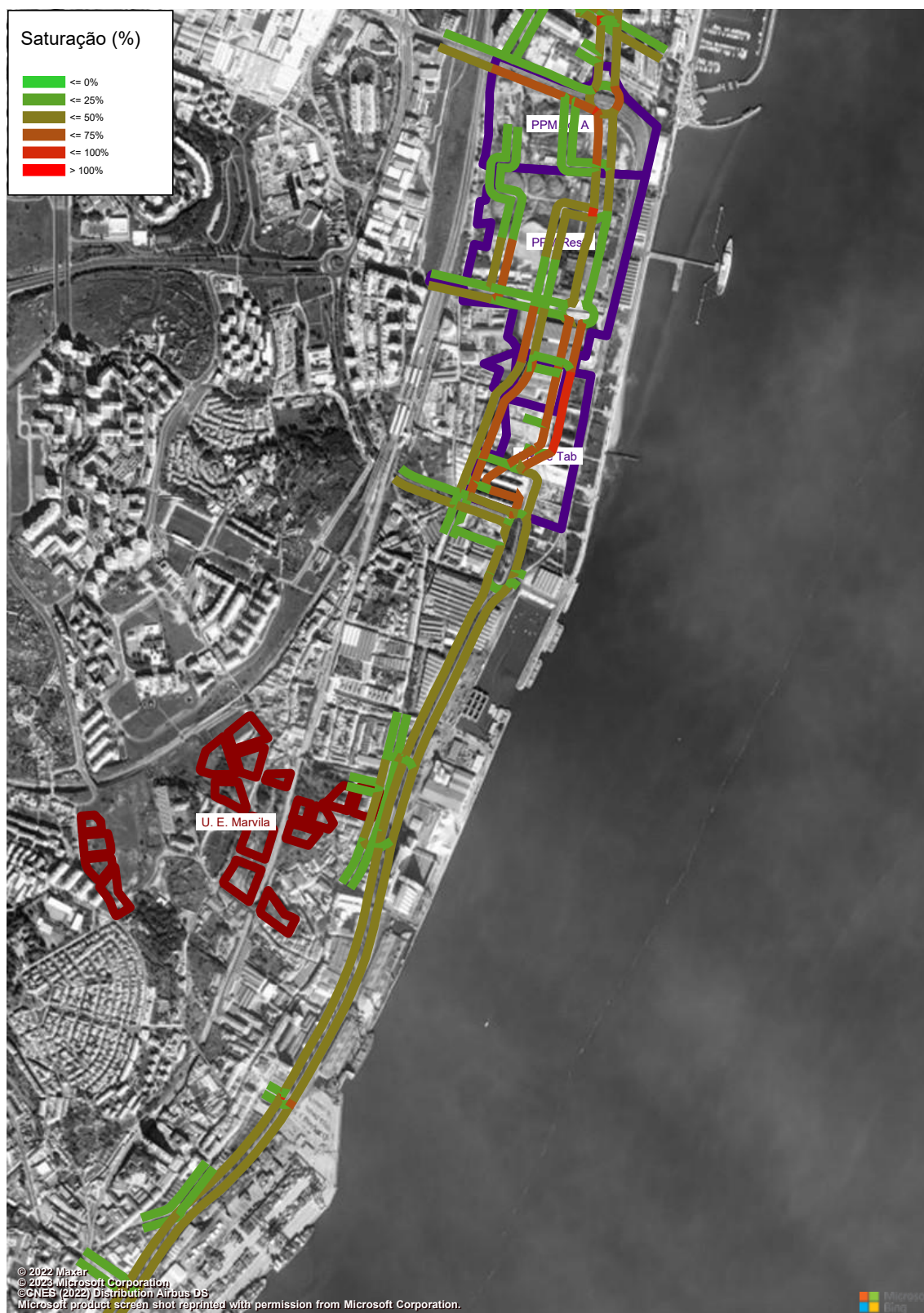
Figura 194 – Grau de Saturação (macro modelo de tráfego em PTV Visum, HPM-DU, Cenário FR, Troço 5 a 6) (%).
