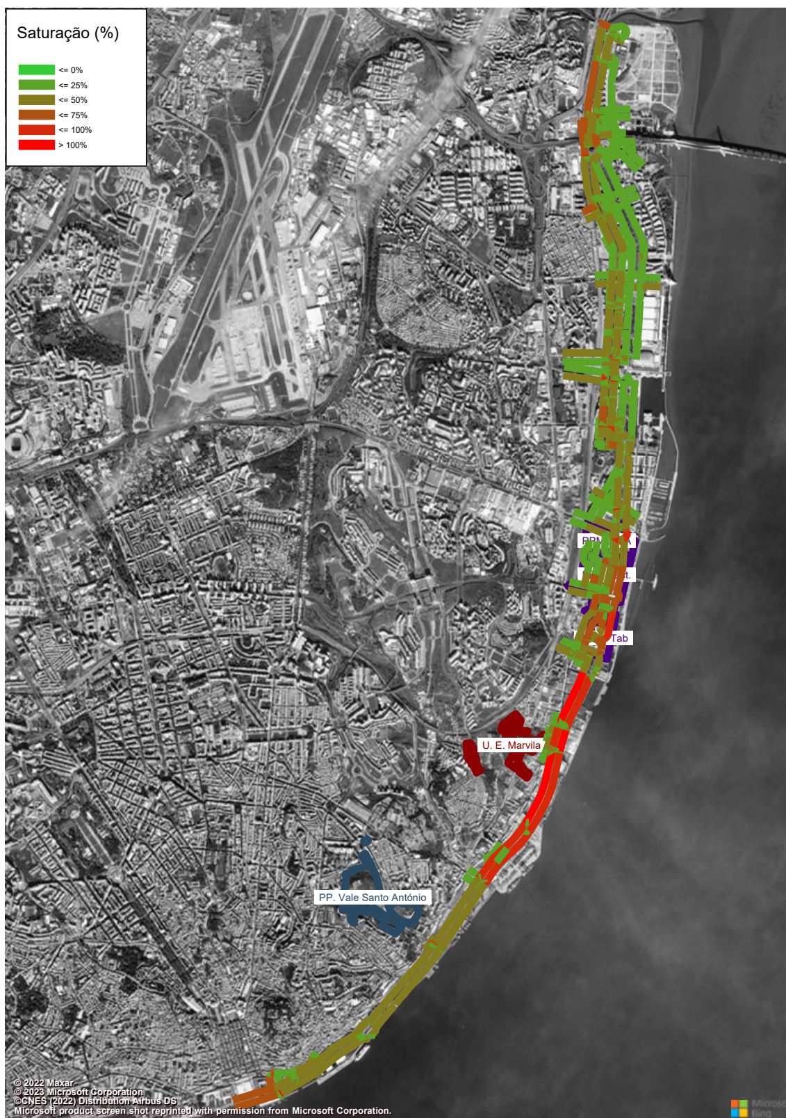
Figura 128 – Grau de Saturação (macro modelo de tráfego em PTV Visum, HPT-DU, Cenário F1) (%).
