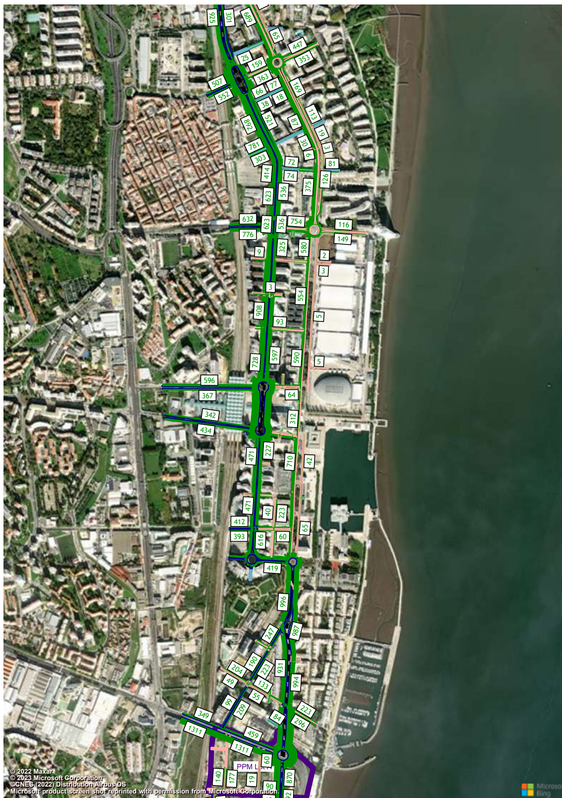
Figura 228 – Volumes de tráfego (macro modelo de tráfego em PTV Visum, HPM-DU, Cenário RM2, Troço 7 a 10) (uvle/hora).
