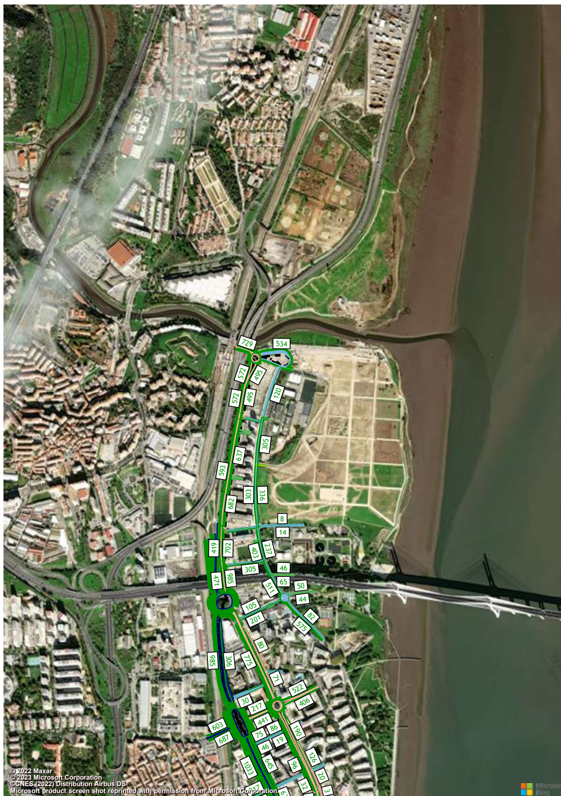
Figura 146 – Volumes de tráfego (macro modelo de tráfego em PTV Visum, HPM-DU, Cenário F2, Troço 11 a 12) (uvle/hora).
