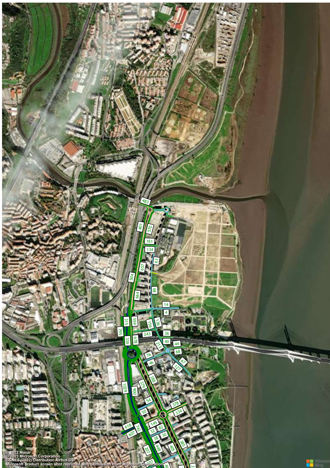
Figura 273 – Volumes de tráfego (macro modelo de tráfego em PTV Visum, HPT-DU, Cenário RMR, Troço 11 a 12) (uvle/hora).
