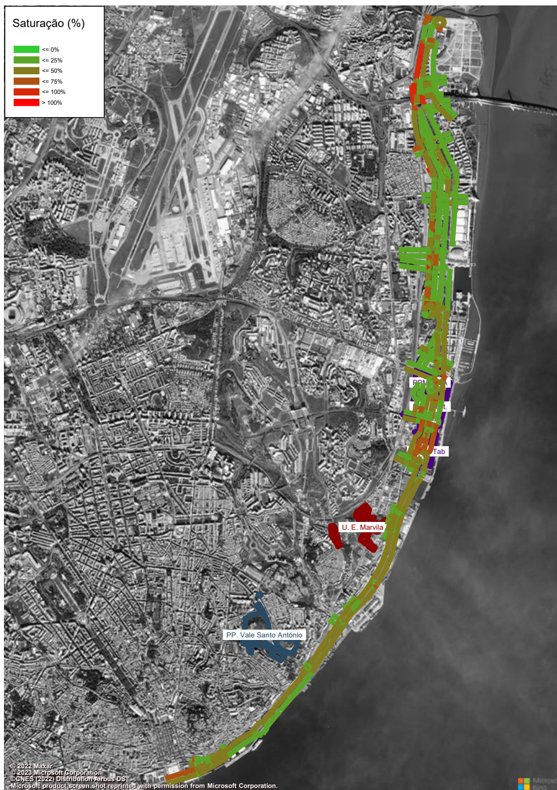
Figura 274 – Grau de Saturação (macro modelo de tráfego em PTV Visum, HPM-DU, Cenário RMR) (%).
