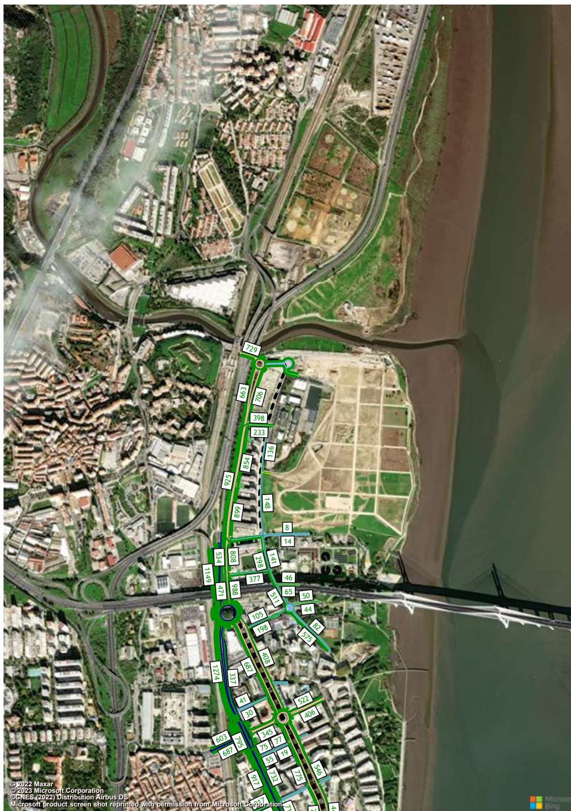
Figura 125 – Volumes de tráfego (macro modelo de tráfego em PTV Visum, HPM-DU, Cenário F1, Troço 11 a 12) (uvle/hora).
